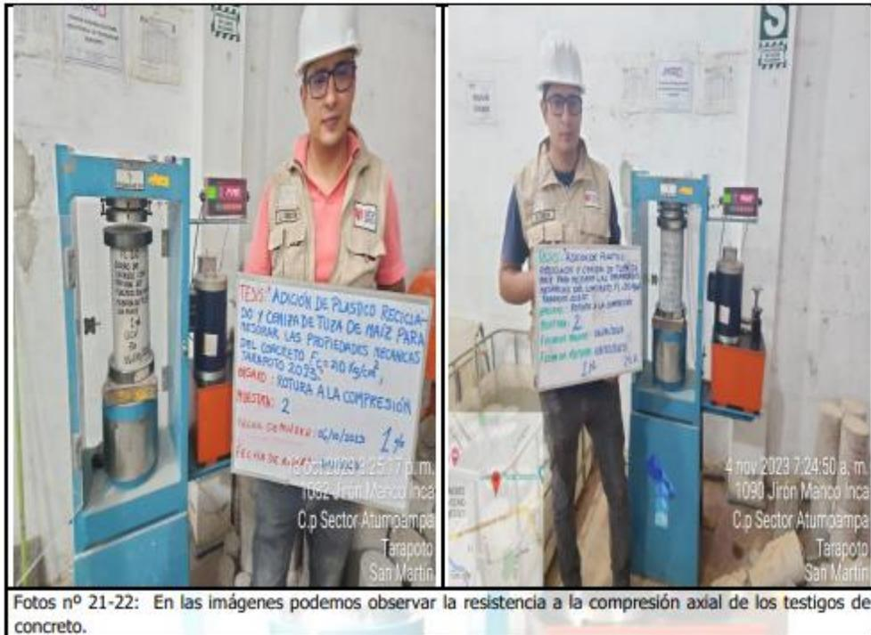
Fotos nº 21-22: En las imágenes podemos observar la resistencia a la compresión axial de los testigos de concreto.
