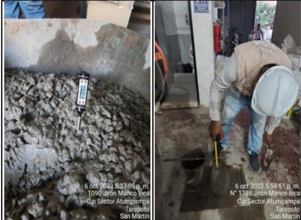
Fotos n° 17-18: En las imágenes podemos observar al personal realizando la prueba de asentamiento para los diseños de Mezclas.
