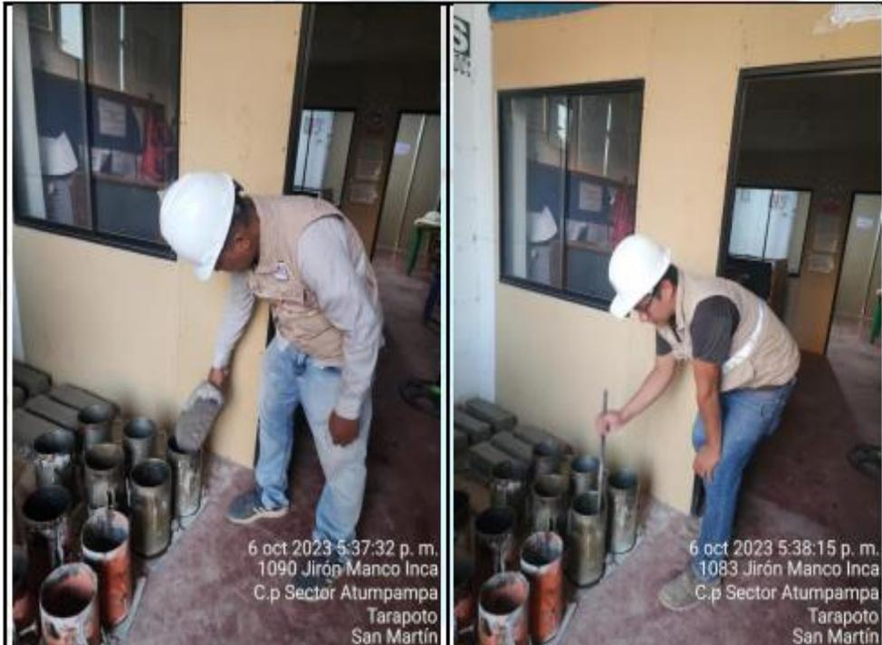
Fotos n° 19-20: En las imágenes podemos observar el moldeo de los testigos de concreto.
