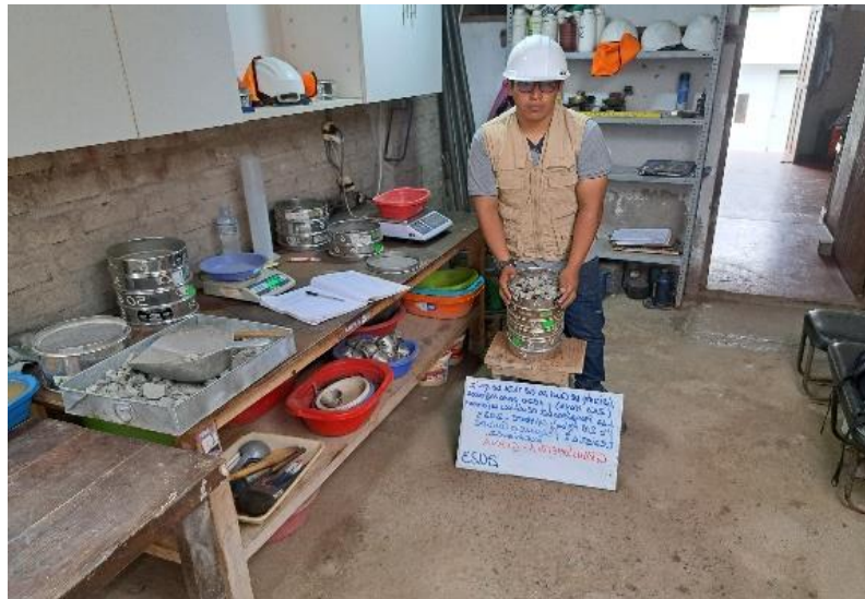
FIGURA 2: ensayo de granulometría de los agregados
