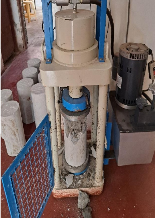
Fotografía 22: rotura a compresión
