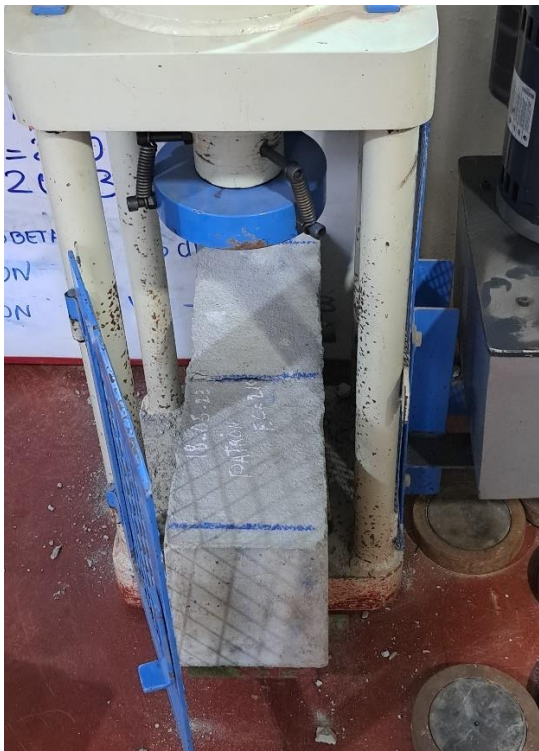
Fotografía 23: rotura a flexión
