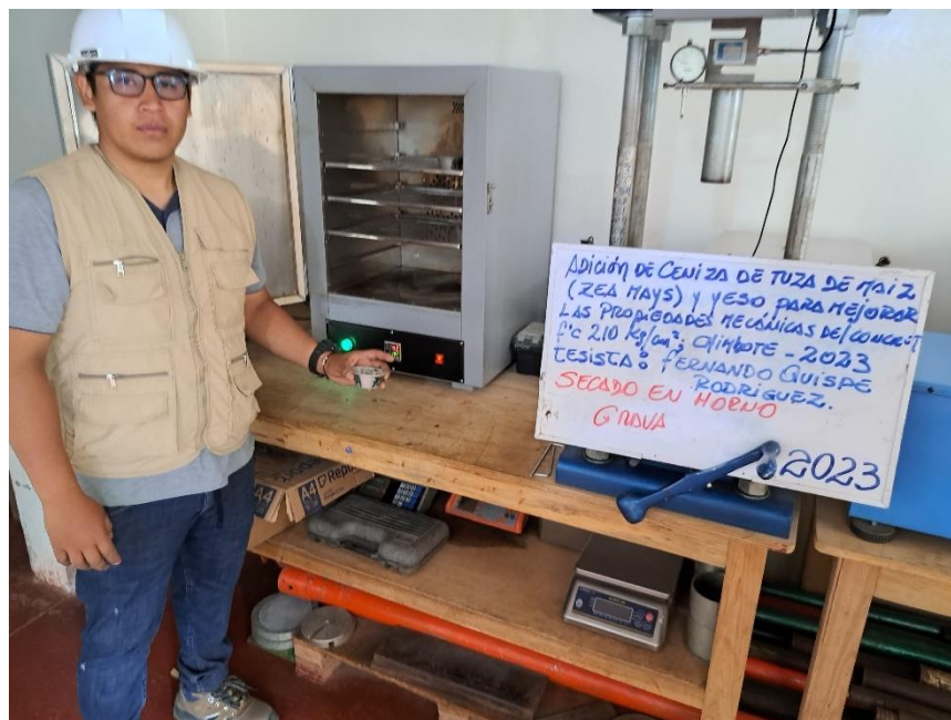
Fotografía 8: secado en horno de la piedra chancada
