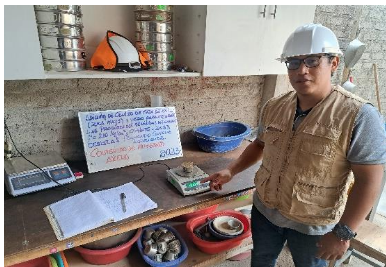
FIGURA 3: ensayo de contenido de humedad de los agregados
