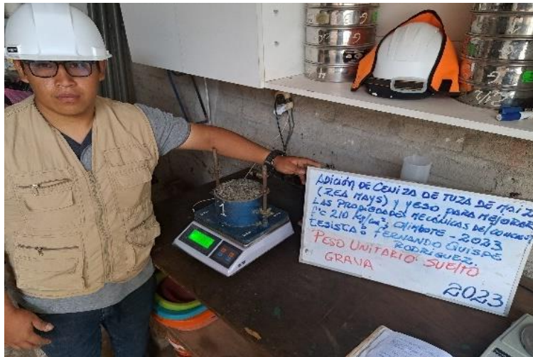
FIGURA 4: ensayo de peso unitario suelto del agregado
