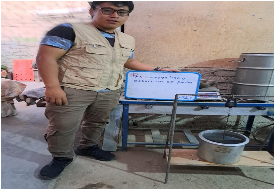
Fotografía 14: peso específico y absorción de la arena y piedra
