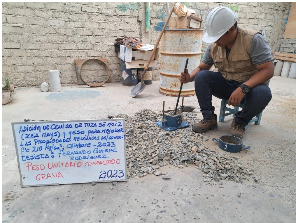
Fotografía 12: peso unitario compactado de la piedra
