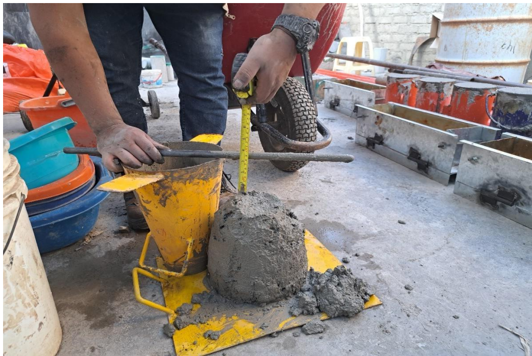
Fotografía 16: ensayo de cono de Abrams
