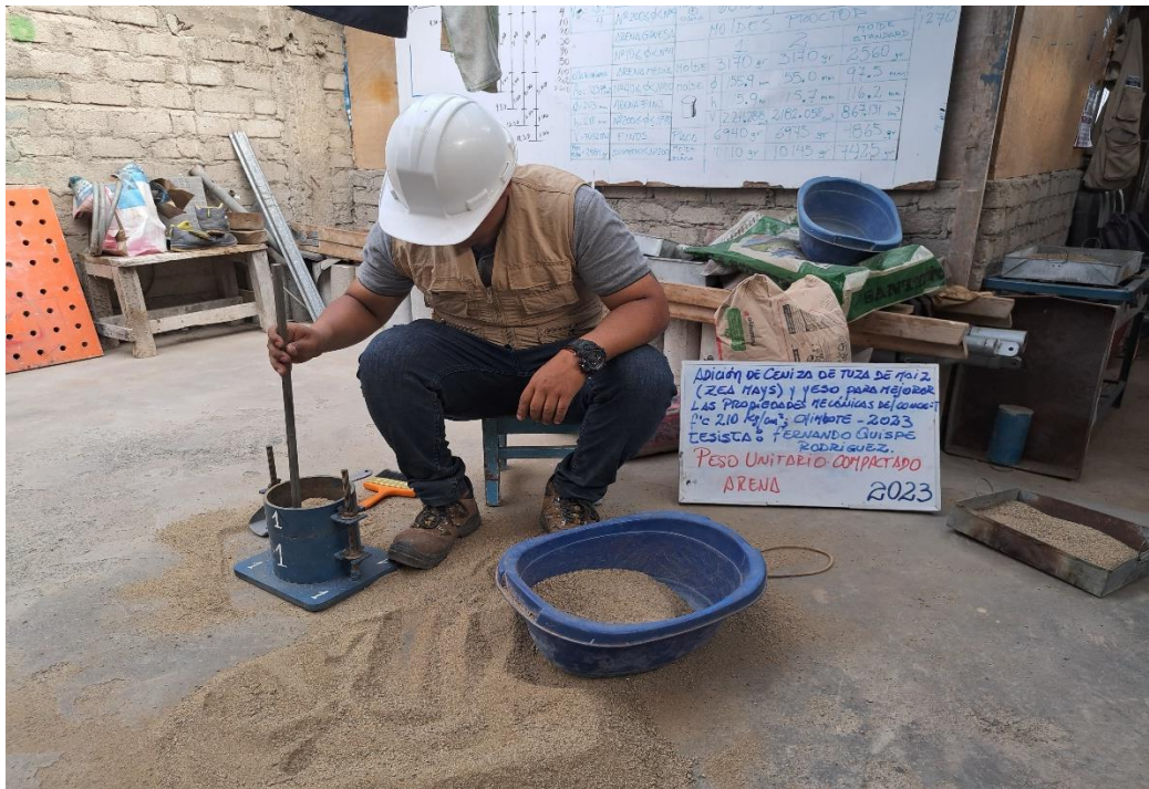
Fotografía 10: peso unitario compactado de la arena
