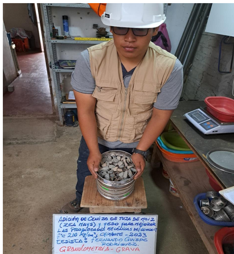
Fotografía 13: ensayo granulométrico de la arena y piedra
