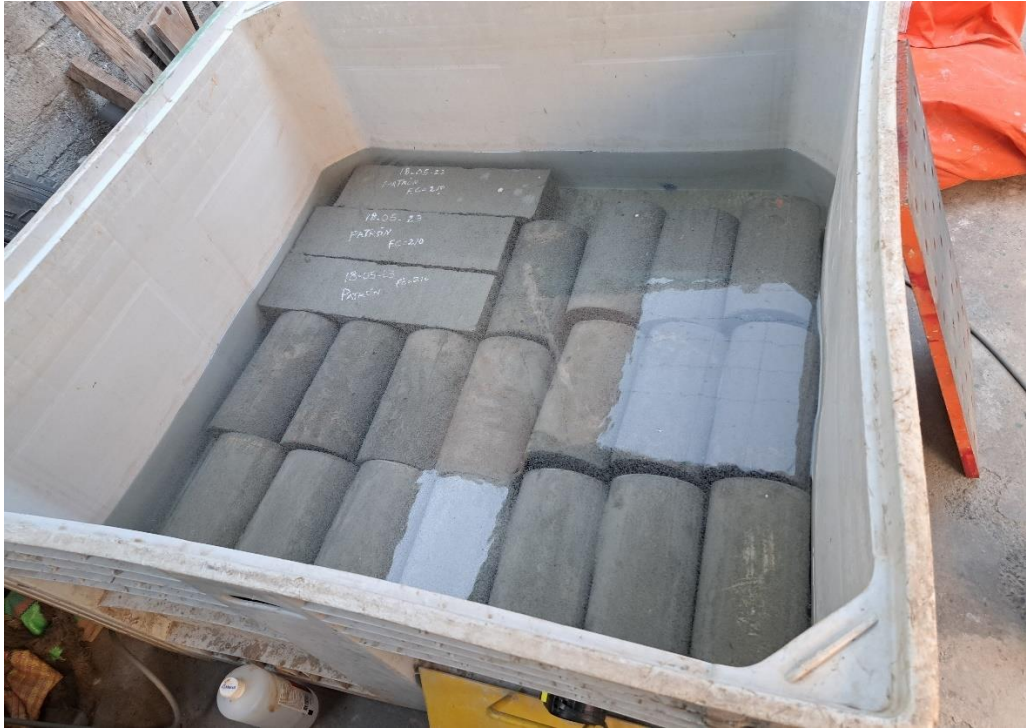
Fotografía 20: curado de probetas
