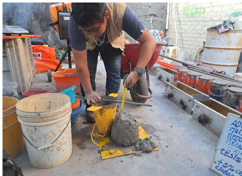
FIGURA 5: prueba del cono de Abrams
