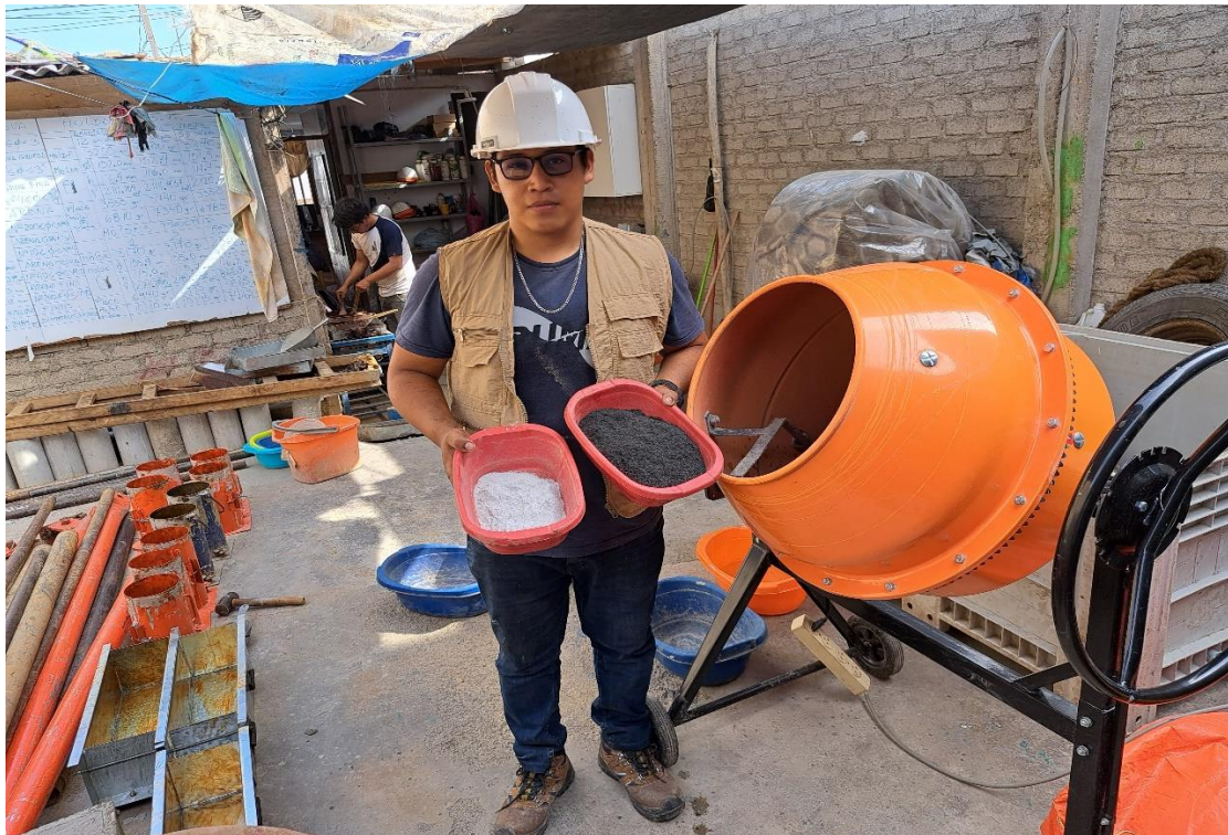
Fotografía 18: adición de ceniza de tusa de maíz y yeso
