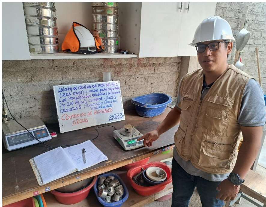
Fotografía 6: contenido de humedad del agregado fino
