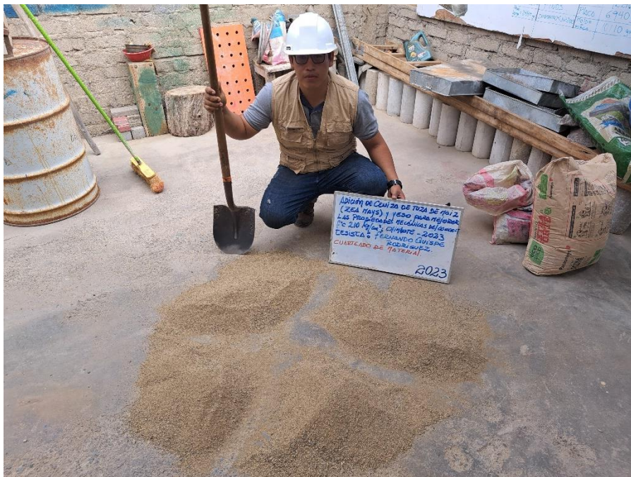
Fotografía 4: cuarteo de agregado fino
