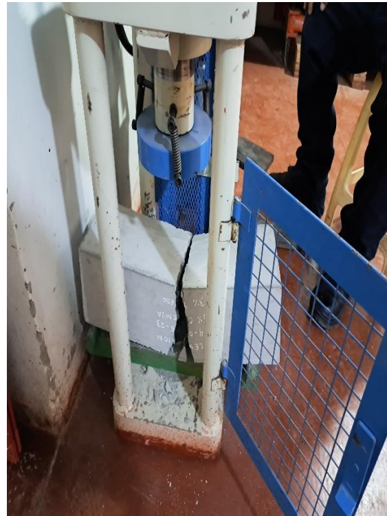
Fotografía 23: rotura a flexión
