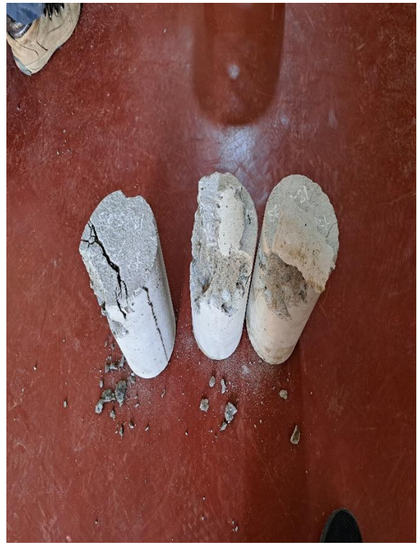
Fotografía 22: rotura a compresión
