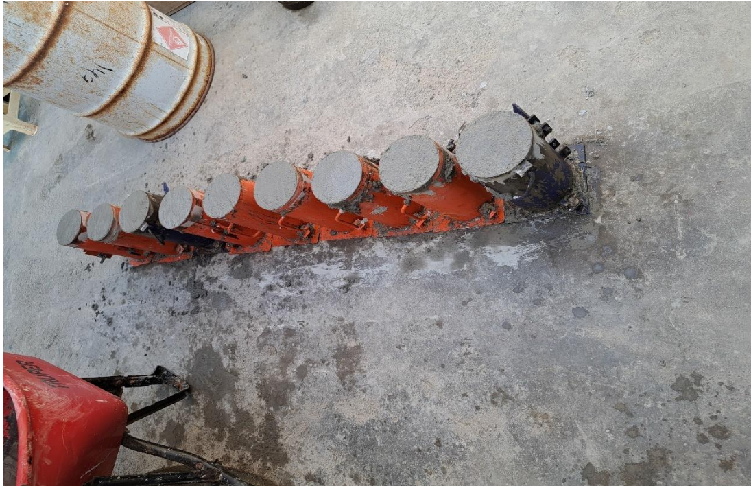
Fotografía 19: fabricación de las probetas experimentales
