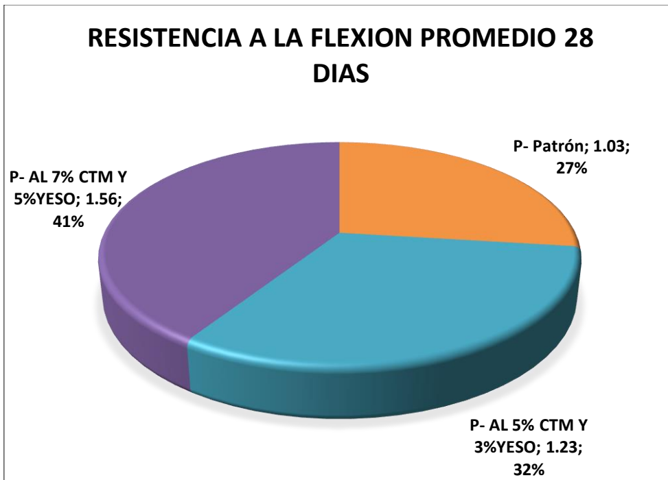
FIGURA 24: resultados en % de la resistencia a la flexión
