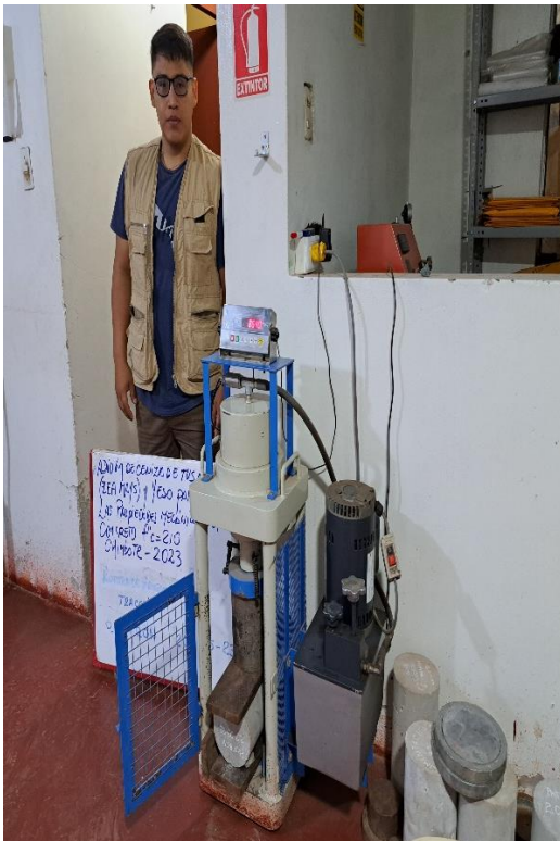
Fotografía 21: rotura a tracción
