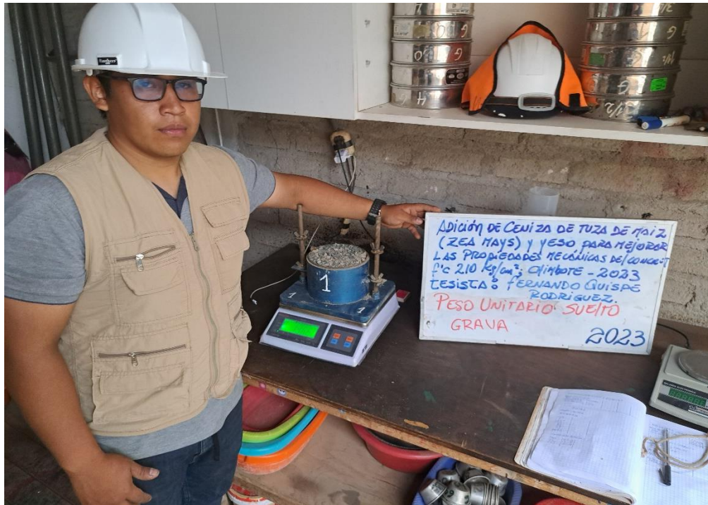
Fotografía 11: peso unitario suelto de la piedra
