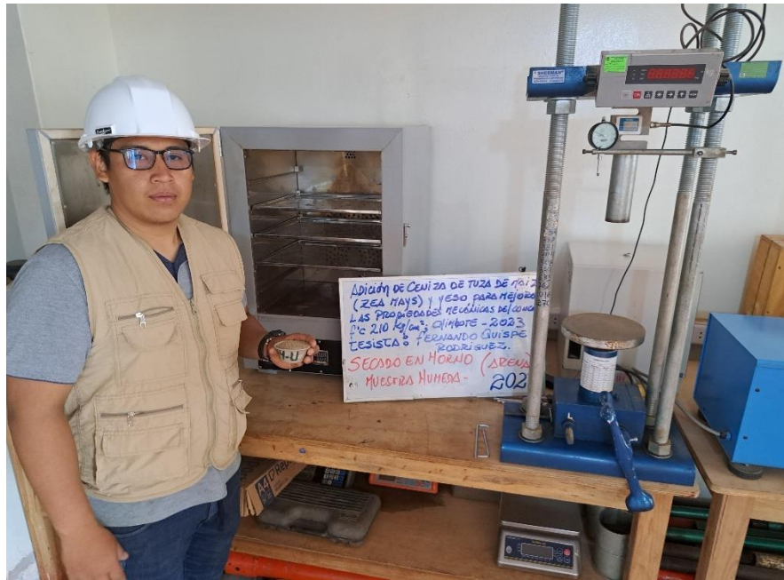
Fotografía 7: secado en horno de la arena gruesa
