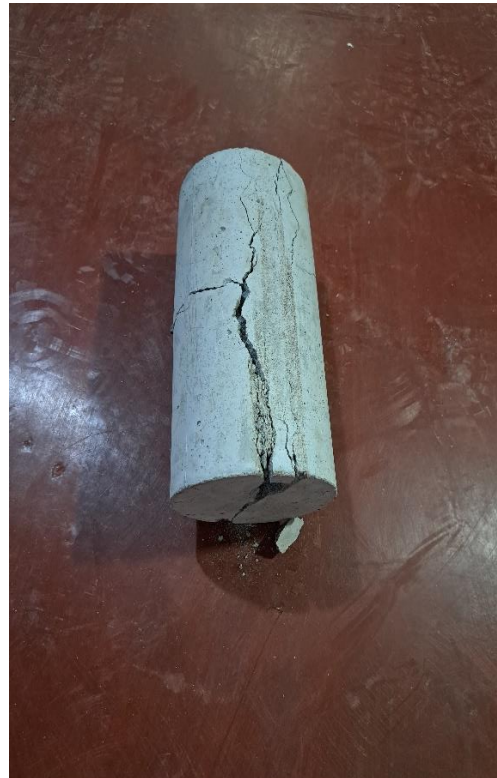
Fotografía 21: rotura a tracción
