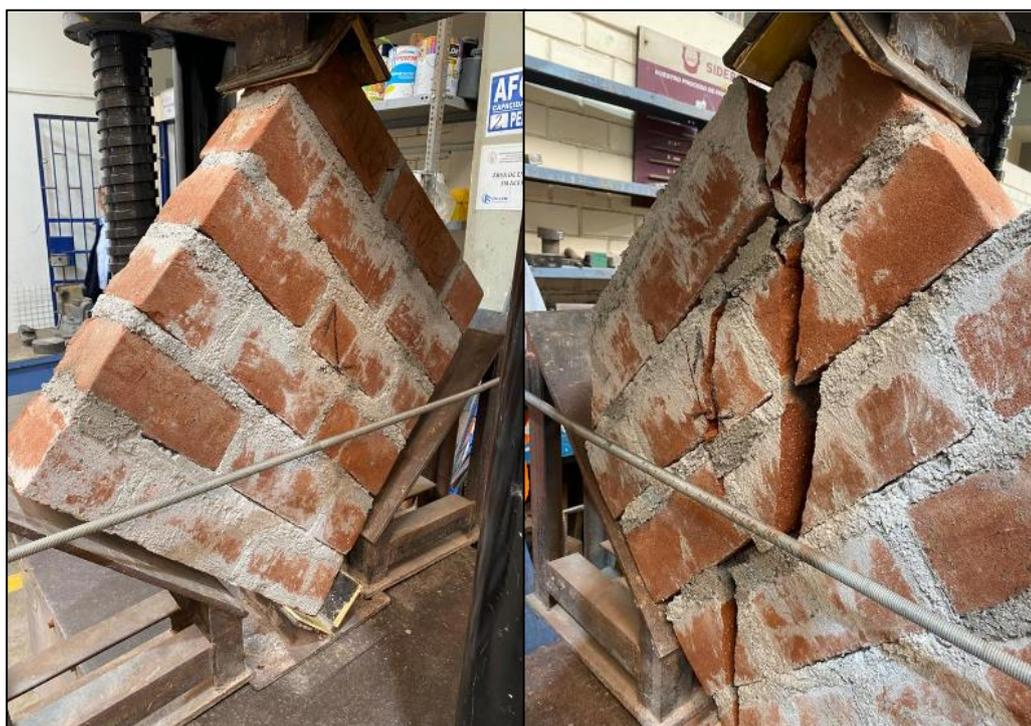
15. Presencia de fisuras en los muros producto de la acción sísmica
