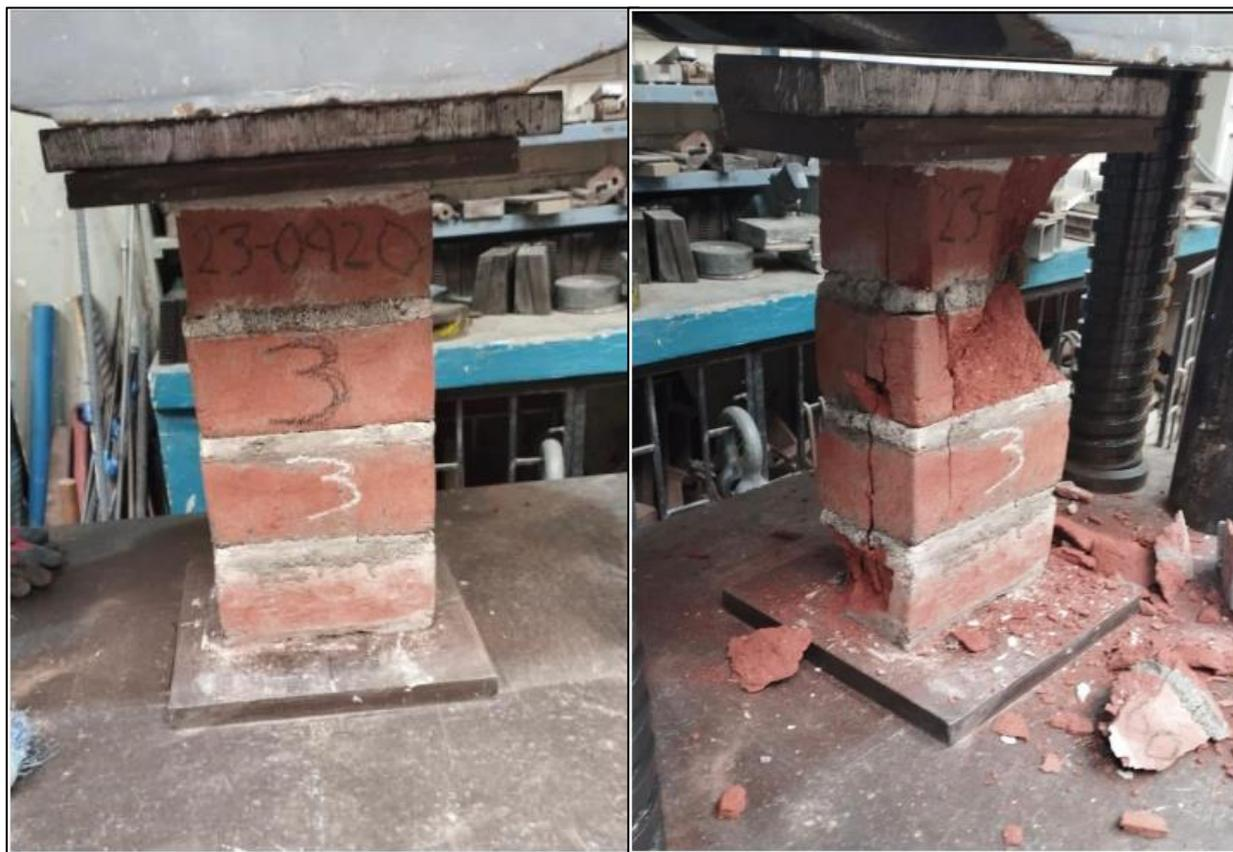
14. Ensayo de resistencia a la compresión diagonal del murete de albañilería v'm
