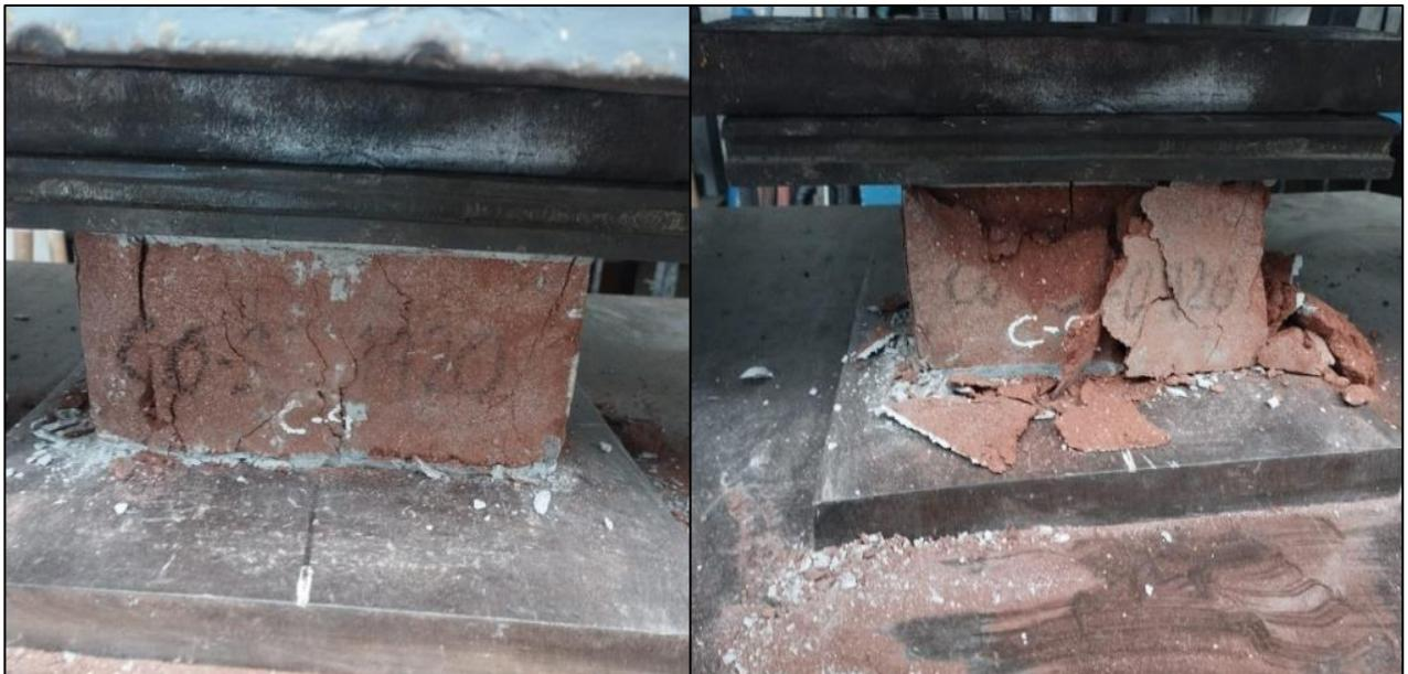
13. Ensayo de resistencia a la compresión axial de las pilas de albañilería f'm
