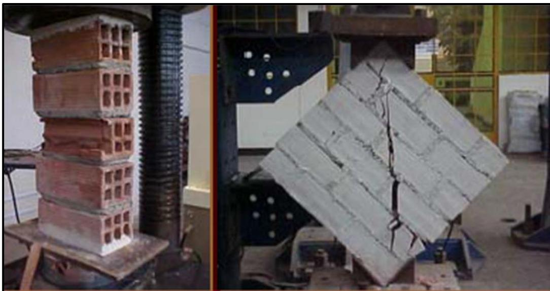
Figura 6. Albañilería en forma de prismas
