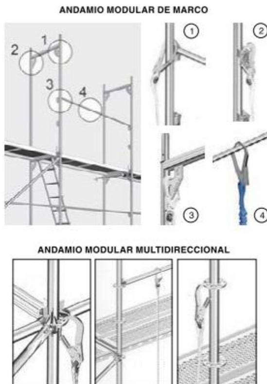
Figura N°3: Punto de sujeción PEI. contra caída de altura
