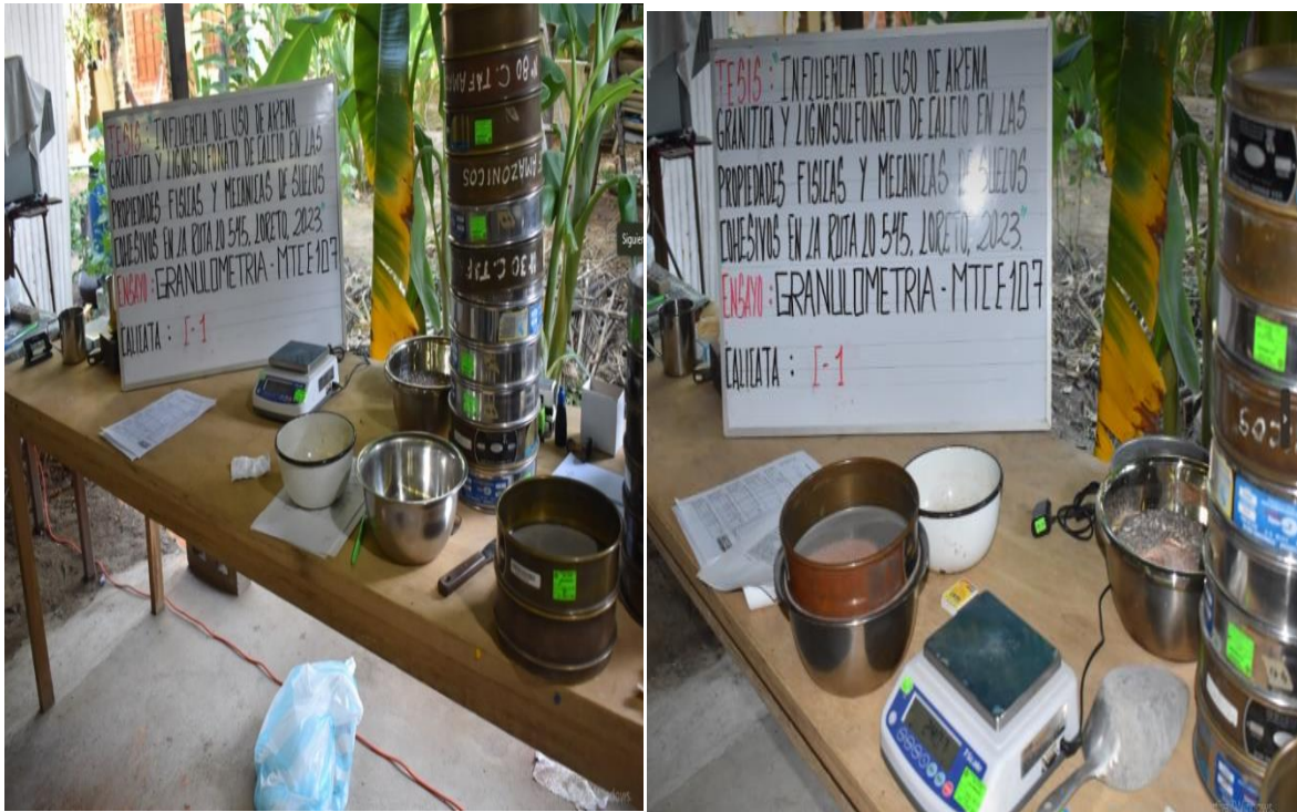
Figura 23. Granulometría, proceso de tamizado y registro de datos para la determinación de tipo de suelo.
