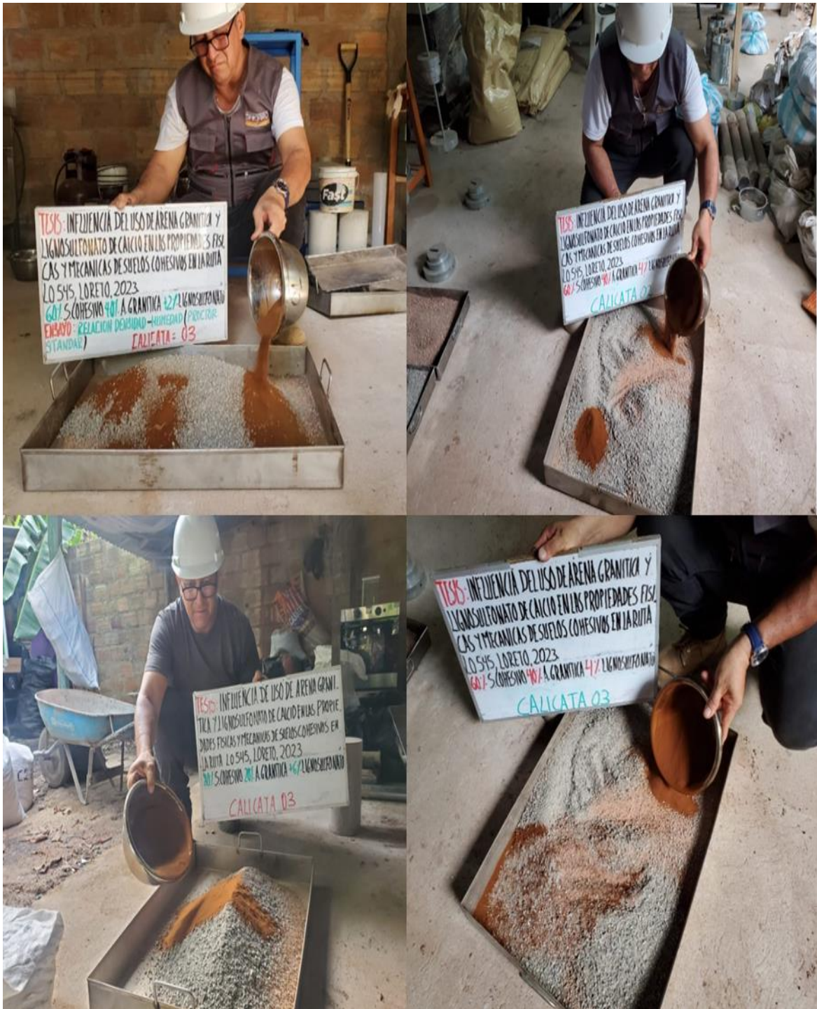
Figura 28. Combinación de 80% Suelo Cohesivo + 20% Arena Granítica (GS) + 2% Lignosulfonato de Calcio (CLS) para calicata C-1, C-2 y C-3.
