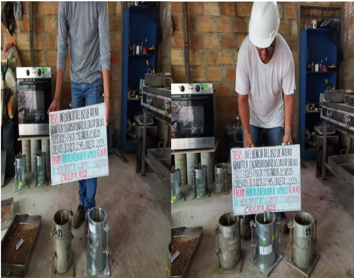
Figura 41. Ensamblaje del collarín con el disco espaciador calicata C-1 y C-2.
