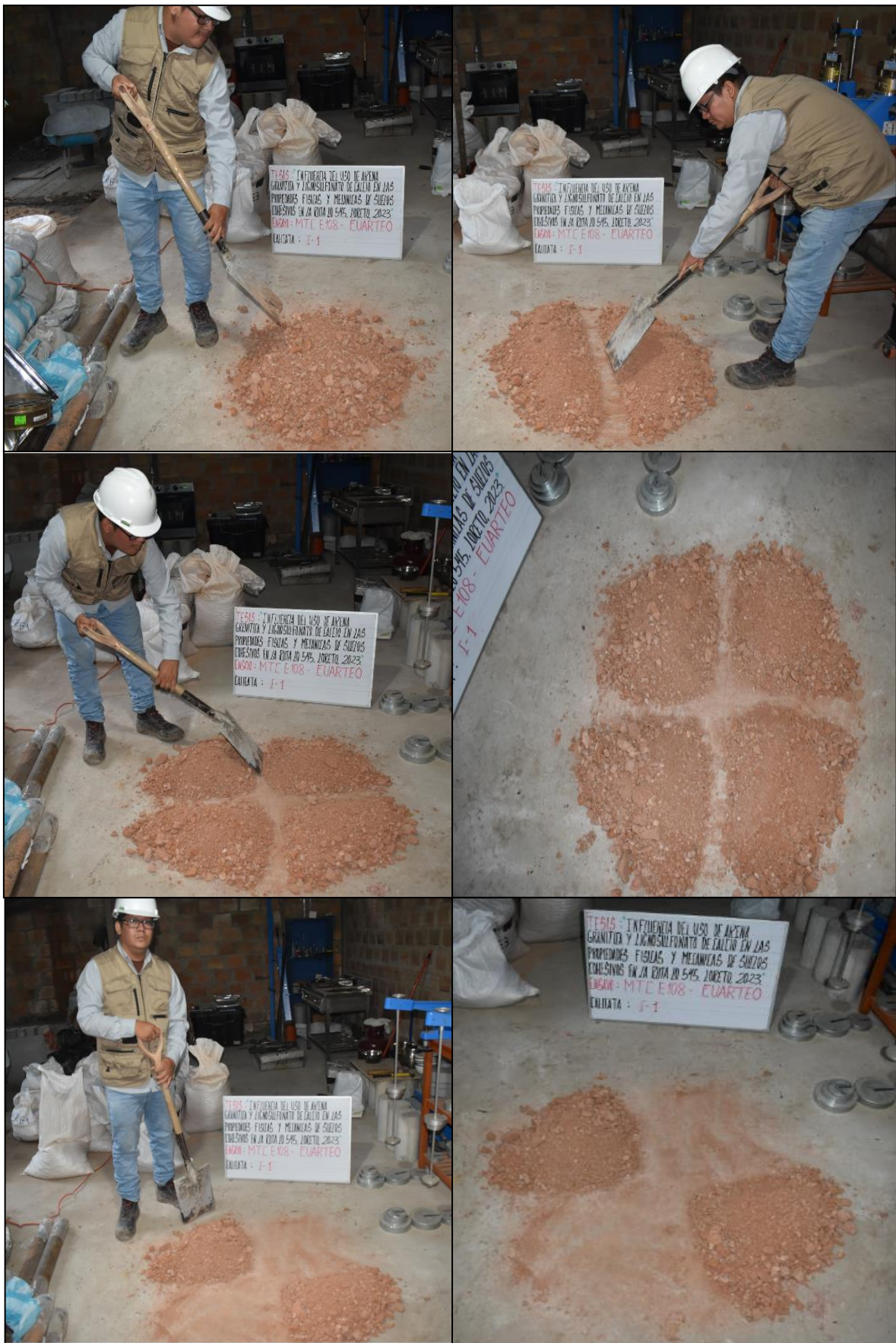
Figura 22. Aplicación Normativa MTC E 108, Método B: Cuarteo
