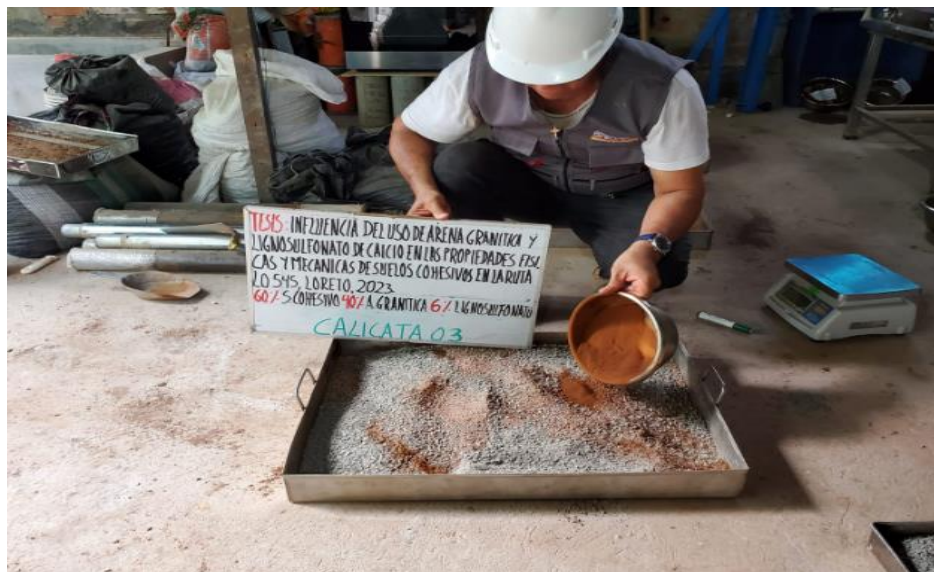
Figura 39. Combinación de 80% de Suelo Cohesivo + 20% de Arena Granítica (GS) + 4% Lignosulfonato de Calcio (CLS), calicata C-2.
