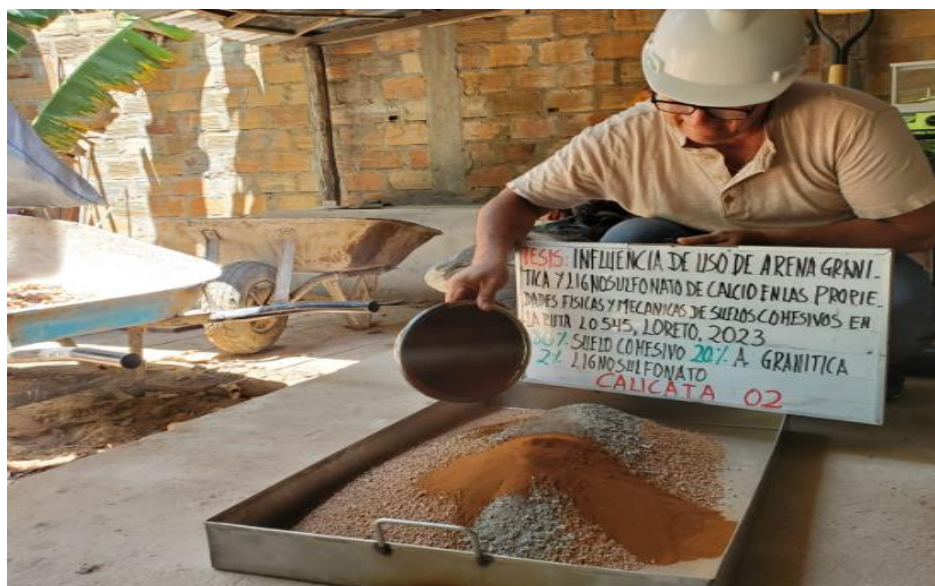
Figura 40. Combinación de 80% de Suelo Cohesivo + 20% de Arena Granítica (GS) + 6% Lignosulfonato de Calcio (CLS), calicata C-2.
