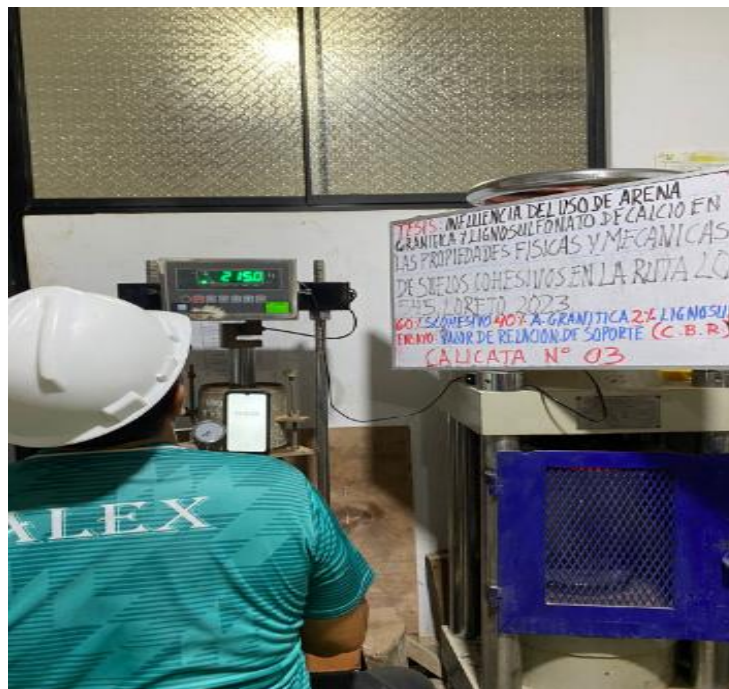
Figura 43. Procedimiento de penetración calicata C-3
