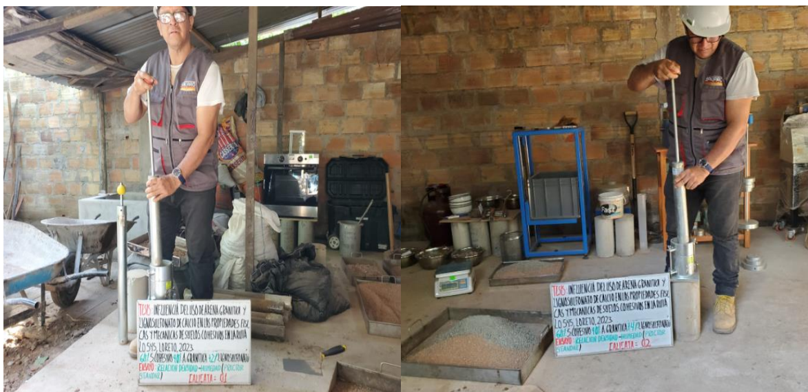
Figura 30. Compactación del espécimen en 5 capas aproximadamente con 25 golpes en calicata C-1, C-2 y C-3.
