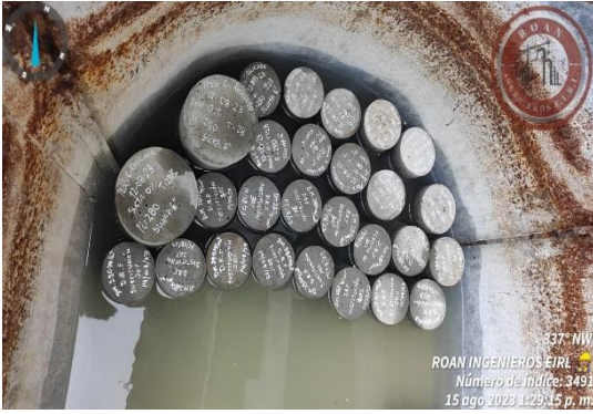
Imagen4: Elaboración y curado de probetas y vigas
