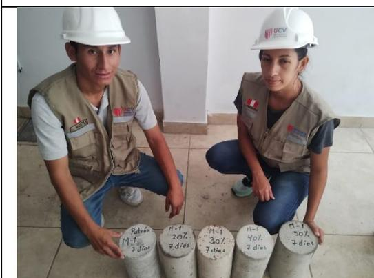
Probetas cilíndricas a 7 días
