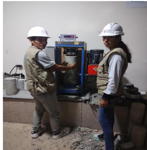
Investigadores en rotura de probetas
