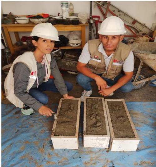
Vaciado de probetas en forma de vigas
