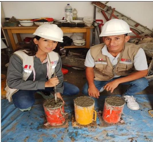
Vaciado de probetas cilíndricas
