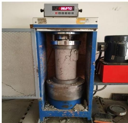
Rotura de probetas 15 cm x 30 cm
