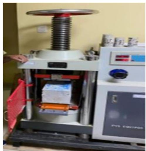
Rotura de probetas prismáticas en forma de viga de 15 cm x 50 cm
