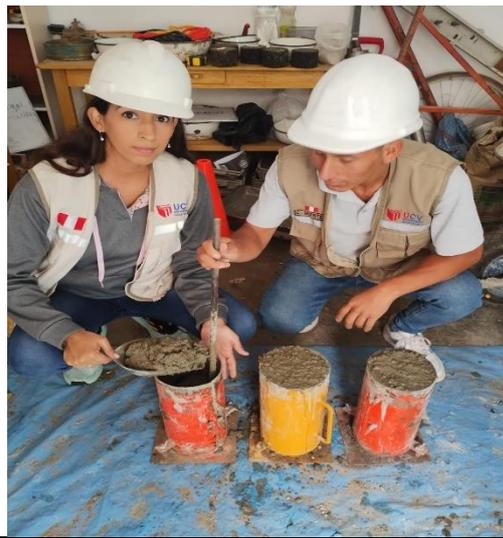
Vaciado de probetas cilíndricas
