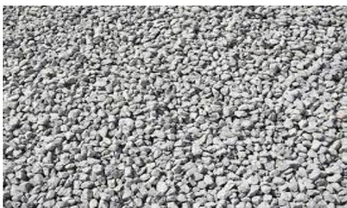
**Figura 2.** Agregado grueso de concreto reciclado
