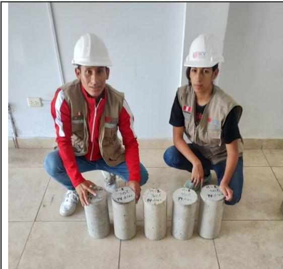
Probetas cilíndricas a 14 días
