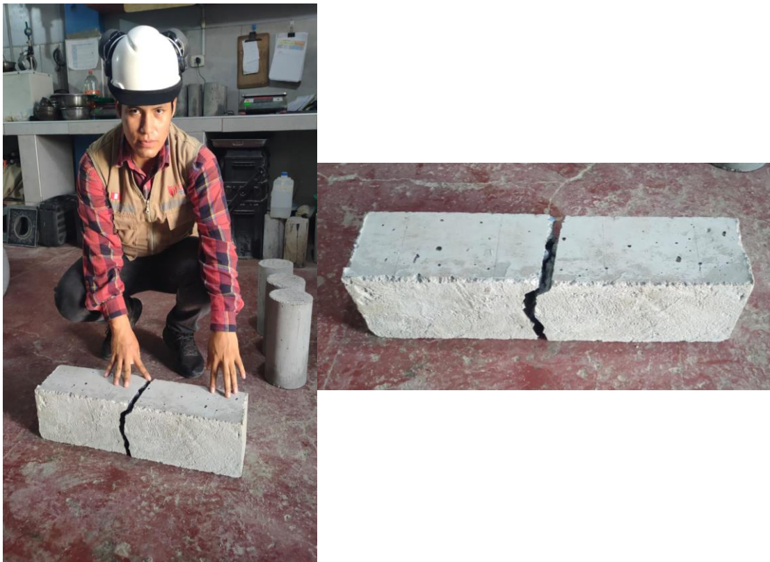
Imagen 22: Ensayo de rotura de vigas para determinar la resistencia a la flexión (7-14 y 28 días)
