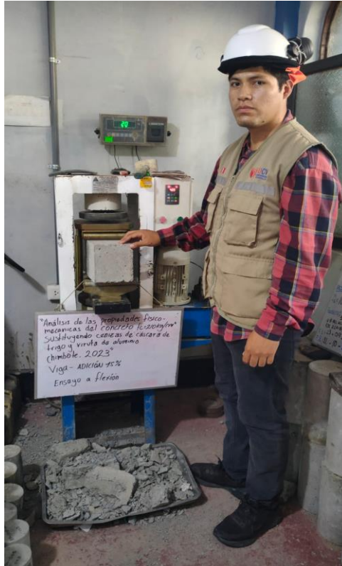
Imagen 21: Ensayo de rotura de vigas para determinar la resistencia a la flexión (7-14 y 28 días)
