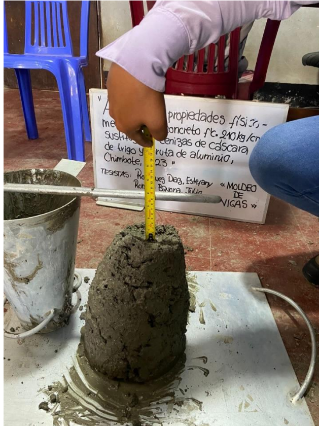
Imagen 19: Estudiante midiendo el revenimiento (Resultado = 3.5")
