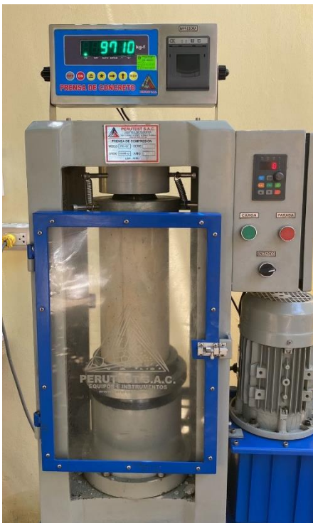
Imagen 24: Ensayo de rotura de probetas para determinar la resistencia a la compresión (7-14 y 28 días)
