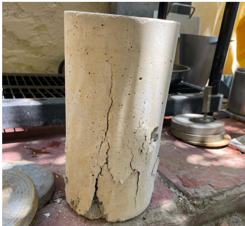
Imagen 24: Ensayo de rotura de probetas para determinar la resistencia a la compresión (7-14 y 28 días)
