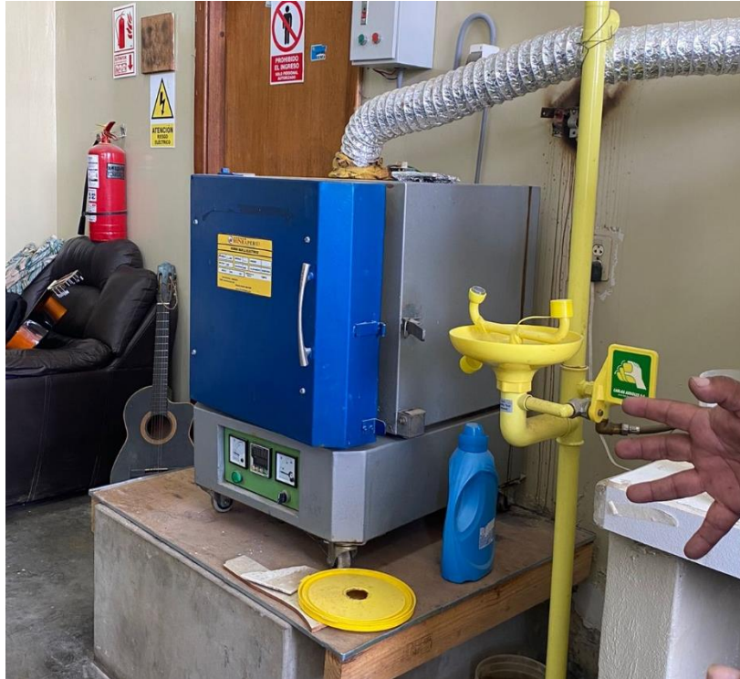
Imagen 3: Horno destinado a la producción de las cenizas
