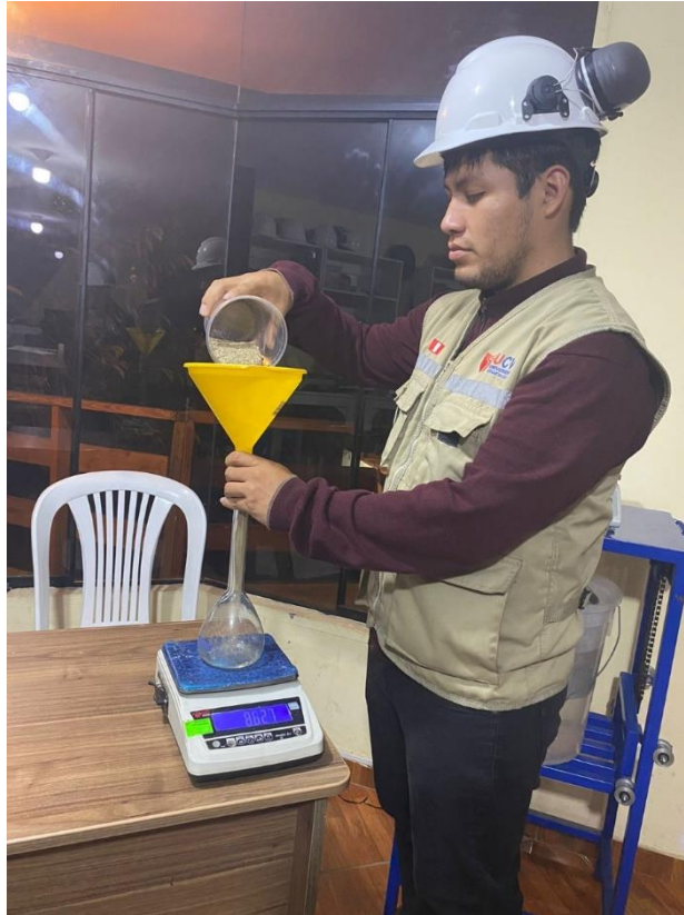
Imagen 11: Estudiante realizando el ensayo para hallar el peso unitario.
