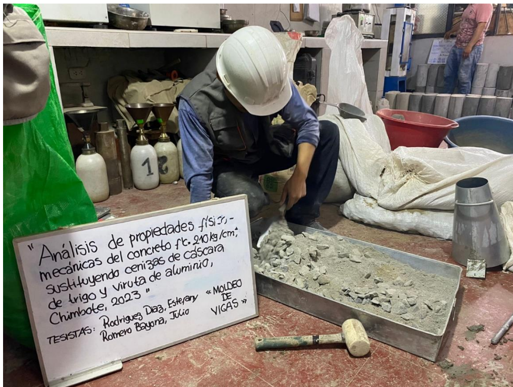
Imagen 16: Estudiante realizando la mezcla para la elaboración del concreto
