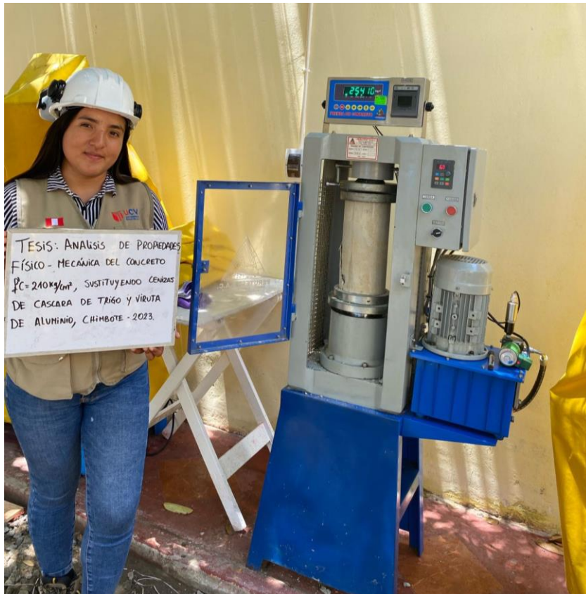
Imagen 23: Ensayo de rotura de probetas para determinar la resistencia a la compresión (7-14 y 28 días)
