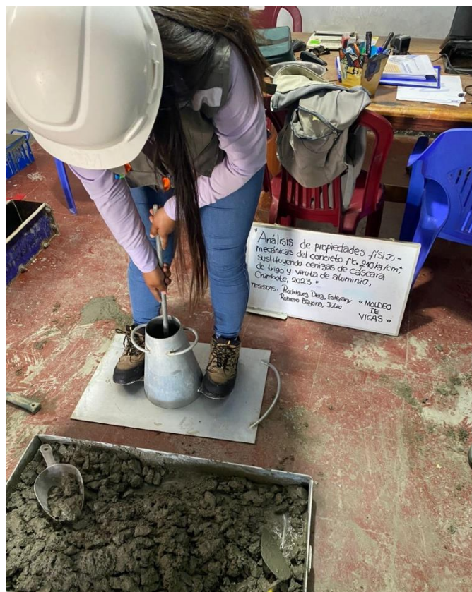
Imagen 18: Estudiante vertiendo el concreto al cono de Abrams para verificar el asentamiento
