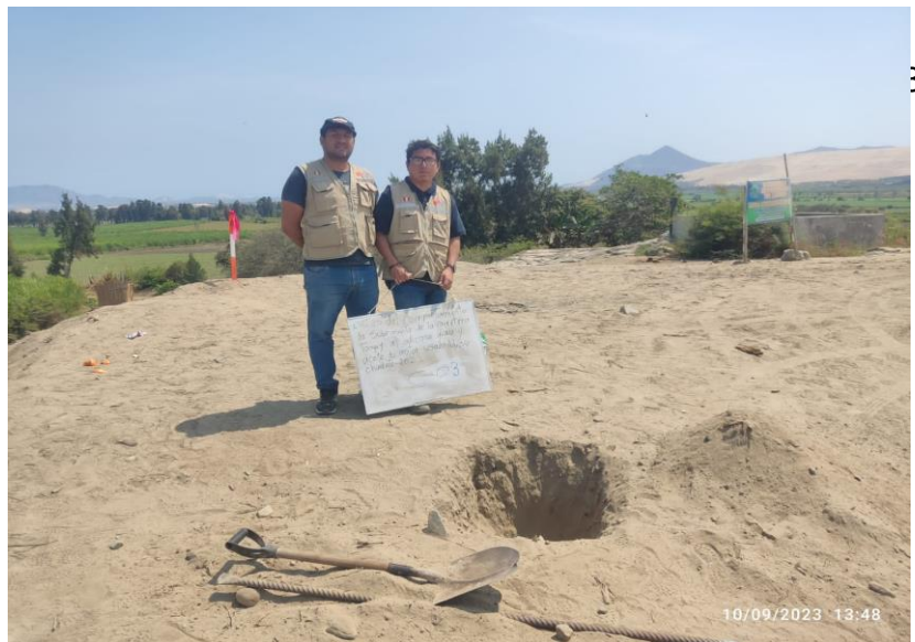
Foto N°15: Finalizando la extracción del material C-04
