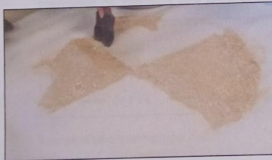
Figura 5: Cuarteo del material
