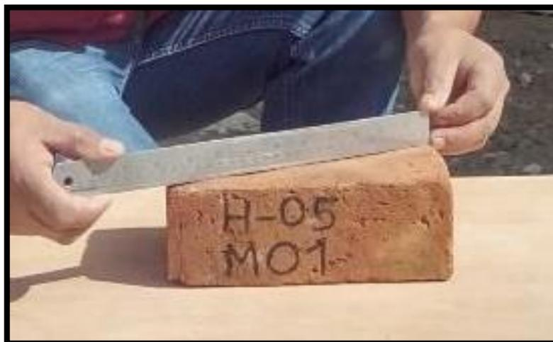
Figura 11: Ensayos de variaciones dimensionales
