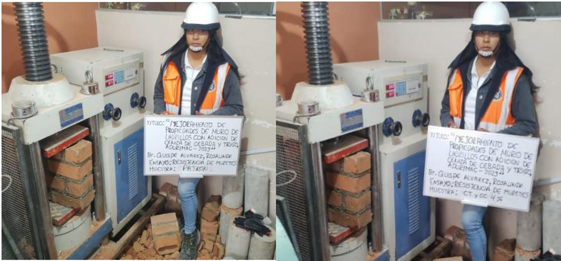
Figura 38: Ensayos resistencia a la compresión diagonal con murete
