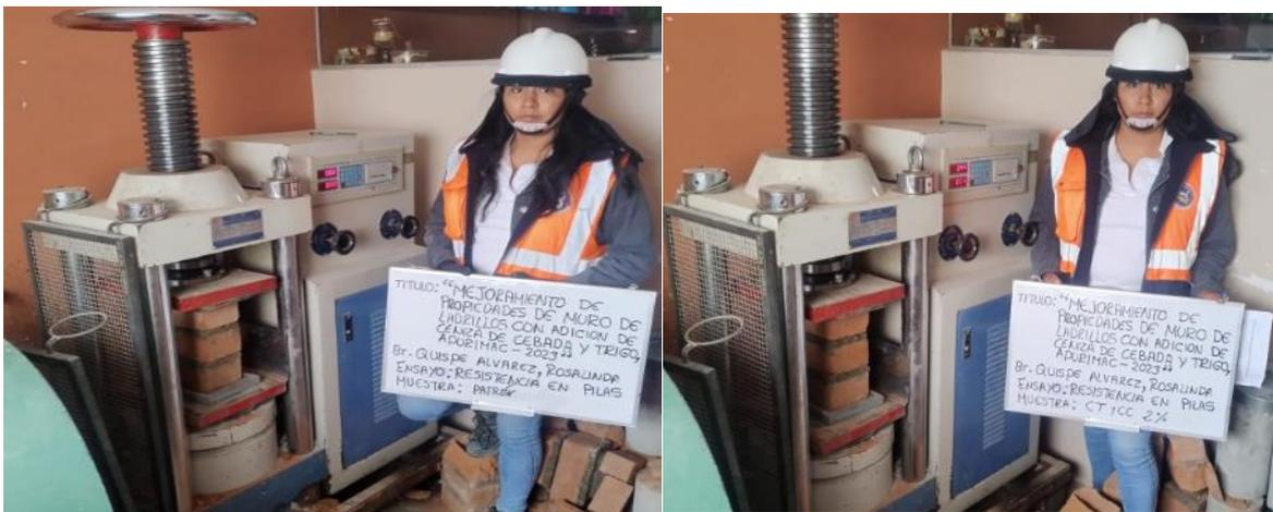
Figura 34: Ensayo resistencia a la compresión axial en pila
