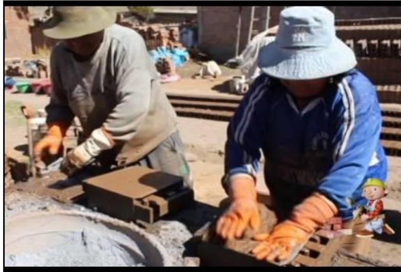
*Figura 6: Fabricación ladrillo artesanal*
