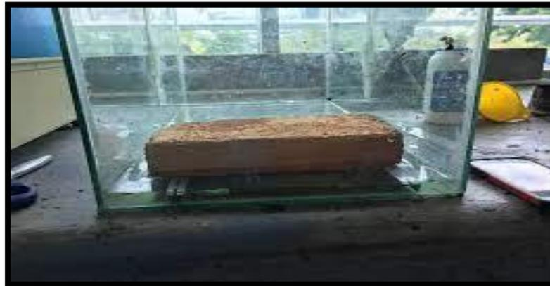
Figura 12: Ladrillo con 24hrs de sumergido
