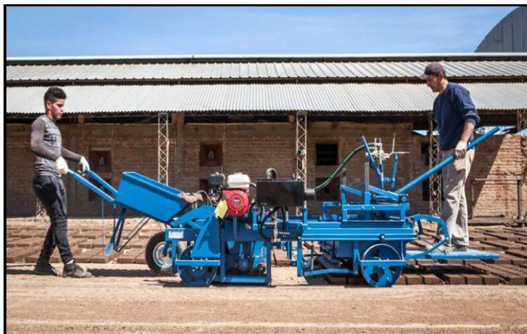
*Figura 7: Fabricación ladrillo semiindustrial*
