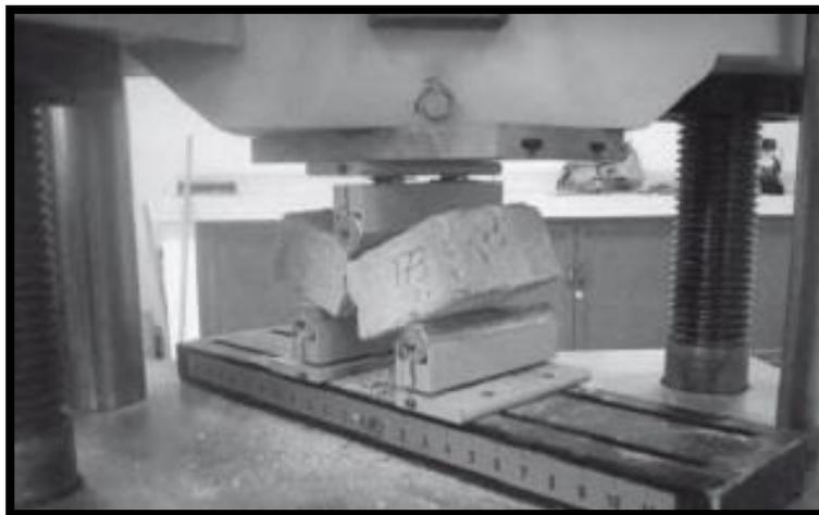
Figura 14: Rotura de ladrillo
