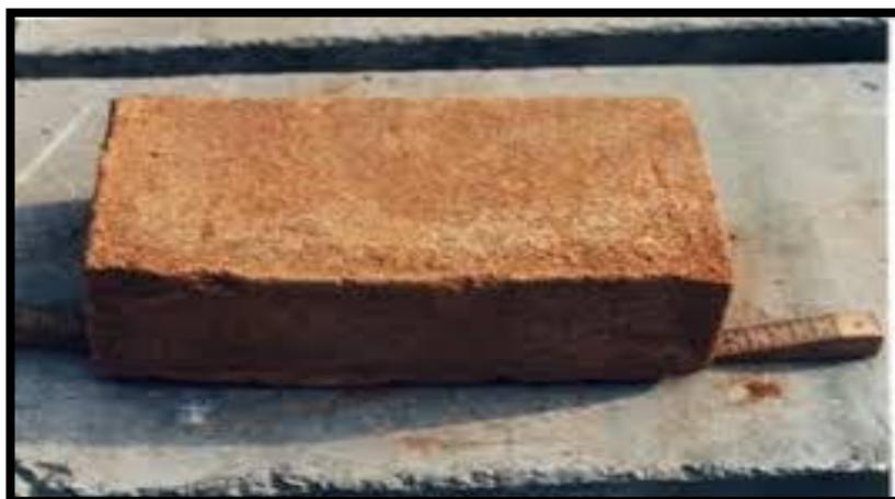
*Figura 9: Ensayo de alabeo*
