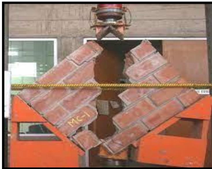
*Figura 16:* Ensayo de corte diagonal
