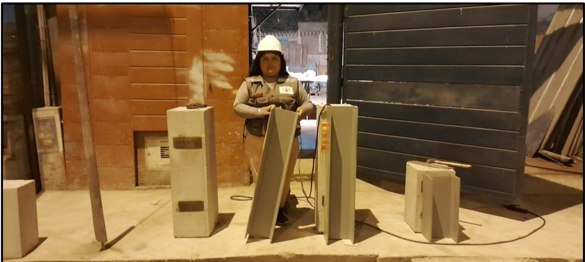
Figura n.44 Muestras representativas de la vivienda n°1 – reforzado con perfil H
