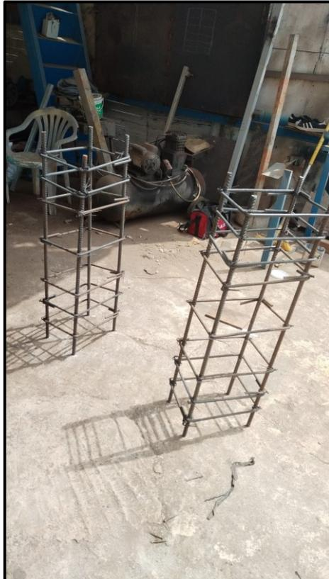
Figura n.37 Varillas de acero y estribos de la muestra.
