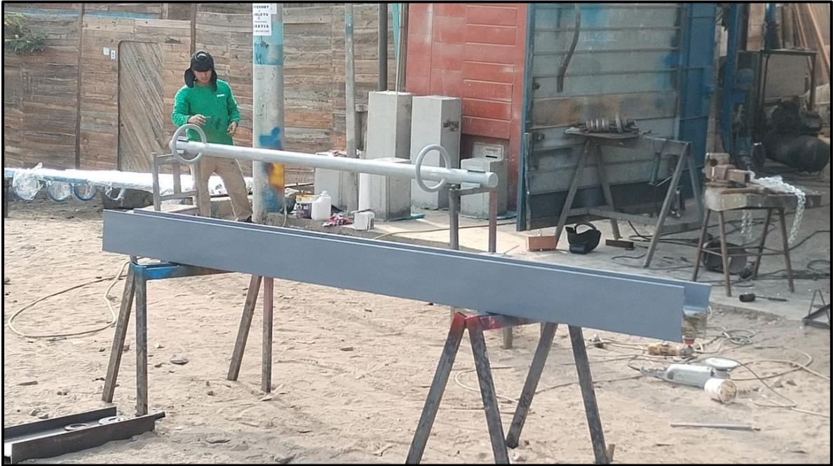
Figura n.39 Perfiles H – W8X31
