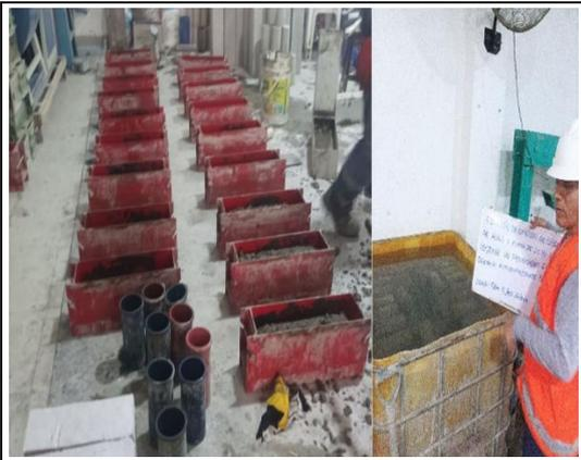
Vaceado del concreto autocompactante
