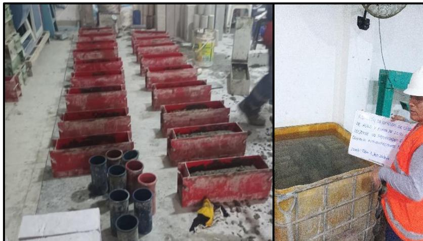
Figura 11. Preparado y curado del concreto
