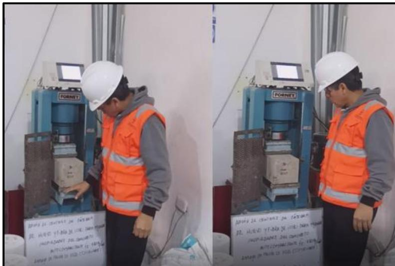
Figura 13. Ensayo de esfuerzo a la flexión
