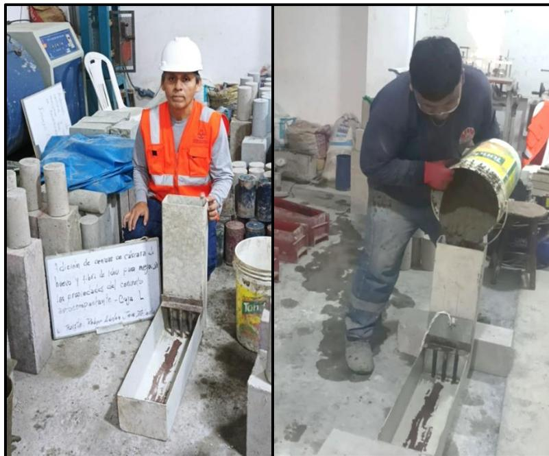
Figura 9. Fluides del concreto
