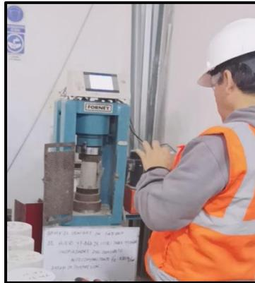
Figura 12. Ensayo de esfuerzo a la compresión
