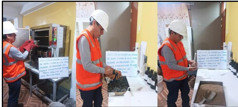
Figura 7. Absorción y peso específico del material grueso
