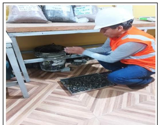
Peso específico del agregado grueso
