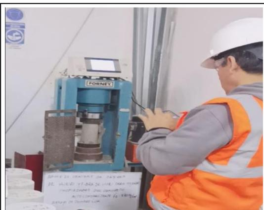
Ensayo de resistencia a compresión
