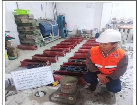
Peso unitario del concreto autocompactante
