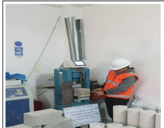
Ensayo de resistencia a flexión
