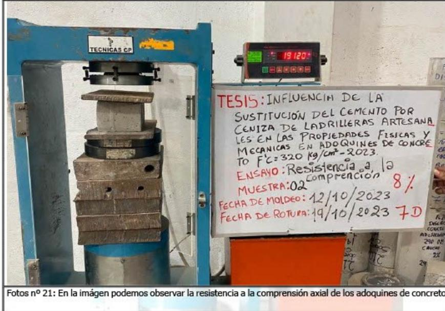
Fotos nº 21: En la imagen podemos observar la resistencia a la compresión axial de los adoquines de concreto
