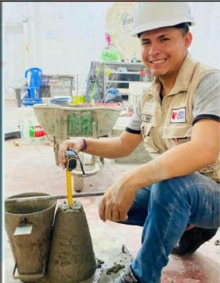
Fotos nº 15-16: En las imágenes podemos observar al personal realizando la prueba de asentamiento por los diseños de mezclas.
