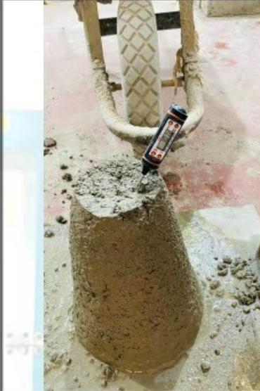
Fotos nº 13-14: En las imágenes podemos observar al personal realizando la prueba de asentamiento por los diseños de mezclas.
