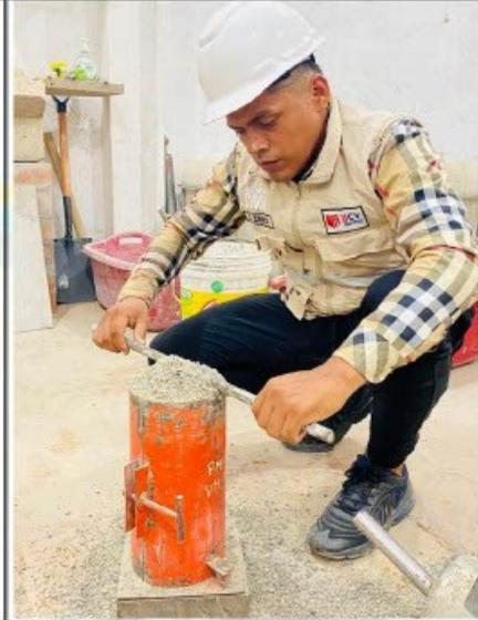
Fotos nº 09-10: En las imágenes podemos observar realización del ensayo de peso unitario.
