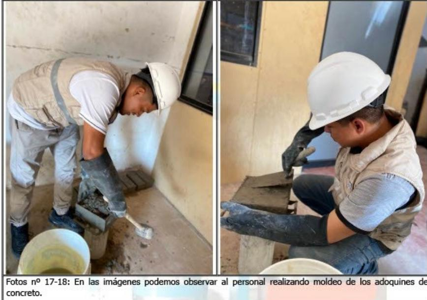
Fotos nº 17-18: En las imágenes podemos observar al personal realizando moldeo de los adoquines de concreto.
