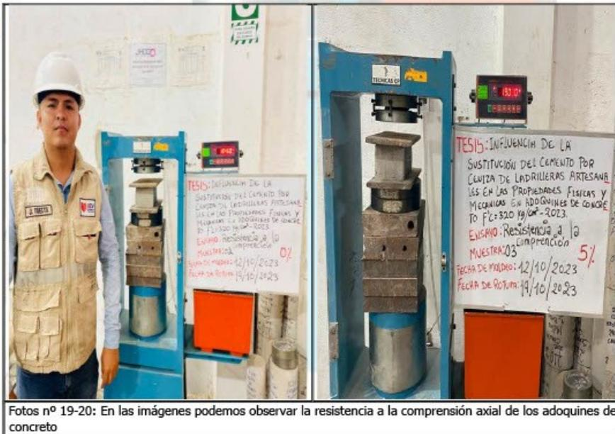
Fotos nº 19-20: En las imágenes podemos observar la resistencia a la compresión axial de los adoquines de concreto
