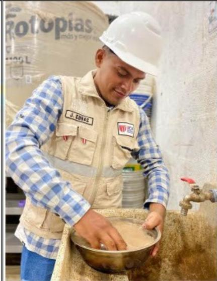
Fotos nº 05-06: En las imágenes se puede apreciar el ensayo de análisis granulométrico y lavado de agregado.
