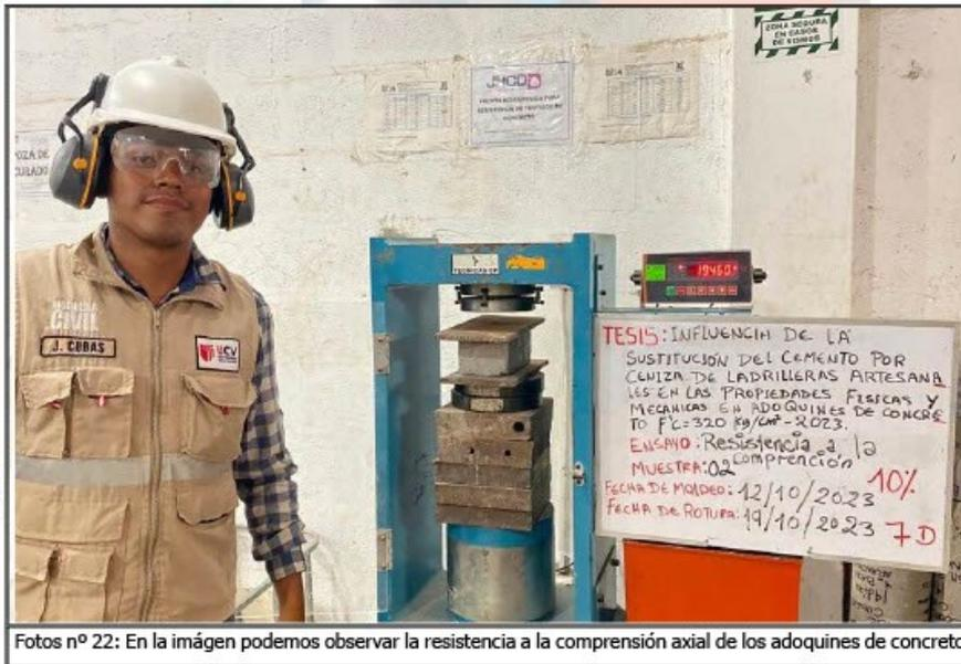
Fotos nº 22: En la imagen podemos observar la resistencia a la compresión axial de los adoquines de concreto
