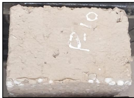
Figura 15. Color ladrillo con adición de poliestireno.
