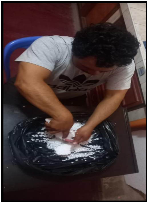
Trituración de material de adición (corcho y poliestireno).
