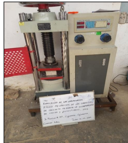
Figura 19. Ensayo compresión ladrillo experimental.
