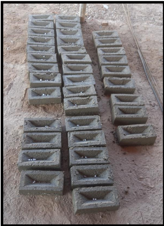
Ladrillos con adición de corcho y poliestireno.
