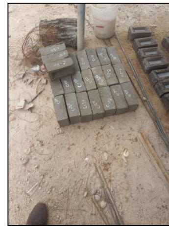
Figura 10. Apilamiento para curado.
