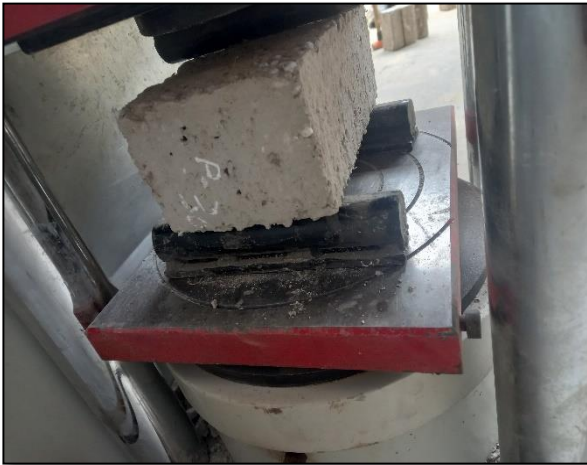
Figura 20. Esfuerzo de flexión.
