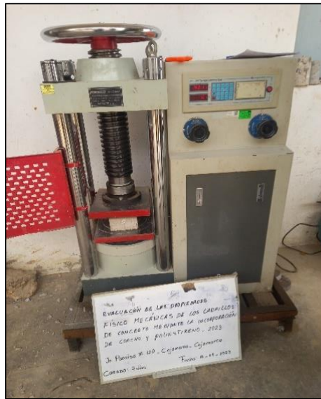
Figura 16. Máquina de ensayo ruptura.
