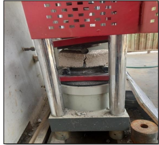
Figura 21. Ruptura por flexión
