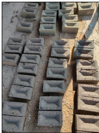
Figura 9. Secado de ladrillos
