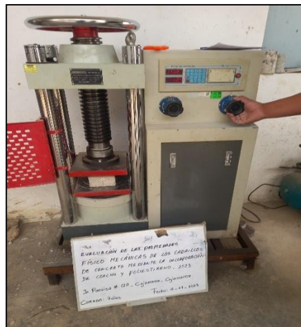
Figura 18. Ensayo compresión ladrillo base.
