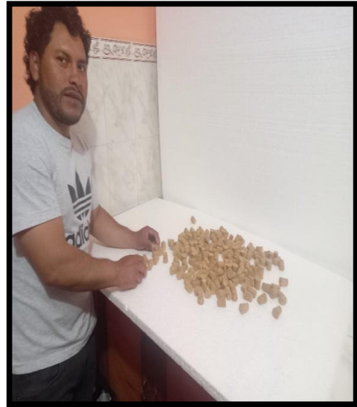
Trituración de material de adición (corcho y poliestireno).
