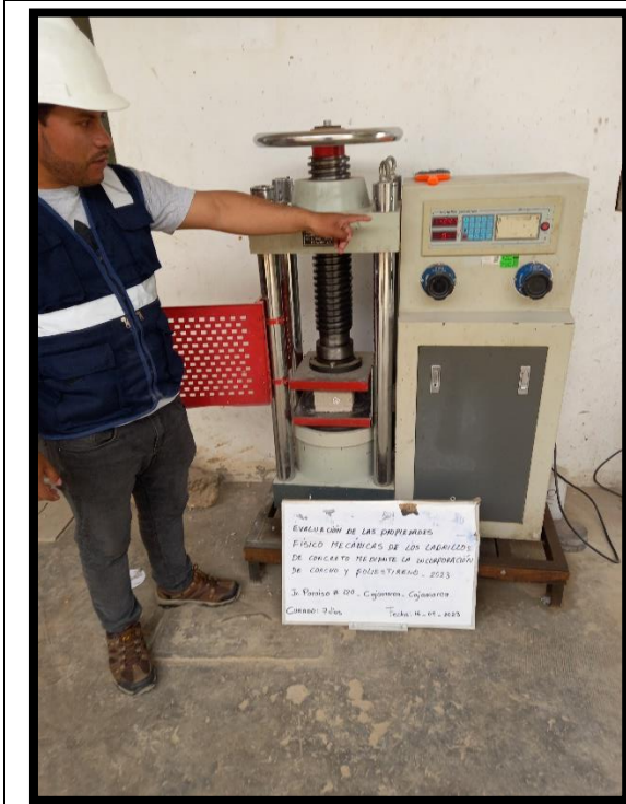
Ensayos mecánicos. A los 7 días de curado.
