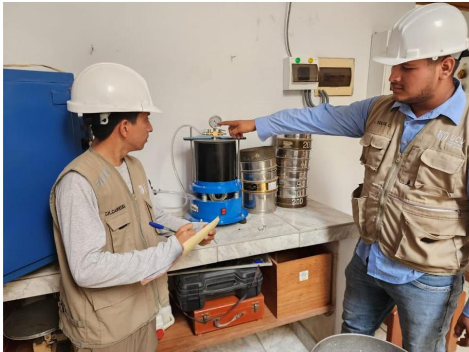
**Figuras anexo E. Ensayo con el picnometro de vacíos.**
