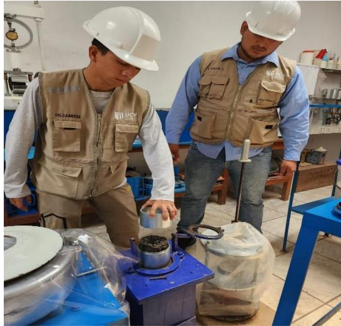
**Figuras anexo B.** Compactación de la mezcla asfáltica con el martillo compactador
