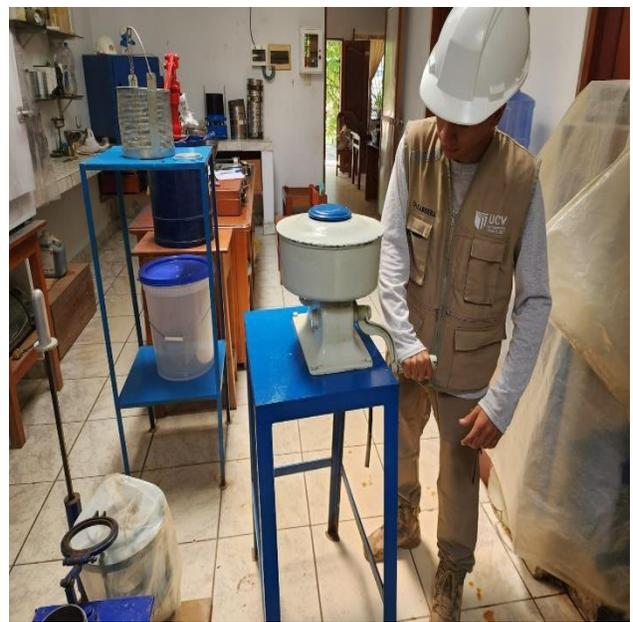
**Figuras anexo A. Lavado asfáltico por el método de centrifuga asfáltica**
