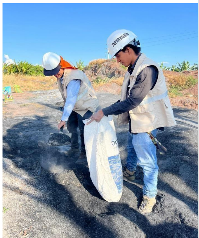
Fotos nº 07-08: En las imágenes se puede apreciar el muestreo de la ceniza de cascarilla de arroz.
