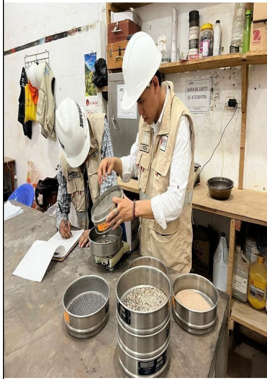
Fotos nº 09-10: En las imágenes se puede apreciar el ensayo de análisis granulométricos.
