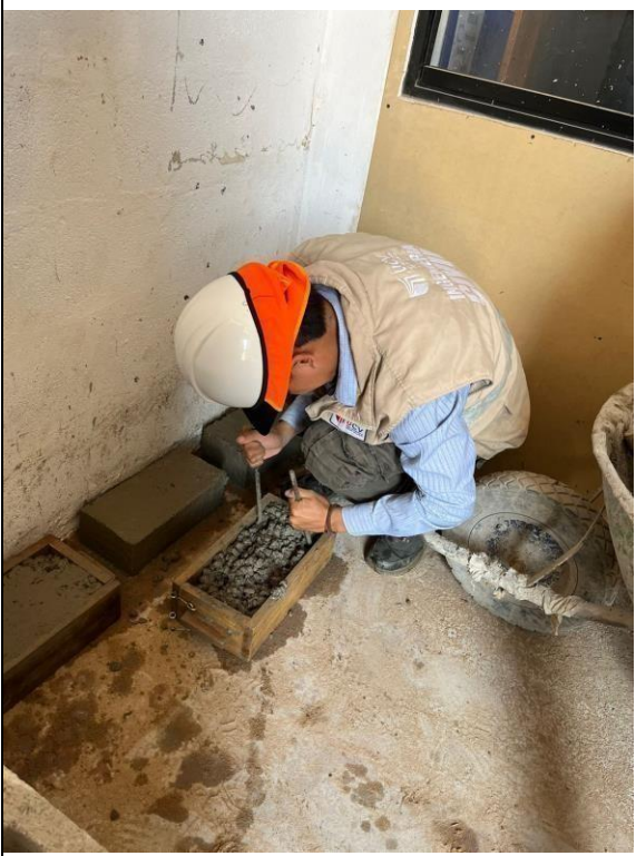
Fotos nº 25-26: En las imágenes podemos observar el moldeo de los bloques de concreto.
