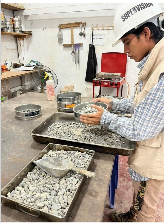
Fotos nº 09-10: En las imágenes se puede apreciar el ensayo de análisis granulométricos.
