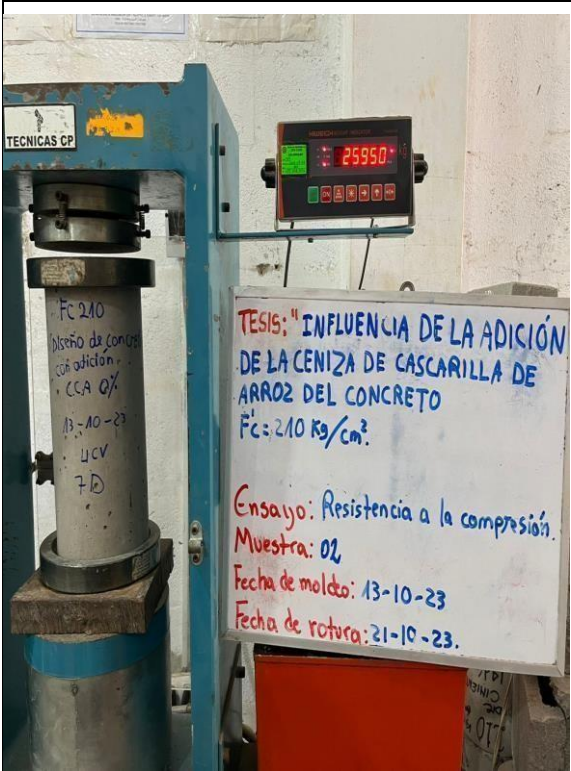
Fotos nº 29-30: En las imágenes podemos observar la resistencia a la compresión axial de los testigos de concreto
