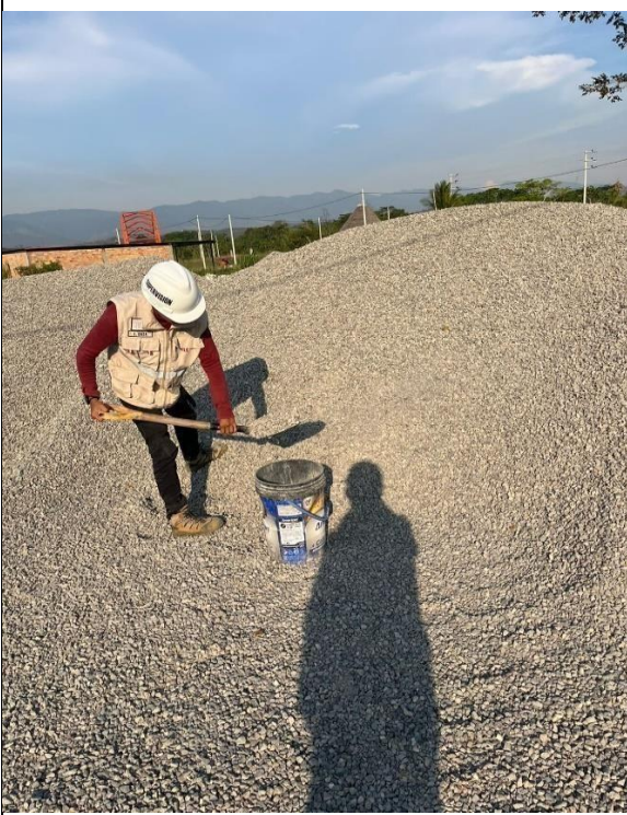
Fotos nº 01-02: En las imágenes se puede apreciar el muestreo de la grava chancada.
