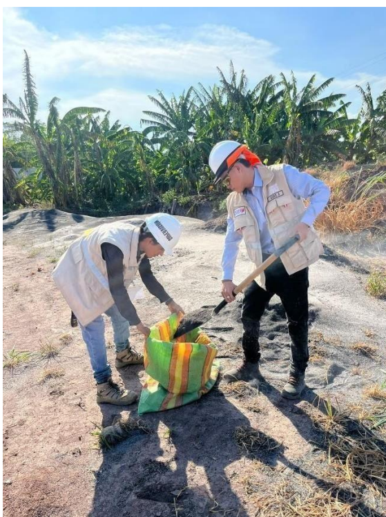
Fotos nº 07-08: En las imágenes se puede apreciar el muestreo de la ceniza de cascarilla de arroz.
