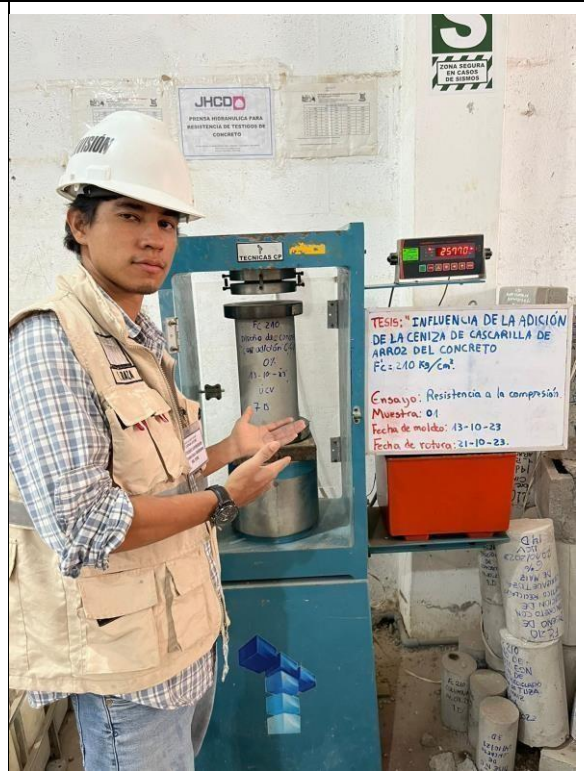
Fotos nº 29-30: En las imágenes podemos observar la resistencia a la compresión axial de los testigos de concreto
