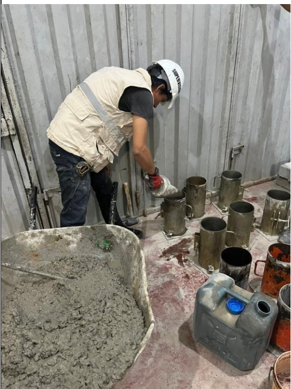
Fotos nº 23-24: En las imágenes podemos observar el moldeo de los testigos y bloques de concreto
