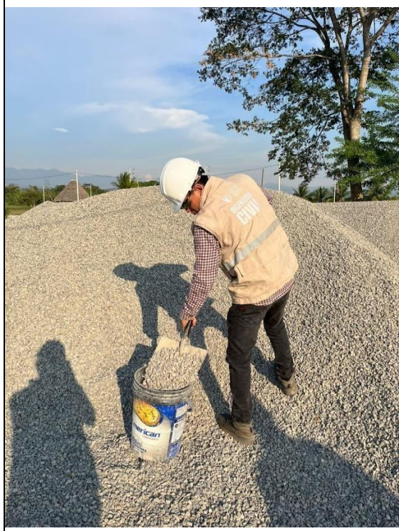
Fotos nº 01-02: En las imágenes se puede apreciar el muestreo de la grava chancada.
