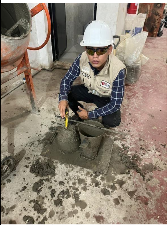
Fotos nº 21-22: En las imágenes podemos observar al personal realizando la prueba de asentamiento para los diseños de Mezclas.
