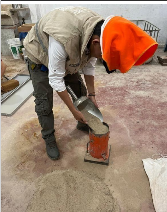
Fotos nº 11-12: En las imágenes podemos observar realización del ensayo de peso unitario de la arena zarandeada.
