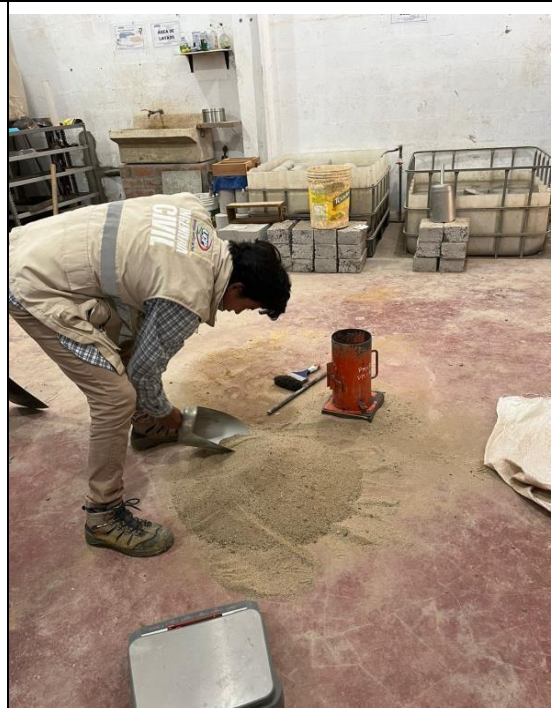
Fotos nº 11-12: En las imágenes podemos observar realización del ensayo de peso unitario de la arena zarandeada.
