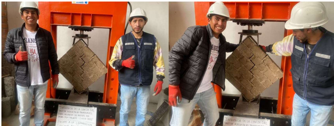
Figura 10 Ensayo a compresión Diagonal de los muretes
