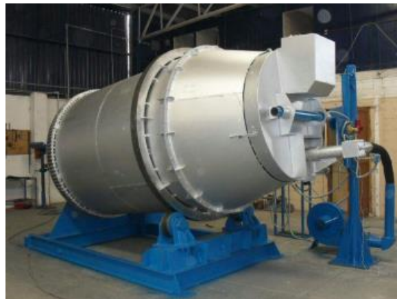
Figura 3. Horno de fundición rotativo para la fundición de metales Fuente: Extraído de Capra (2020)
