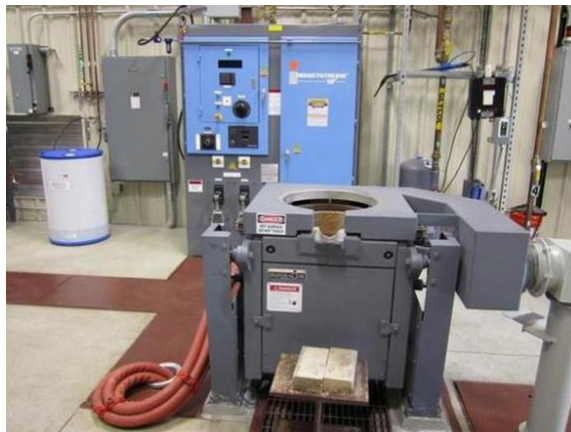
Figura 5. Horno de fundición eléctrica de inducción para metales Fuente: Extraído de García (2020).
