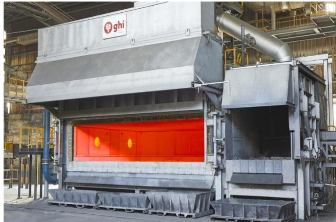
Figura 2. Horno de reverbero para la fundición de diversos metales no ferrosos. Fuente: Extraído del Flores et al. (2021).
