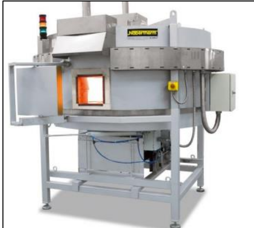
Figura 4. Horno de solera para fundición de metales reciclados. Fuente: Extraído de Guo (2021).
