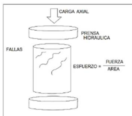
Figuras 3. Ensayo del esfuerzo a la compresión.
