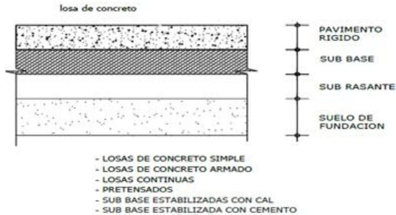
Figuras 2: Capas típica del pavimento rígido
