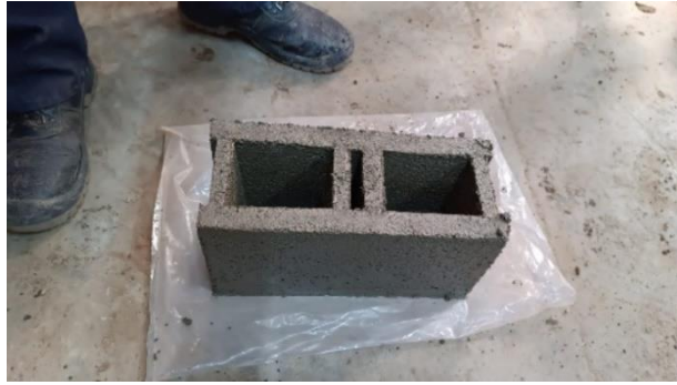
Figura 1. Bloque de concreto elaborado
