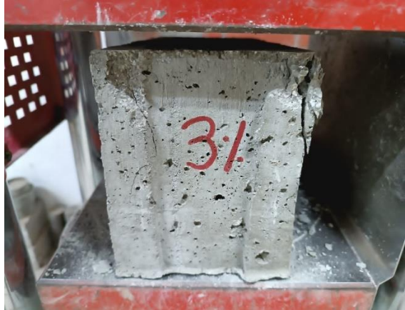
ROTURA DEL BLOQUE DE CONCRETO EN PORCENTAJE 3% A LOS 14 DÍAS
