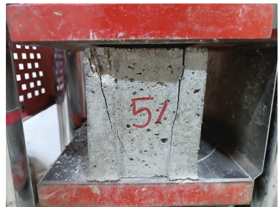
ROTURA DEL BLOQUE DE CONCRETO EN PORCENTAJE 5% A LOS 14 DÍAS
