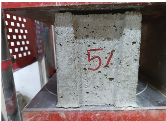
ROTURA DEL BLOQUE DE CONCRETO EN PORCENTAJE 5% A LOS 14 DÍAS
