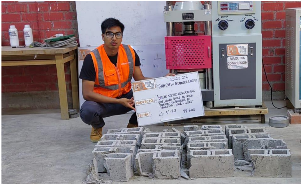
FOTO CON LOS BLOQUES A LOS 28 DÍAS DE SU ROTURA
