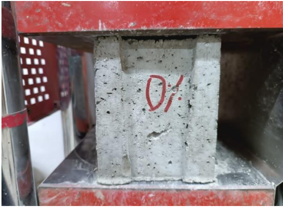
ROTURA DEL BLOQUE DE CONCRETO EN PORCENTAJE 0% A LOS 14 DÍAS
