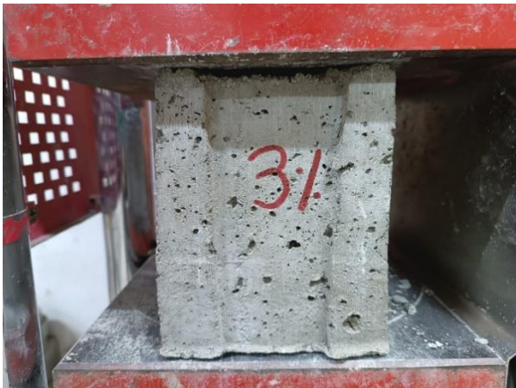
ROTURA DEL BLOQUE DE CONCRETO EN PORCENTAJE 3% A LOS 14 DÍAS
