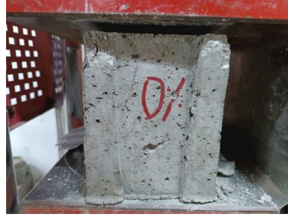
ROTURA DEL BLOQUE DE CONCRETO EN PORCENTAJE 0% A LOS 14 DÍAS
