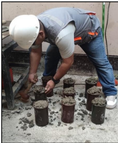
Moldeo de probetas cilíndricas
