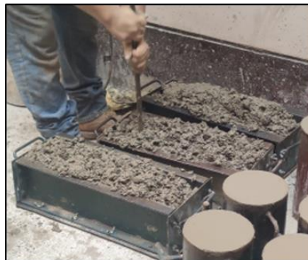
Llenado y compactado de vigas
