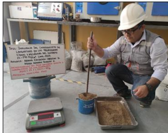
Compactado y enrasado del agregado fino
