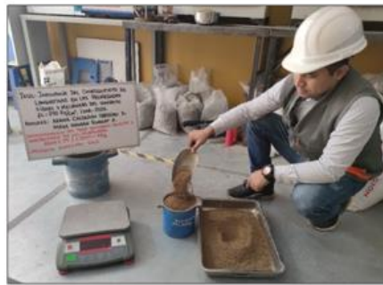
Llenado del molde con agregado fino
