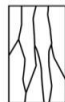
Tipo 3 Fisuras verticales encolumnadas a través de ambos extremos, conos no bien formados
