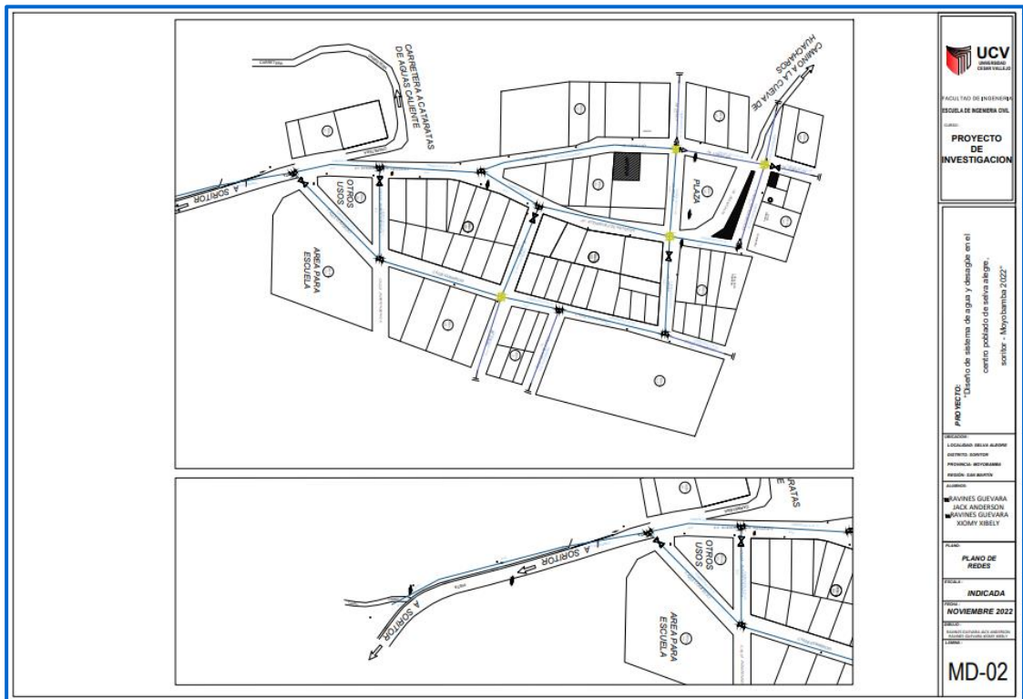
Figura 8: Plano de redes proyectadas para el sistema de agua del centro poblado Selva Alegre, 2023.
