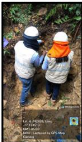
Fotografía N° 04. Excavación y extracción de muestras de calicatas para sus respectivos ensayos.
