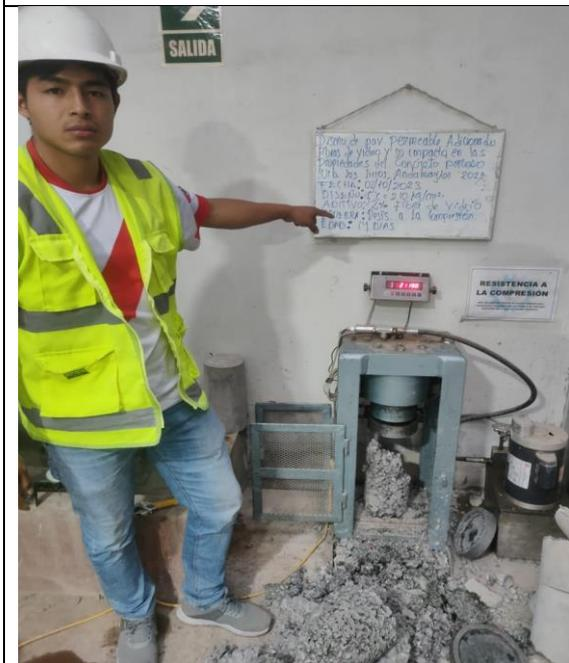
Figura 46: Ensayo resistencia a la compresión a los 14 días, testigo al 1% fibra de vidrio.
