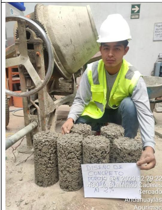
Figura 26: Desencofrado de probetas al 2% de fibra de vidrio.
