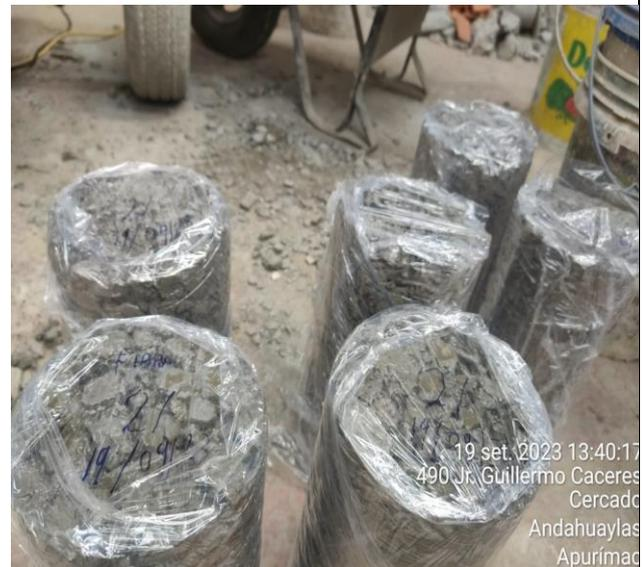
Figura 31: Curado de las probetas con fibras de vidrio al 3%.
