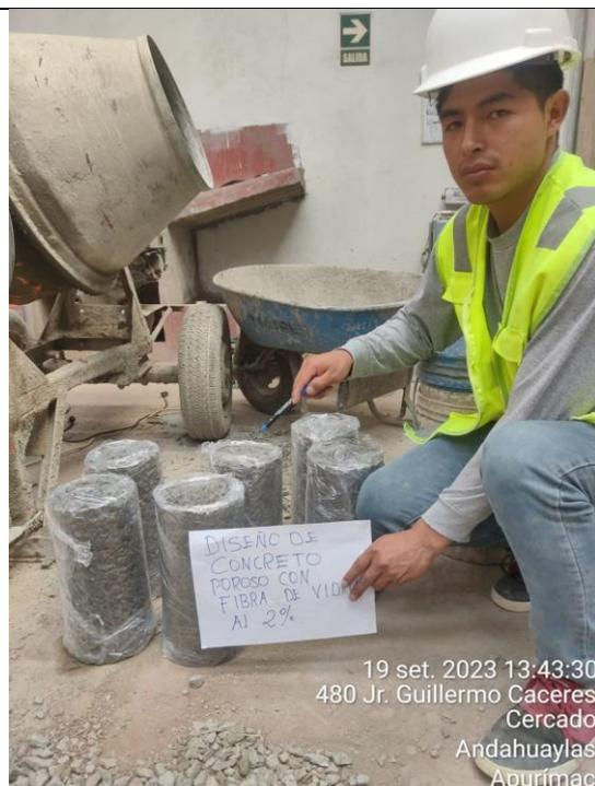
Figura 27: Curado de las probetas con fibras de vidrio al 2%.
