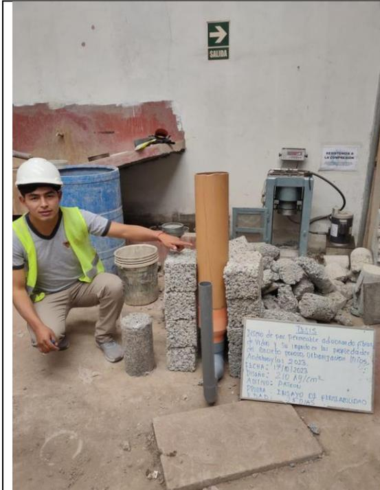
Figura 52: Ensayo de la permeabilidad de la probeta patron.
