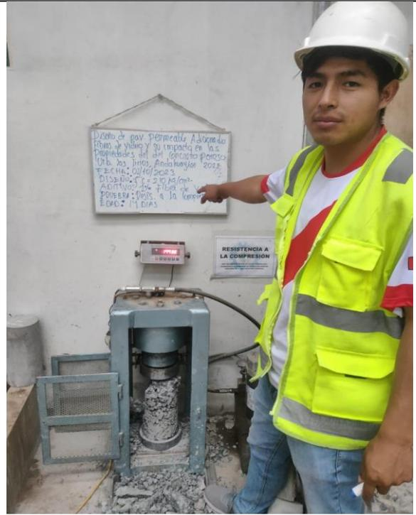
Figura 45: Ensayo resistencia a la compresión a los 14 días, testigo al 1% fibra de vidrio.
