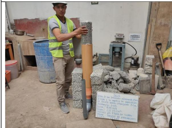
Figura 54: Ensayo de la permeabilidad de la probeta al 2% con fibra de vidrio.
