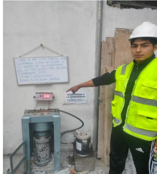
Figura 17. Ruptura a la compresión
