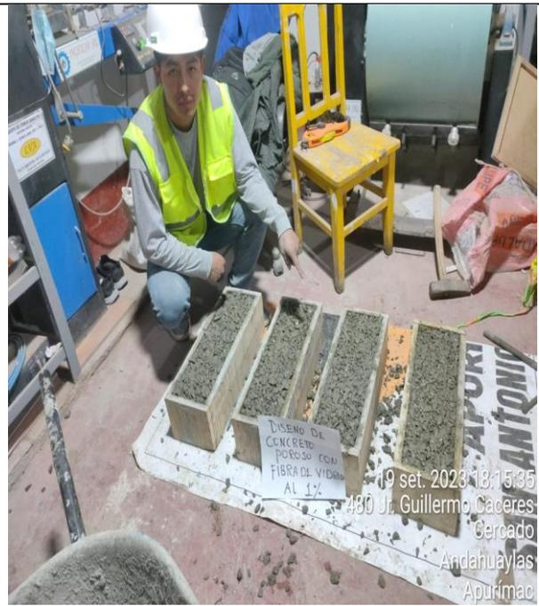
Figura 33: Elaboración de concreto poroso con fibra de vidrio al 1% para el ensayo a flexión.
