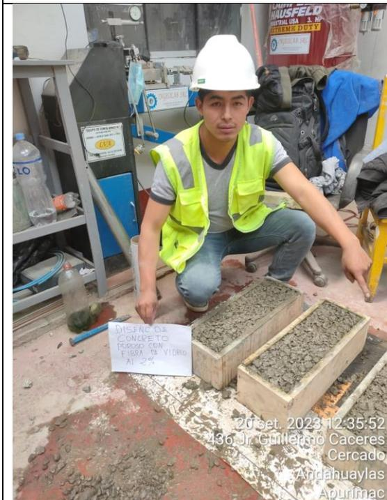
Figura 34: Elaboración de concreto poroso con fibra de vidrio al 2% para el ensayo a flexión.
