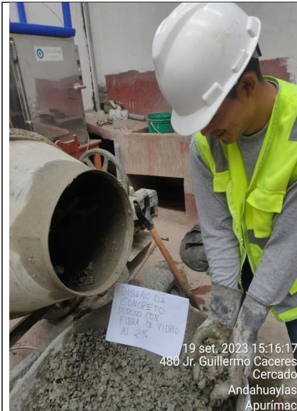
Figura 24: Concreto poroso con fibra de vidrio al 2%.
