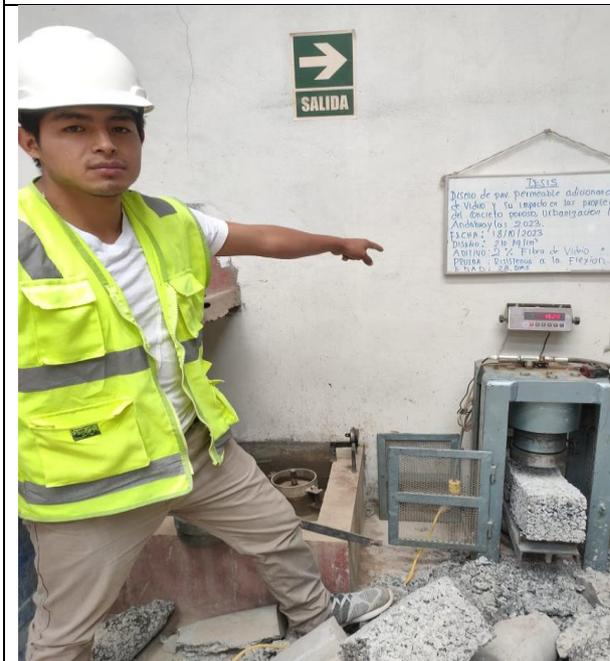
Figura 50: Ensayo resistencia a la flexión a los 28 días, testigo al 2% fibra de vidrio.
