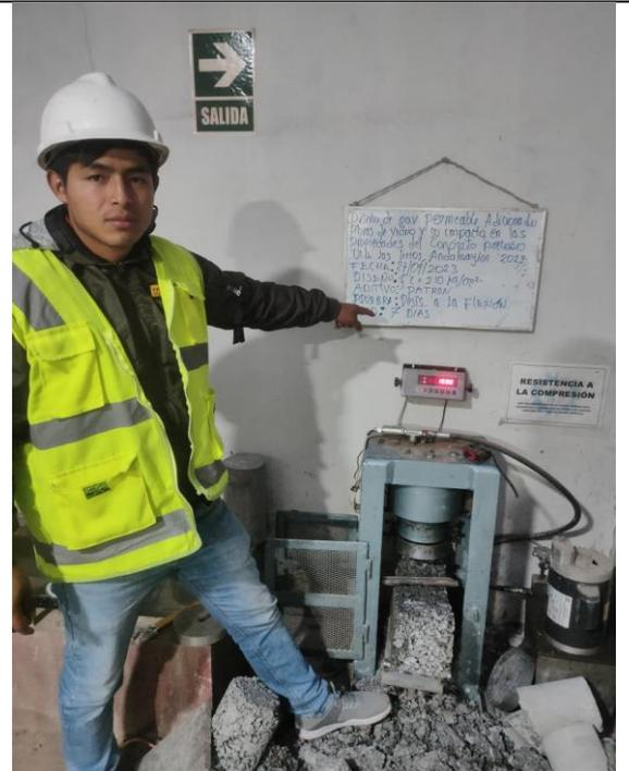
Figura 41: Ensayo resistencia a la flexión a los 7 días, testigo patron.
