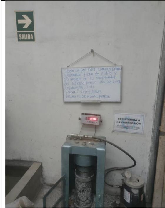
Figura 40: Ensayo resistencia a la compresión a los 7 días, testigo patron.
