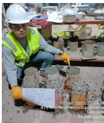
*Figura 10. Concreto permeable al 2%*
