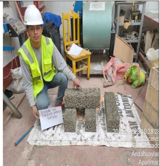
Figura 37: Desencofrado de los testigos.
