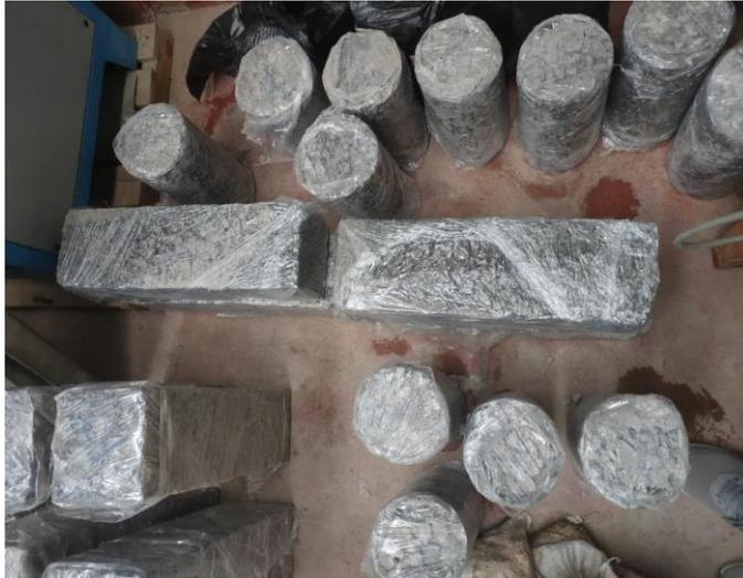
*Figura 12. Curado de concreto permeable*
