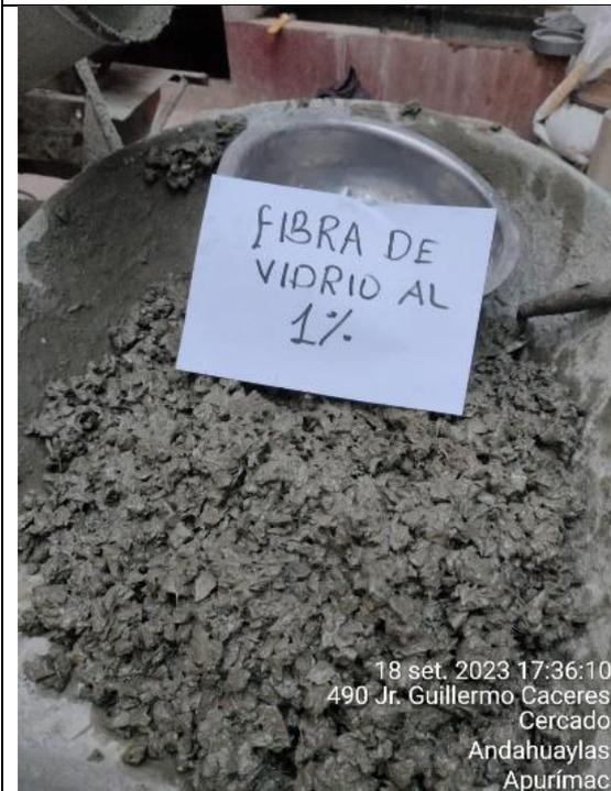
Figura 18: Concreto poroso con fibra de vidrio al 1%.
