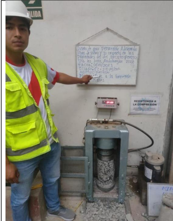
Figura 44: Ensayo resistencia a la compresión a los 14 días, testigo patron.
