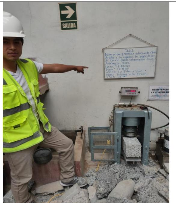
Figura 47: Ensayo resistencia a la flexión a los 14 días, testigo al 2% fibra de vidrio.
