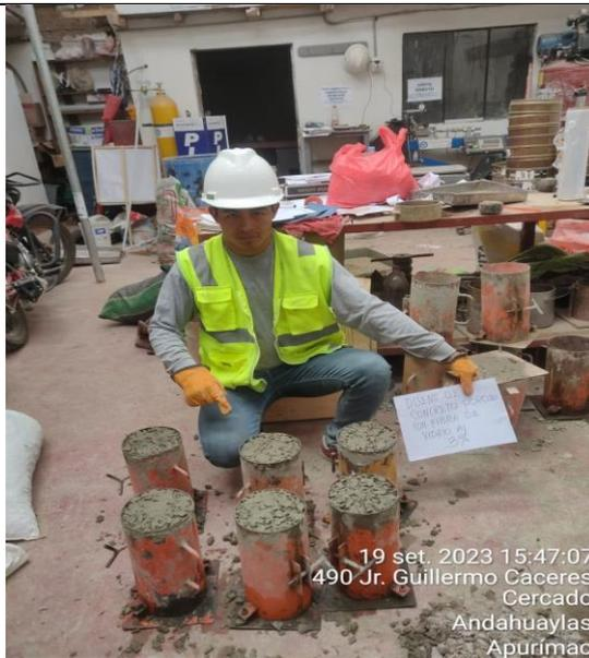
Figura 30: Elaboración de probetas al 3% con fibra de vidrio.
