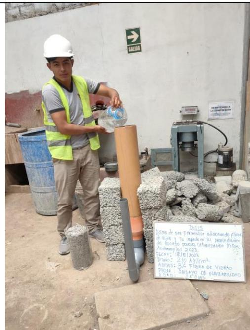
Figura 56: Ensayo de la permeabilidad de la probeta al 3% con fibra de vidrio.
