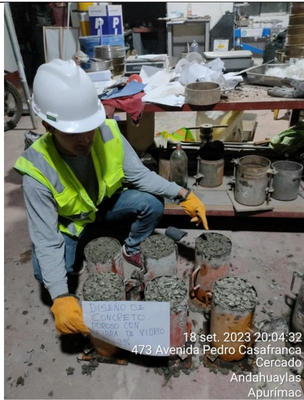
Figura 25: Elaboración de probetas al 2% con fibras de vidrio.
