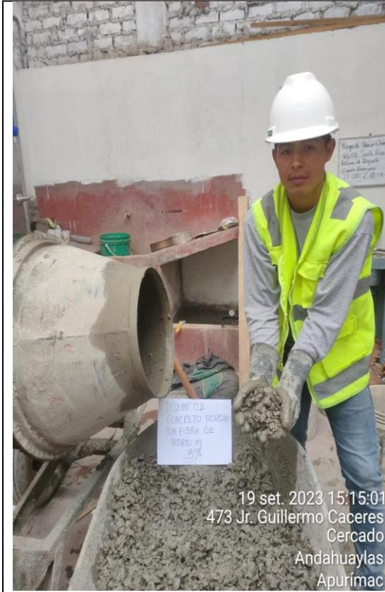
Figura 28: Concreto poroso con fibra de vidrio al 3%.
