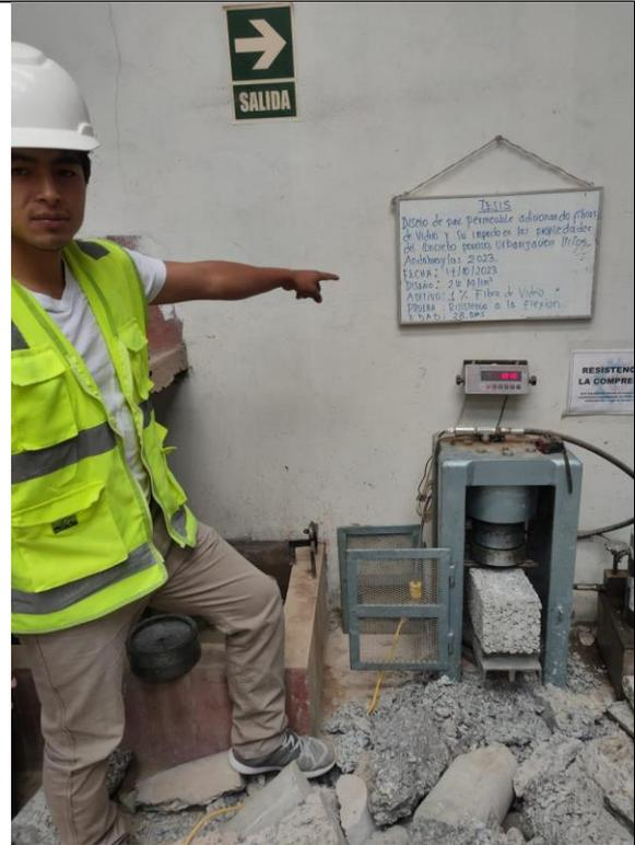
Figura 49: Ensayo resistencia a la flexión a los 28 días, testigo patrón.
