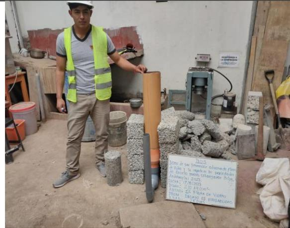
Figura 53: Ensayo de la permeabilidad de la probeta al 1% con fibra de vidrio.
