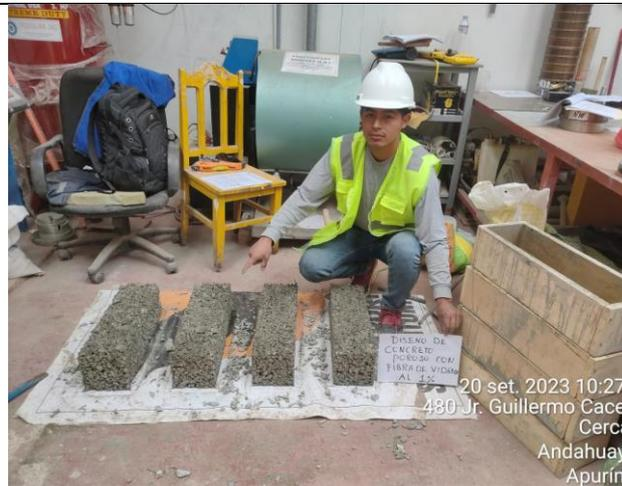
Figura 38: Desencofrado de los testigos.
