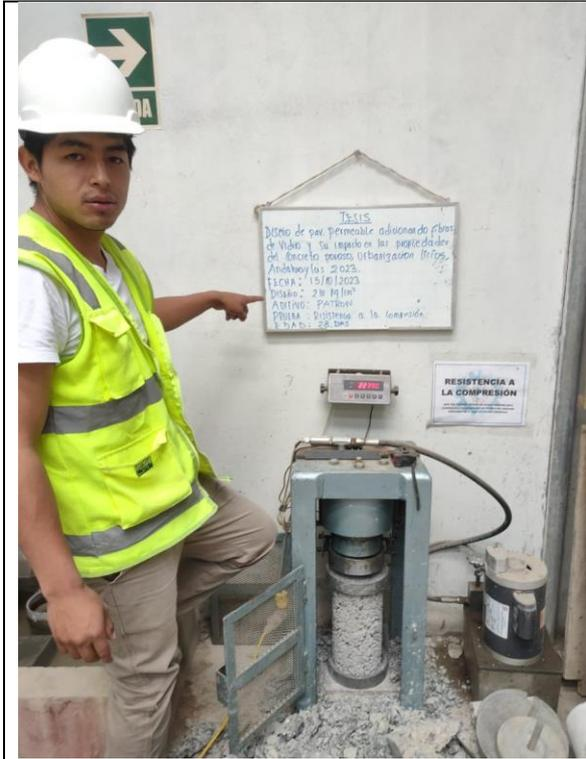
Figura 48: Ensayo resistencia a la compresión a los 28 días, testigo patrón.
