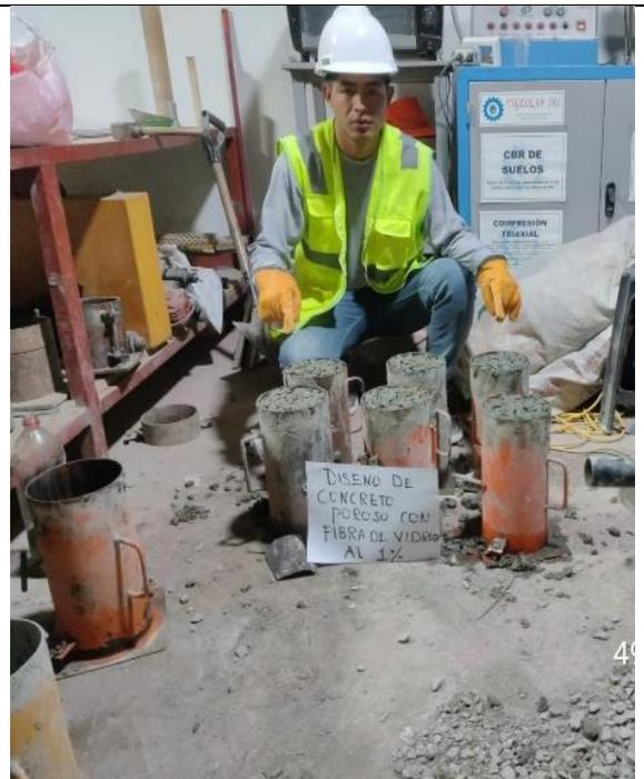
Figura 19: Elaboración de probetas al 1% con fibra de vidrio.
