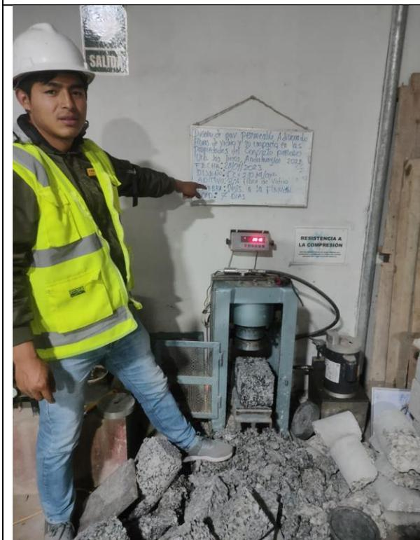
Figura 42: Ensayo resistencia a la flexión a los 7 días, testigo al 2% fibra de vidrio.
