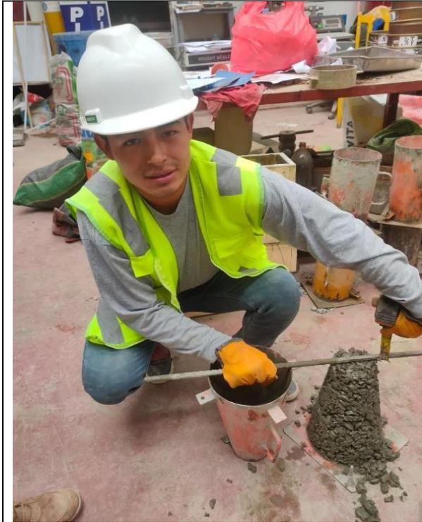
Figura 20: Ensayo del SLUMP.
