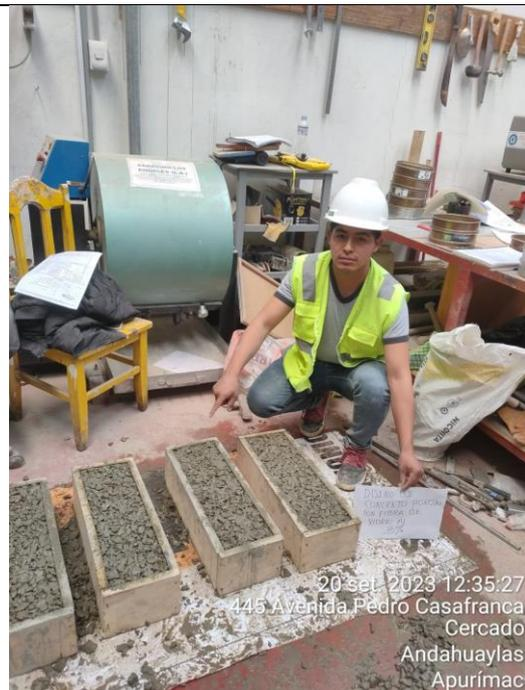
Figura 35: Elaboración de concreto poroso con fibra de vidrio al 3% para el ensayo a flexión.
