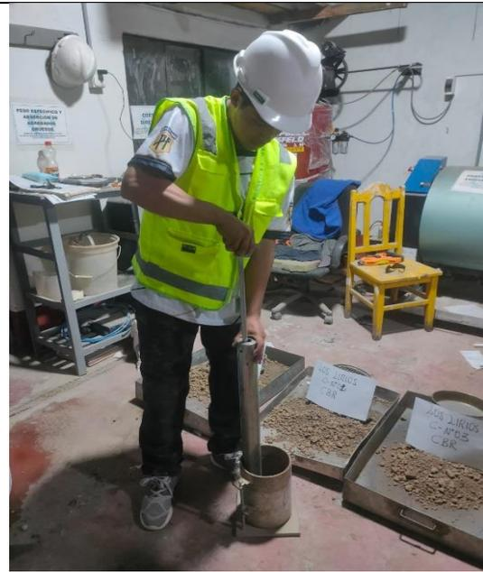
Figura 12: Ensayo de CBR.
