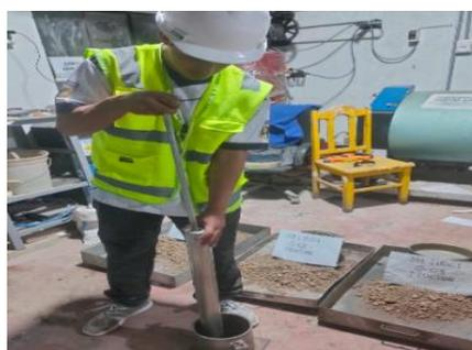
*Figura 8. Ensayo proctor*
