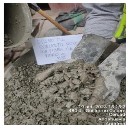
*Figura 11. Concreto permeable al 3%*
