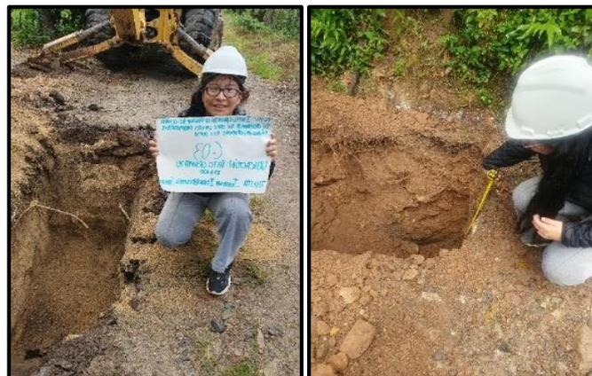
*Figura 8.* Excavación de calicatas y extracción de muestra.
