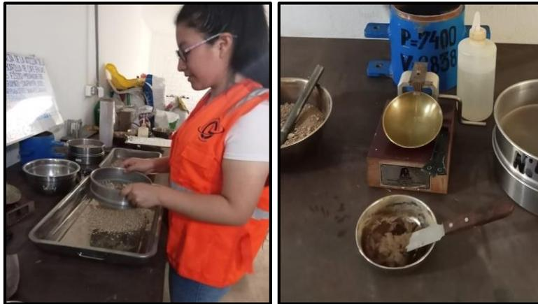
Figura 13. Procedimiento para ensayo de Límites de Atterberg.
