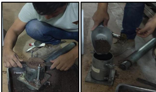
Figura 16. Proceso del ensayo del Proctor Modificado.
