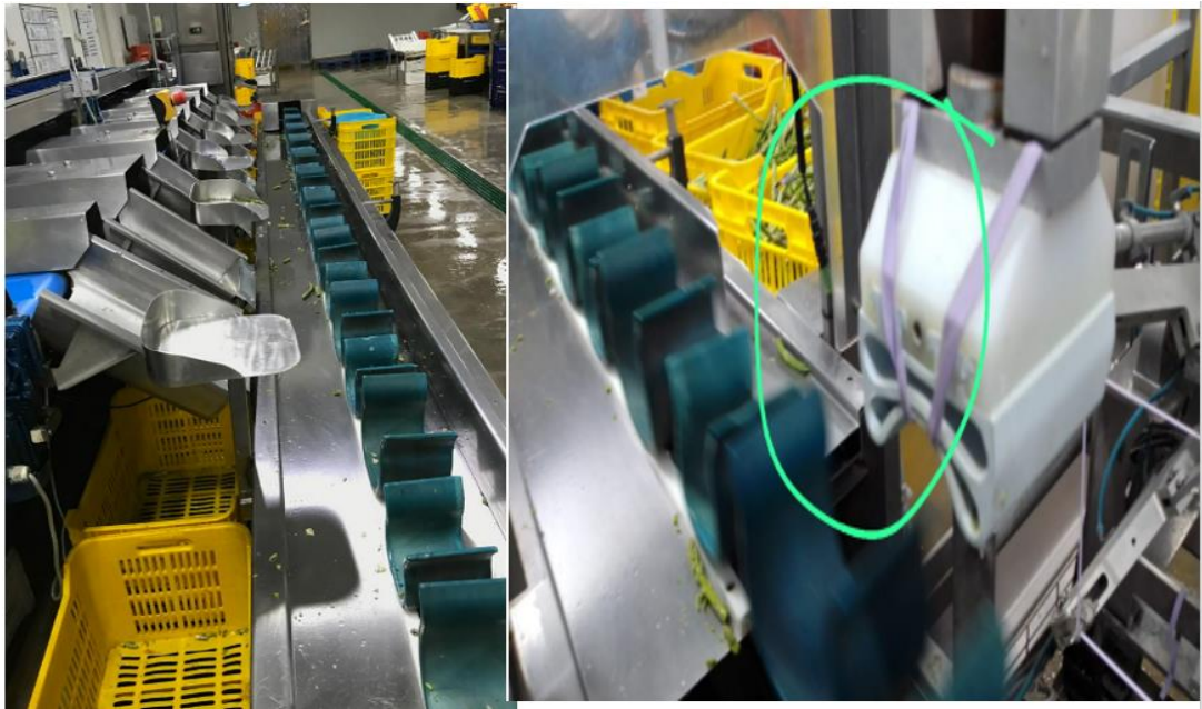
Figura 12. Modificación en los cangilones metálicos
