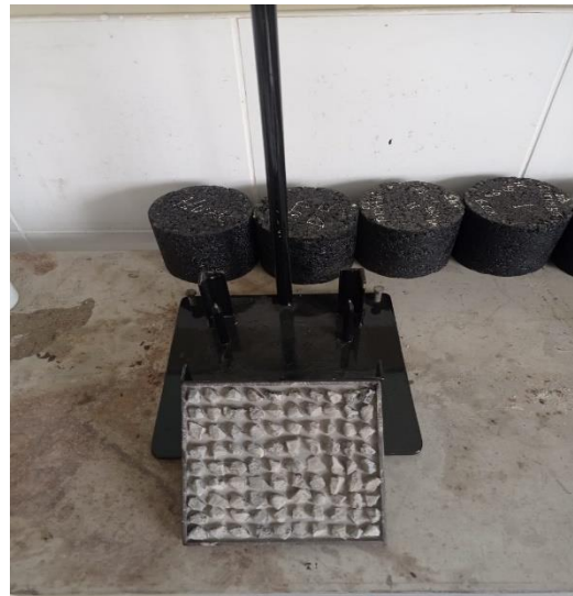
Placa vialiti a 3% ceniza de madera a T° 25°C
