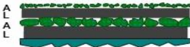
Figura. 6 Tratamiento de dos capas o tratamiento de doble superficie,
