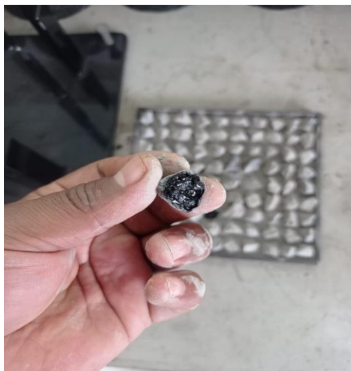
Verificación de emulsión asfáltica con ceniza de madera con 5%
