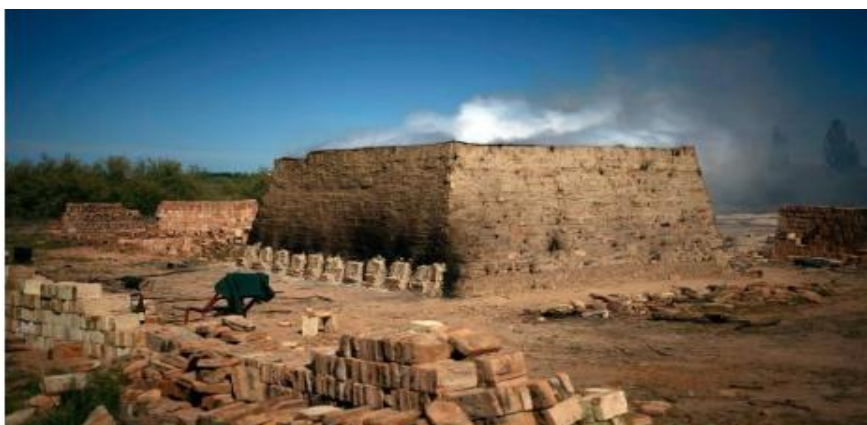
Figura.1 Horno de ladrillos hecho a mano
