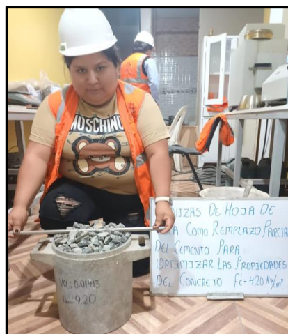
Figura 9. PUS de los agregados
