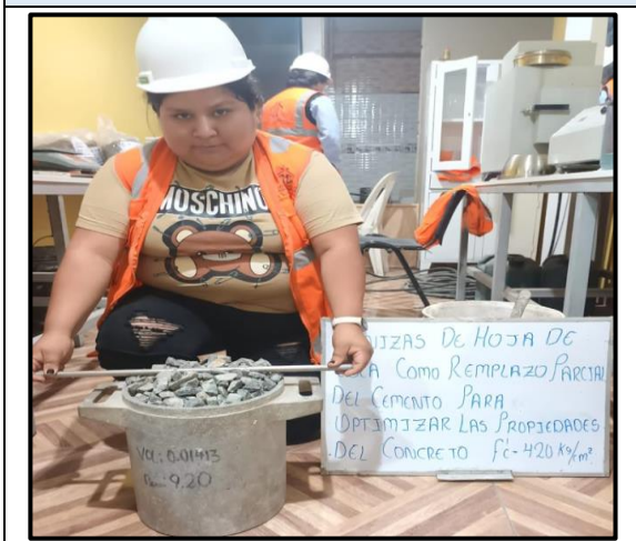
Etapa 05. PUS de los agregados
