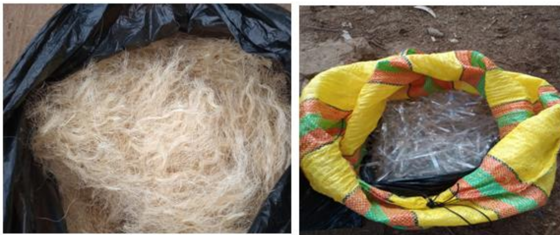
Figura 6. Fibras de cabuya y fibras de botella plástica
