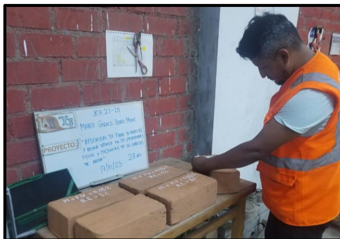
Figura 17: Variación dimensional con adición de fibra de vidrio E y resina epóxica.
