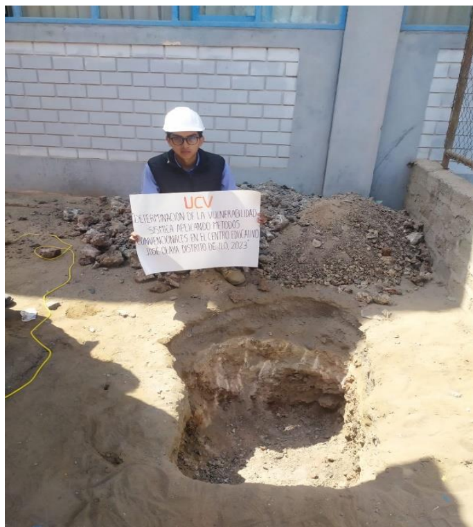
Se visualiza a los 0.80m de profundidad un suelo calcáreo
