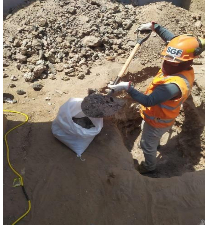
Extrayendo la 1era muestra (M1) en un saco para posteriormente derivarlo al laboratorio.
