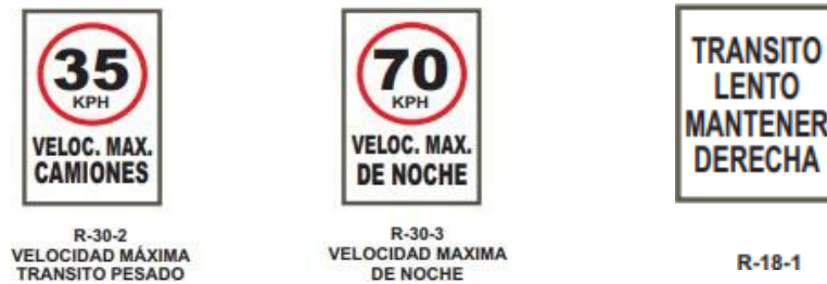
FIGURA N° 04: Señales de restricción (R – 30 – 2, R – 30 – 3 y R – 18 – 1).
