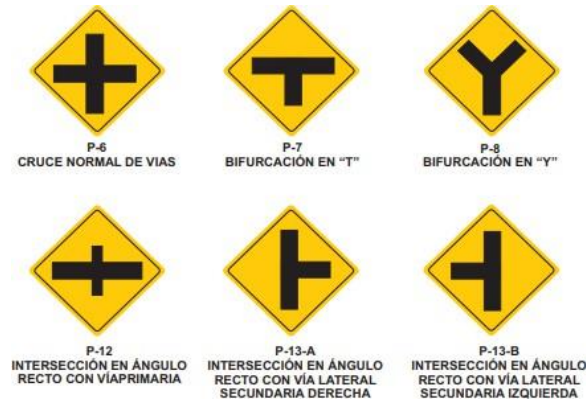
FIGURA N° 09: Señales preventivas debido a intersecciones
