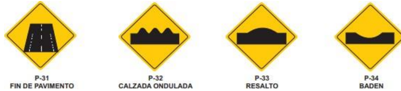
FIGURA N° 08: Señales preventivas debido a la superficie de rodadura
