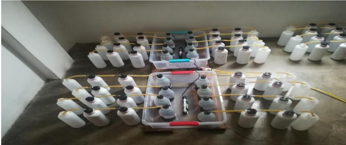
**Figura 10.** Ensayo de PBM
