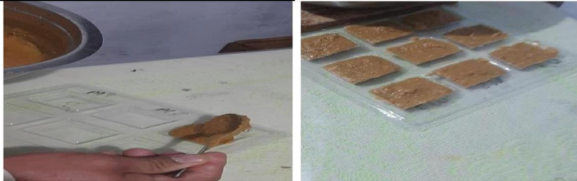
**Figura 8.** *Recepción de la mezcla en moldes.*
