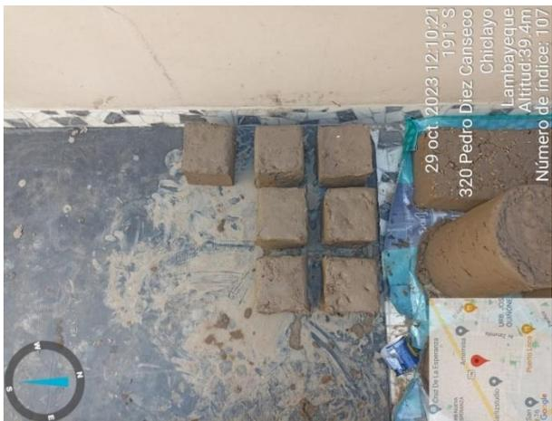
Testigos para ensayos de laboratorio
