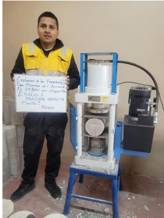
*Nota.* Se muestran las pruebas de Resistencias a tracción a los 28 días de madurez.
