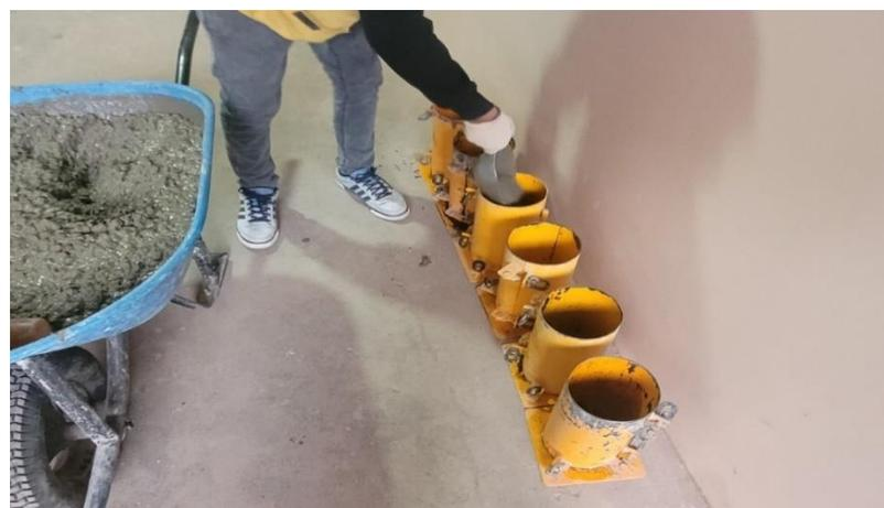
*Nota.* Se ilustra el procedimiento de colocación de las mezclas en los moldes de acero, preparándolos para los ensayos respectivos.
