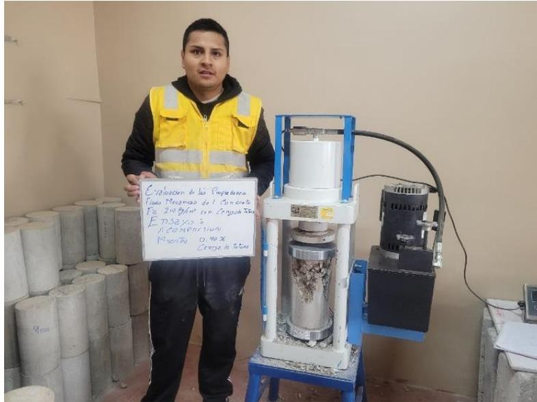
Nota. Se muestran el ensayo de Resistencia a la Compresión a los 14 días de madurez.
