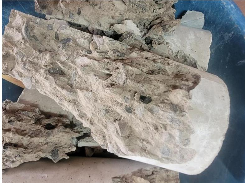
*Nota.* Se muestran briqueta ensayada a Resistencias a la Tracción indirecta a los 7 días de madurez.
