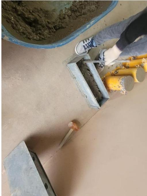
*Nota.* Se muestra el mezclado y dosificación de ceniza de totora en la mezcla para de viguetas de concreto ser ensayadas respectivamente.
