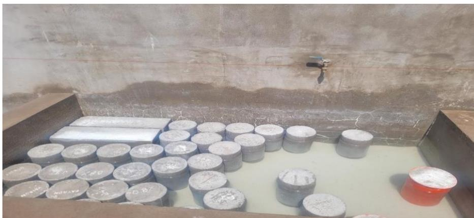
*Nota.* Se muestra a continuación las muestras de concreto tanto de briquetas circulares, así como viguetas rectangulares para ser ensayadas respectivamente.
