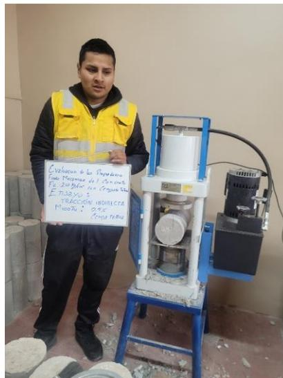
*Nota.* Se muestran las pruebas de Resistencias a tracción a los 14 días de madurez.
