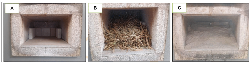
Imagen N°1: IMÁGENES DE SERVICIO DE CALCINACIÓN: (A) Mufla zona Interna, (B) Mufla con muestra, (C) Mufla con la muestra después de calcinación
