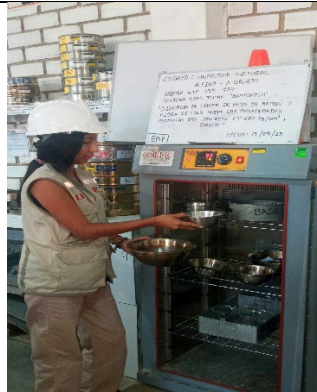
Ensayo de humedad natural
