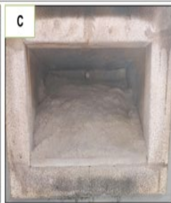
(A) Mufla zona interna; (B) Mufla con muestra, (C) Mufla con la muestra después de la calcinación
