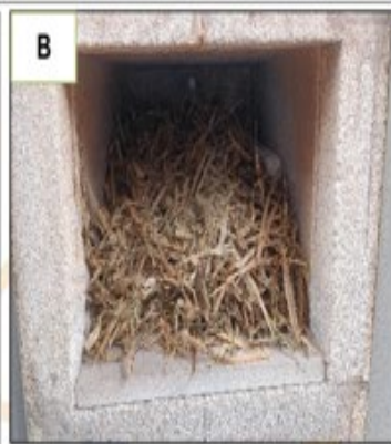
(A) Mufla zona interna; (B) Mufla con muestra, (C) Mufla con la muestra después de la calcinación
