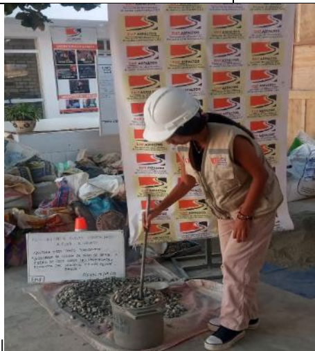
Ensayo de peso unitario suelto compactado - agregado grueso
