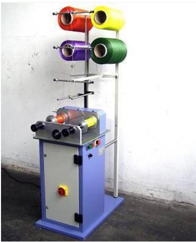
Figura 3 Máquina bobinadora para hilos modelo RG K200
