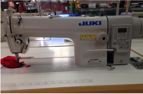
Figura 2 Máquina recta YUKI modelo DDL-8100B-7
