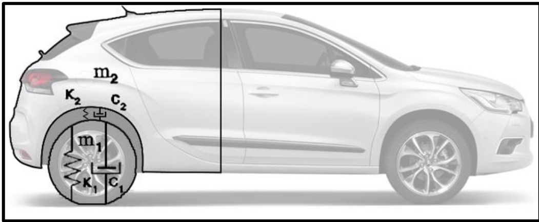
Figura 8. Modelo de cuarto de carro (Harris 2017).
