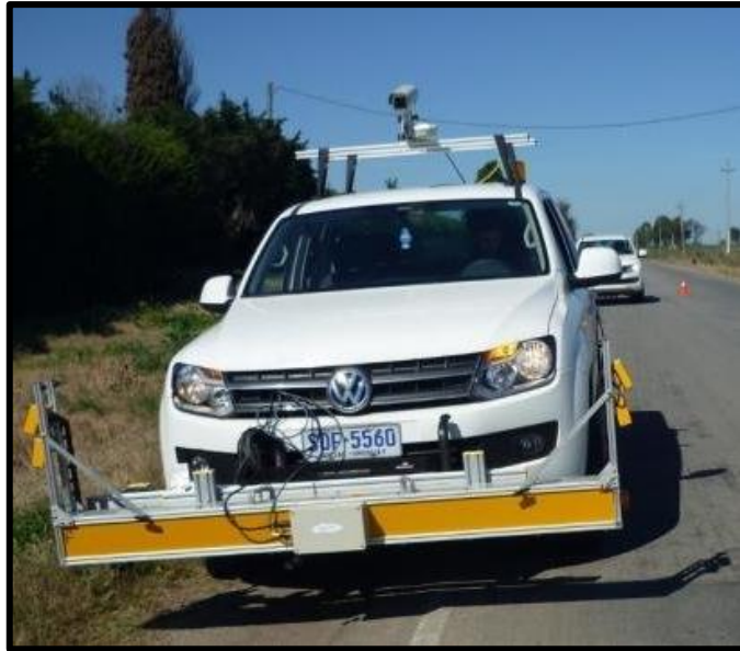
Figura 9. Perfilómetro a láser (Universidad de la República 2015).
