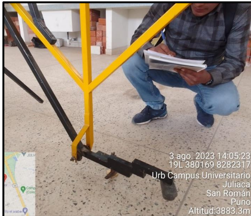
Figura 19. Lecturas de datos de la calibración del rugosímetro MERLÍN
