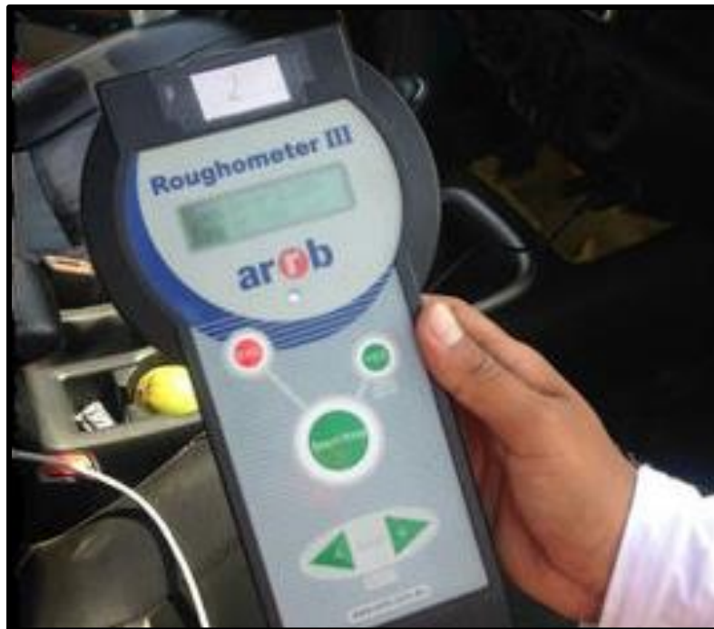
Figura 14. Rugosímetro Roughometer III (Solostocks.cl., 2018).
