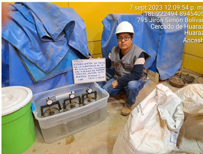
Figura 24. Ensayo de CBR, se sumerge en agua los moldes durante 96 horas.
