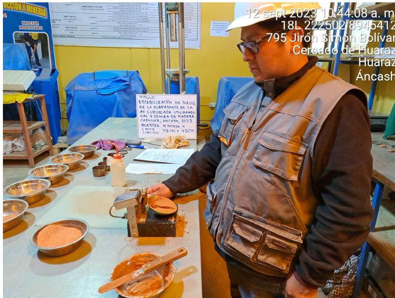
Figura 16. Ensayo de Limite Liquido.
