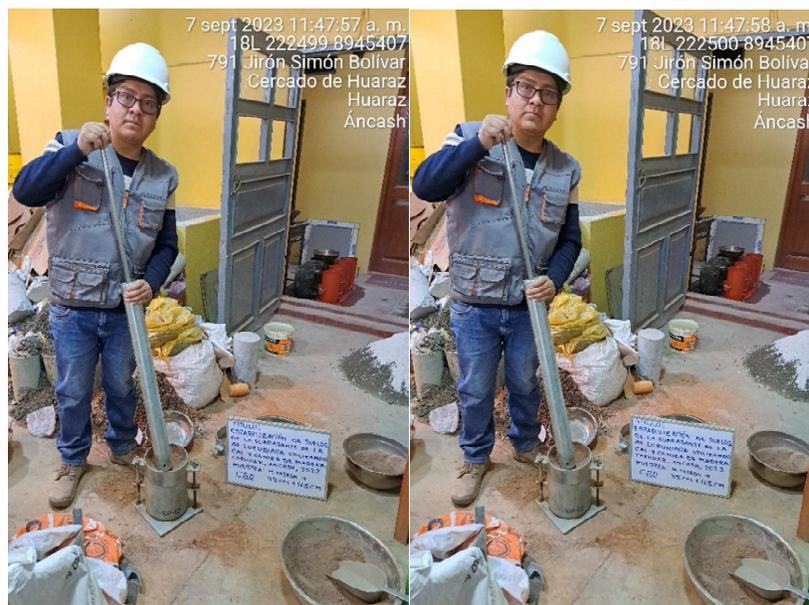
Figura 22. Ensayo de California Bearing Ratio (CBR), compactación de la muestra dosificada en 5 capas dando 56, 25 y 12 golpes por capa.
