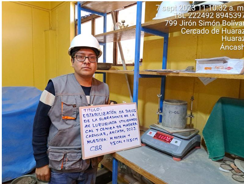
Figura 23. Ensayo de CBR, peso de molde más la muestra compactada sin sumergir.
