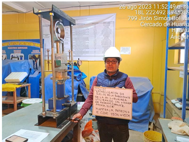
Figura 26. Ensayo de CBR, ensayo de penetración.
