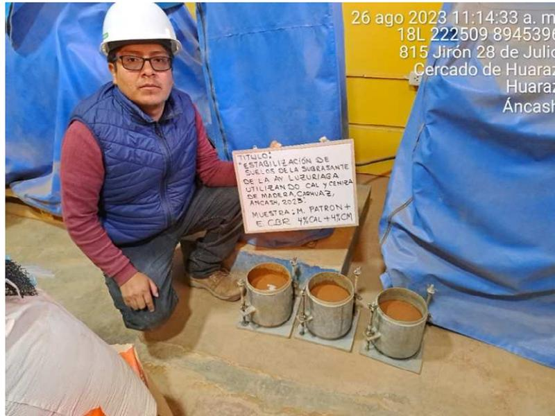
Figura 25. Ensayo de CBR, se sumerge en agua la probeta durante 96 horas.
