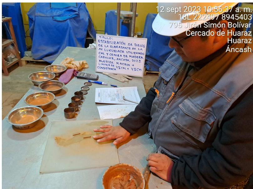
Figura 17. Ensayo de Limite Plástico.
