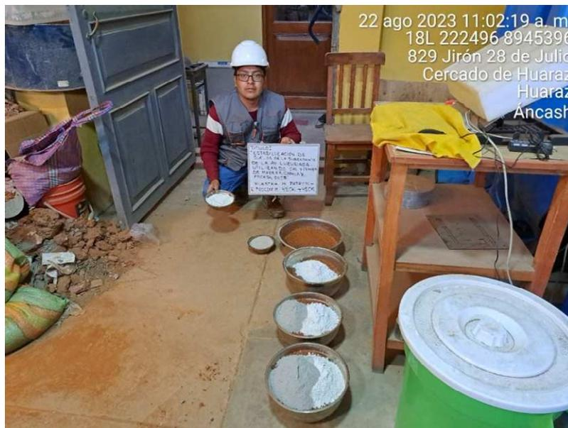
Figura 28. Muestra patrón dosificada con 4%CA + 8%CM.
