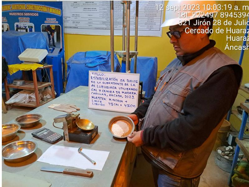
Figura 27. Muestra patrón dosificada con 4% CA + 4% CM.
