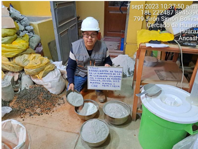
Figura 29. Muestra patrón dosificada con 4%CA + 12%CM.
