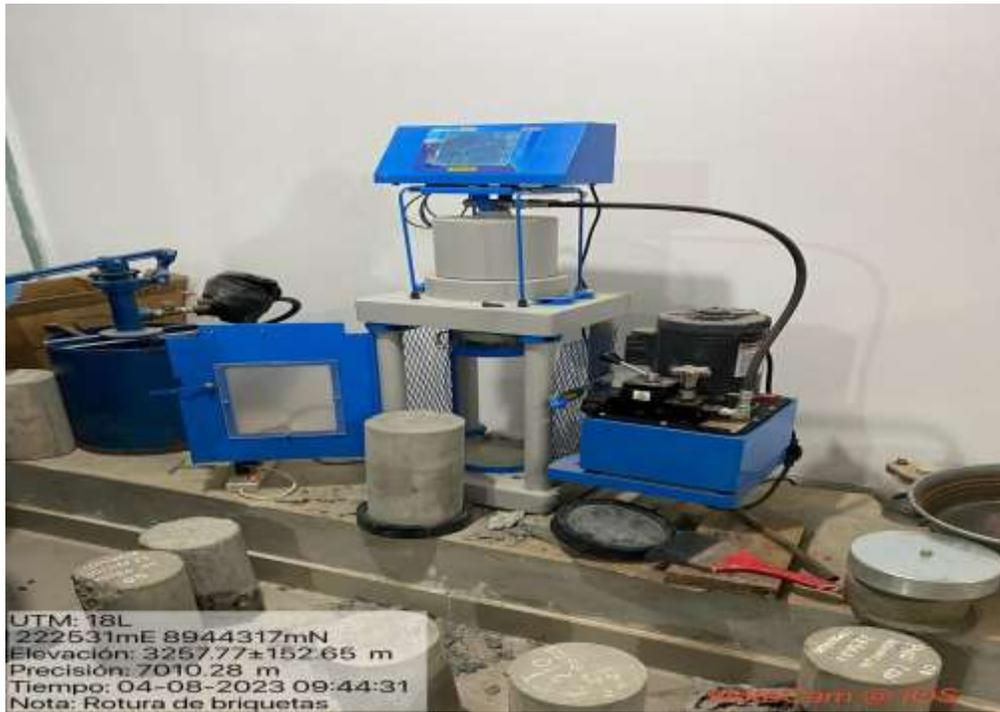
Fotografía 6: Proceso de rotura de la briquetas en el laboratorio
