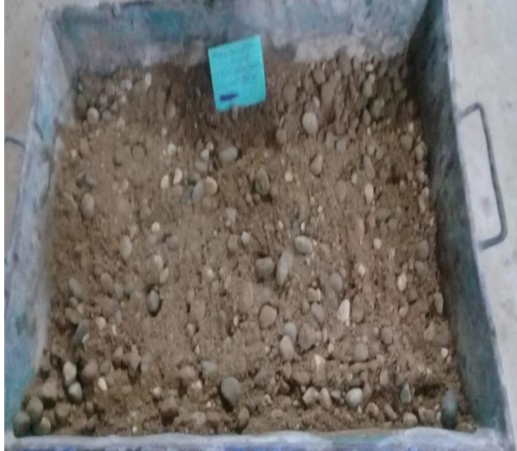
Foto 31. Adición de 0.5kg/m 3 de aditivo hidrófugo + 1% cemento.
