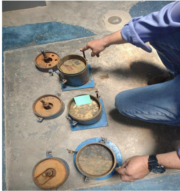
Foto 33. CBR adicionando 0.5kg/m 3 de aditivo hidrófugo + 1% cemento.
