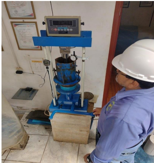
Foto 34. Ensayo CBR adicionando 0.5kg/m 3 de aditivo hidrófugo + 1% cemento.
