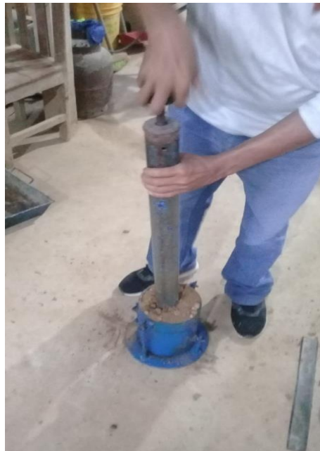
Foto 32. CBR adicionando 0.5kg/m 3 de aditivo hidrófugo + 1% cemento.
