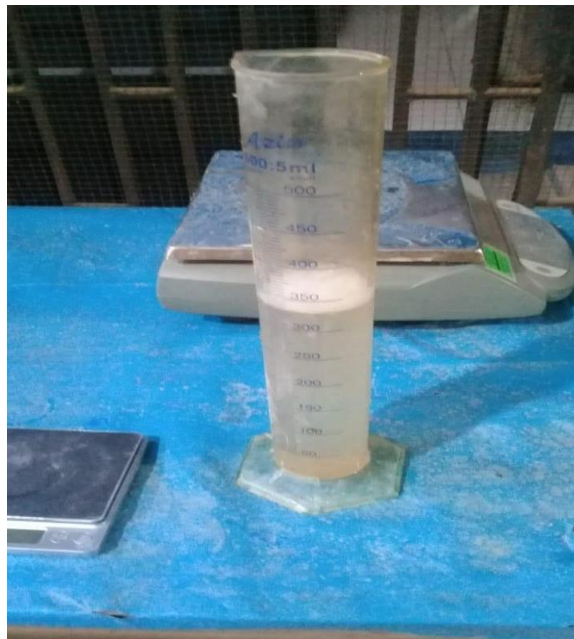
Foto 30. Foto 24. Aditivo químico hidrófugo 0.5kg/m 3 .
