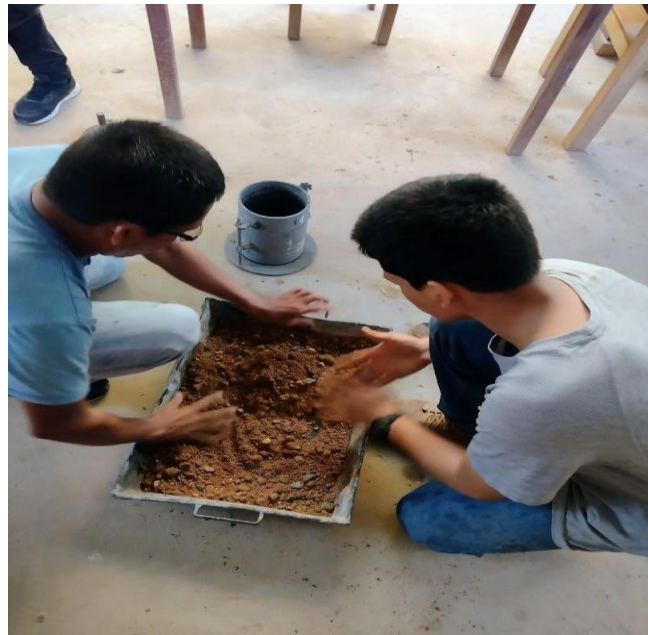
Foto 26. Adición de 0.5kg/m 3 de aditivo hidrófugo.
