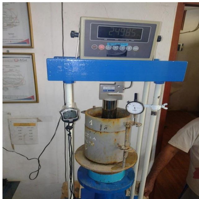
Foto 28. Ensayo CBR adicionando 0.5kg/m 3 de aditivo hidrófugo.
