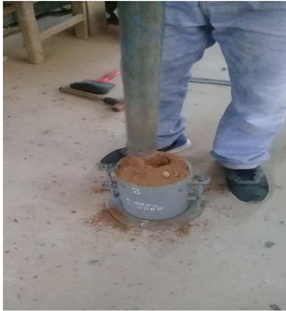
Foto 27. CBR adicionando 0.5kg/m 3 de aditivo hidrófugo.
