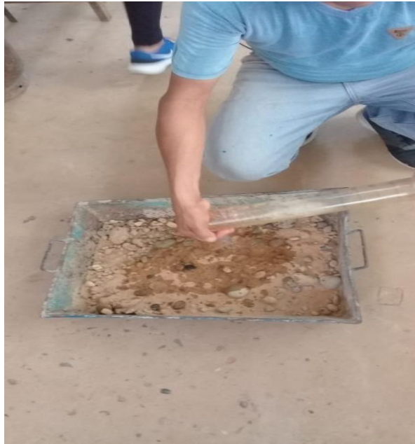
Foto 25. Adición de 0.5kg/m 3 de aditivo hidrófugo.
