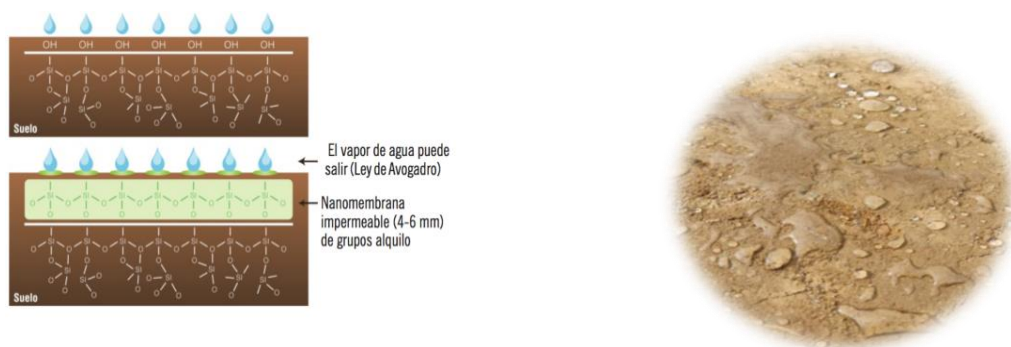
Figura 1. Impermeabilización de la subbase, suelos y taludes.
