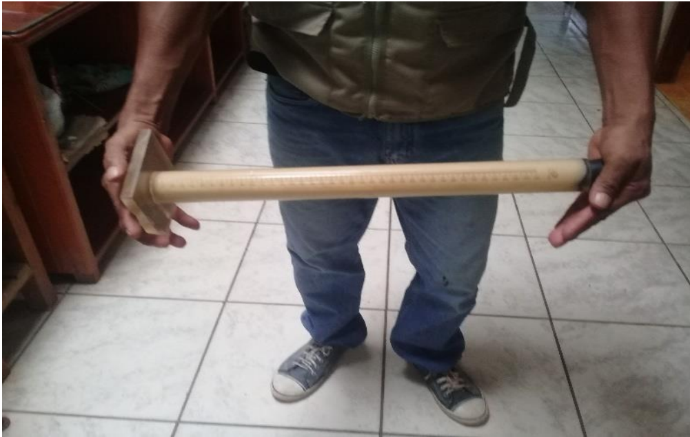
Foto 21. Ensayo equivalente de arena.
