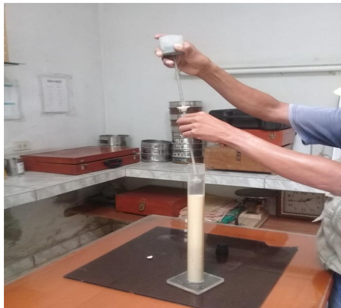
Foto 22. Ensayo equivalente de arena.
