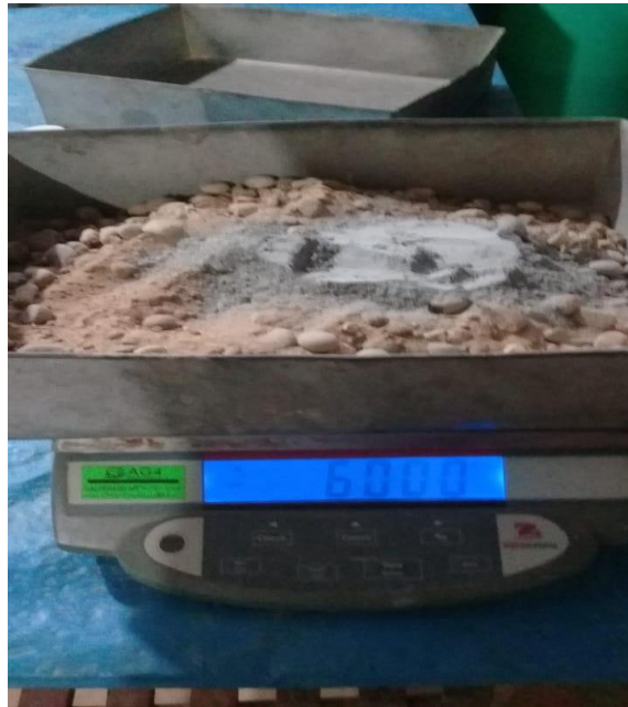
Foto 29. Adición de 0.5kg/m 3 de aditivo hidrófugo+1% cemento.
