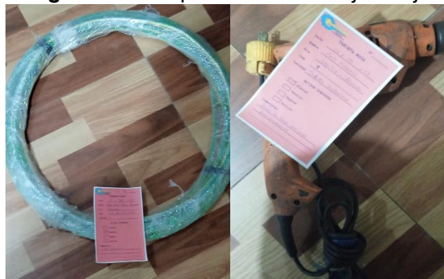
Figura N° 12. Aplicación de la tarjeta roja
