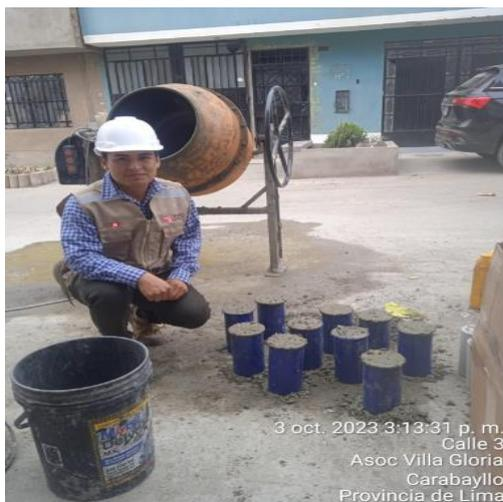
**Figura 23:** Vaciado de probetas.
