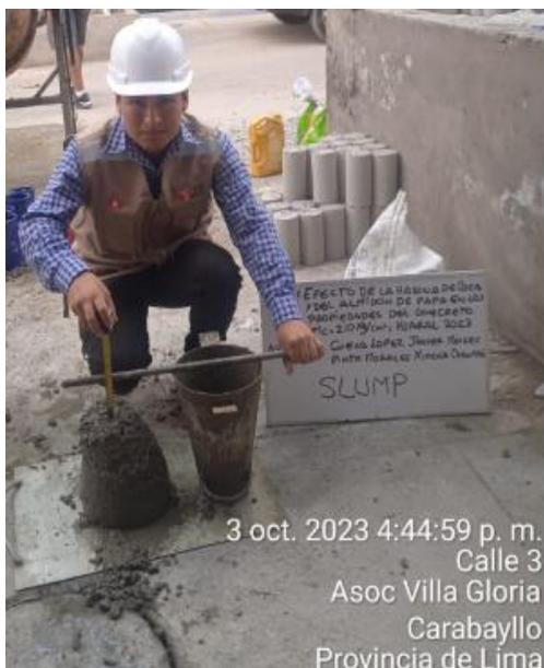
**Figura 27:** Ensayo a la consistencia
