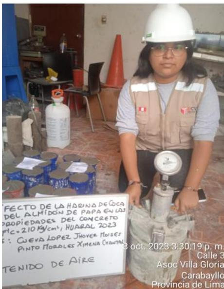
Ensayo de contenido de aire
