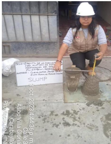
**Figura 28:** Ensayo a la consistencia
