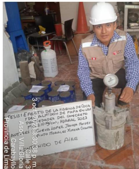
**Figura 25:** Ensayo de contenido de aire.
