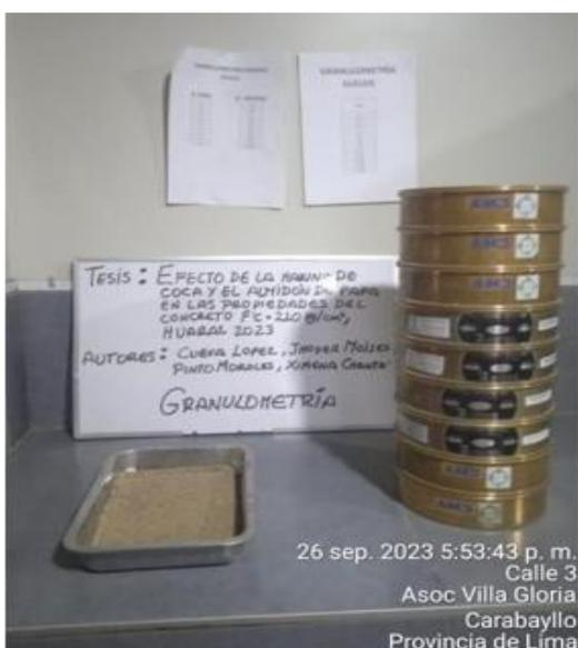
**Figura 12:** Granulometría del agregado fino
