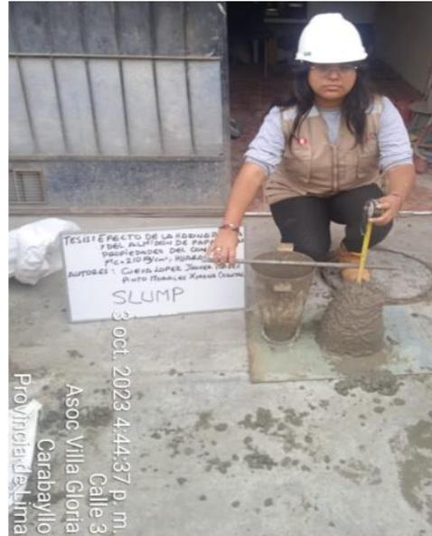
Ensayo de slump
