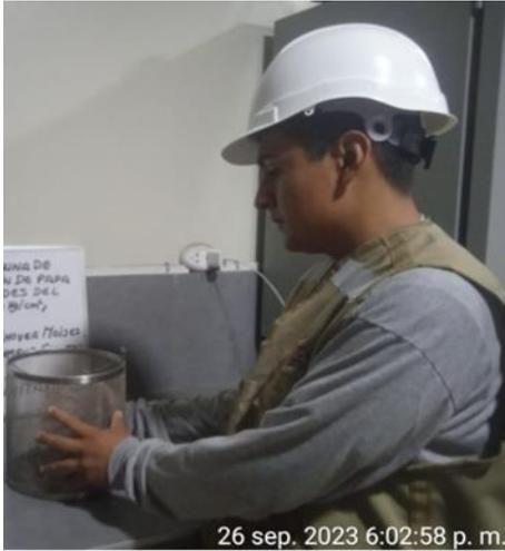
**Figura 20:** Peso Específico y Absorción del agregado Grueso
