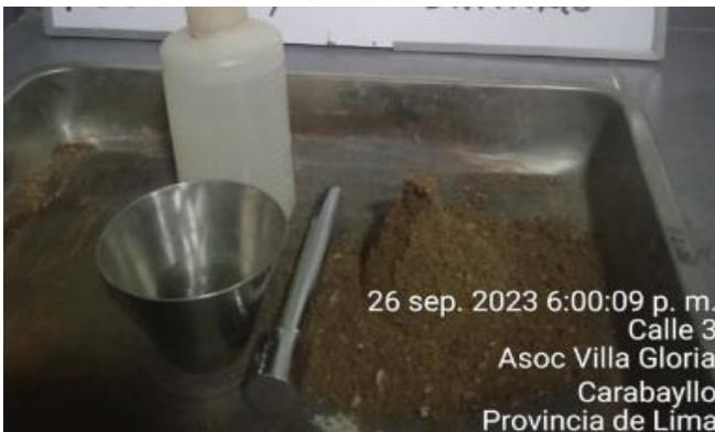
**Figura 21:** Peso Específico y Absorción del agregado fino
