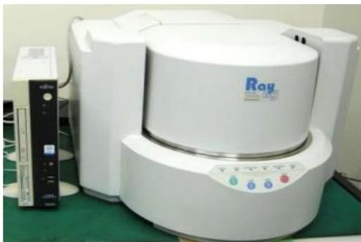
**Figura 11:** Equipo de fluorescencia de rayos X.
