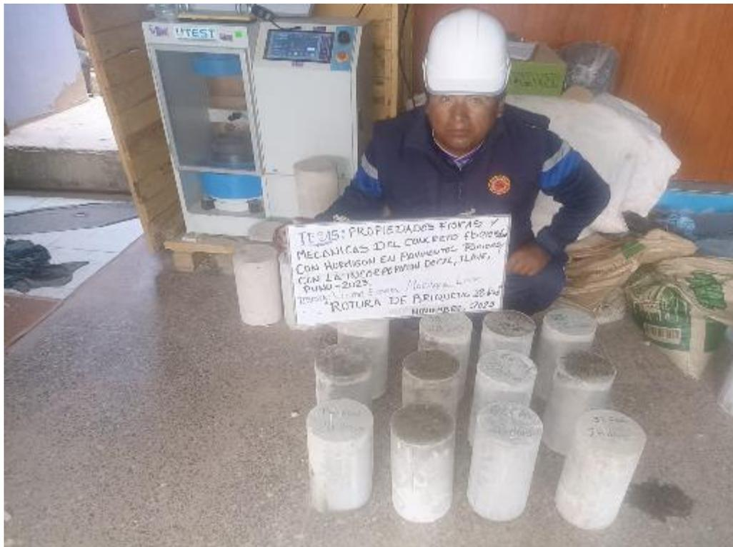
Figura 36. Rotura a los veinte ocho días con la incorporación de la cal.
