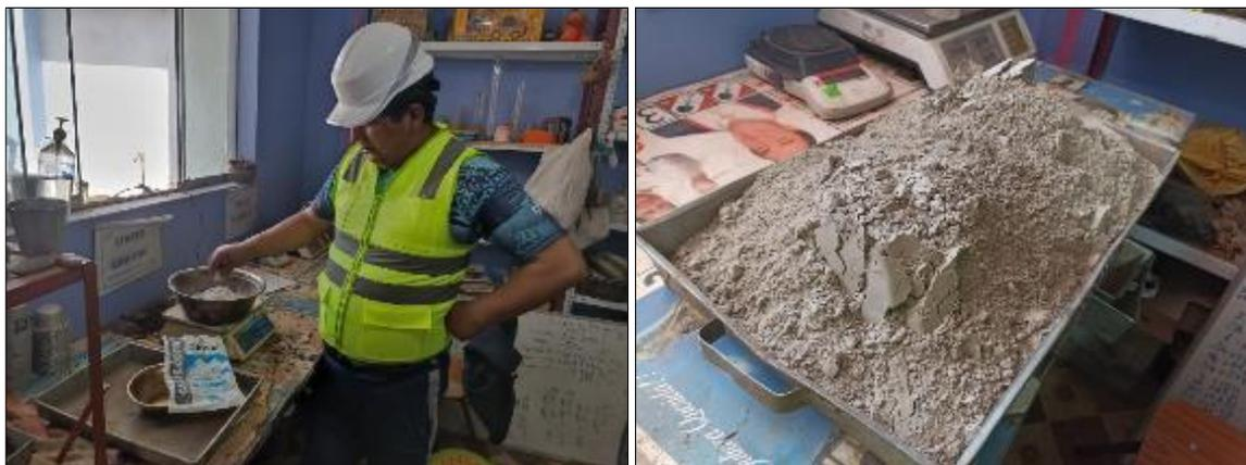
*Figura 23. Pesado de cal, cemento.*
