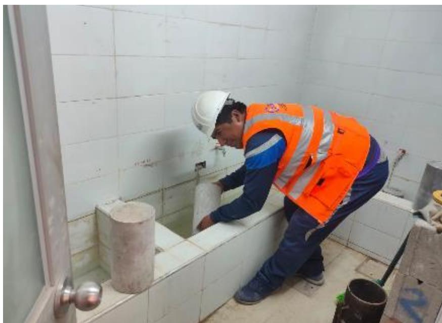
Figura 48. Sumergido de muestra al agua para el ensayo de absorción.
