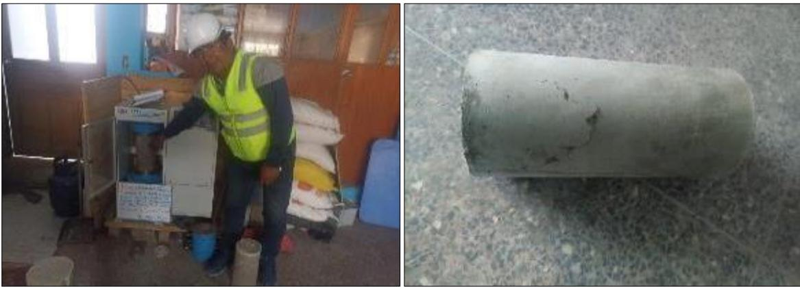
Figura 33. Ensayo rotura de especímenes.
