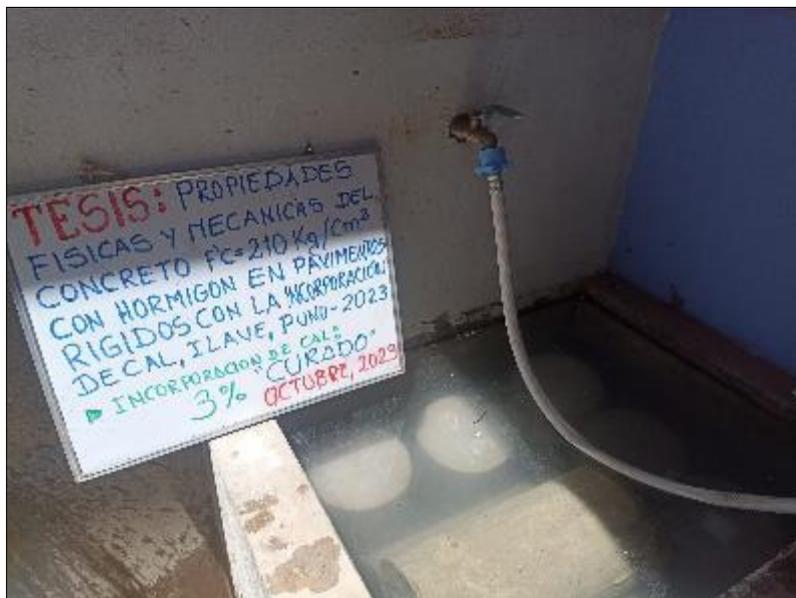
*Figura 30.* Curado de briquetas.
