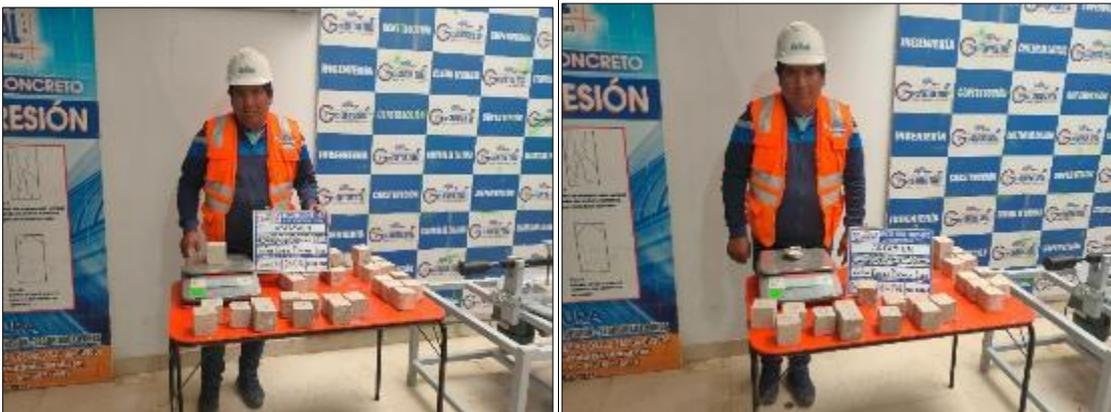
Figura 52. Pesado del testigo para el ensayo.
