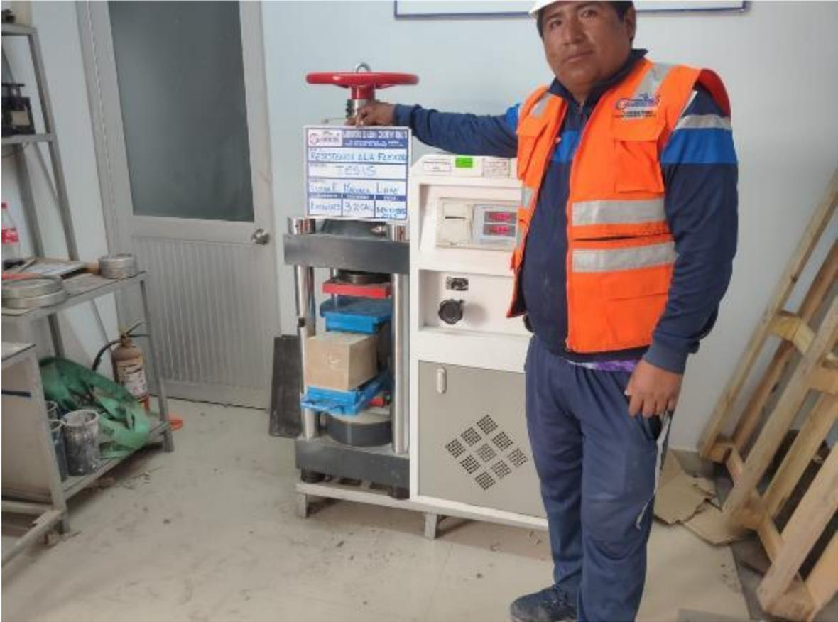
Figura 43. Maquina donde se realizó la rotura de vigas.
