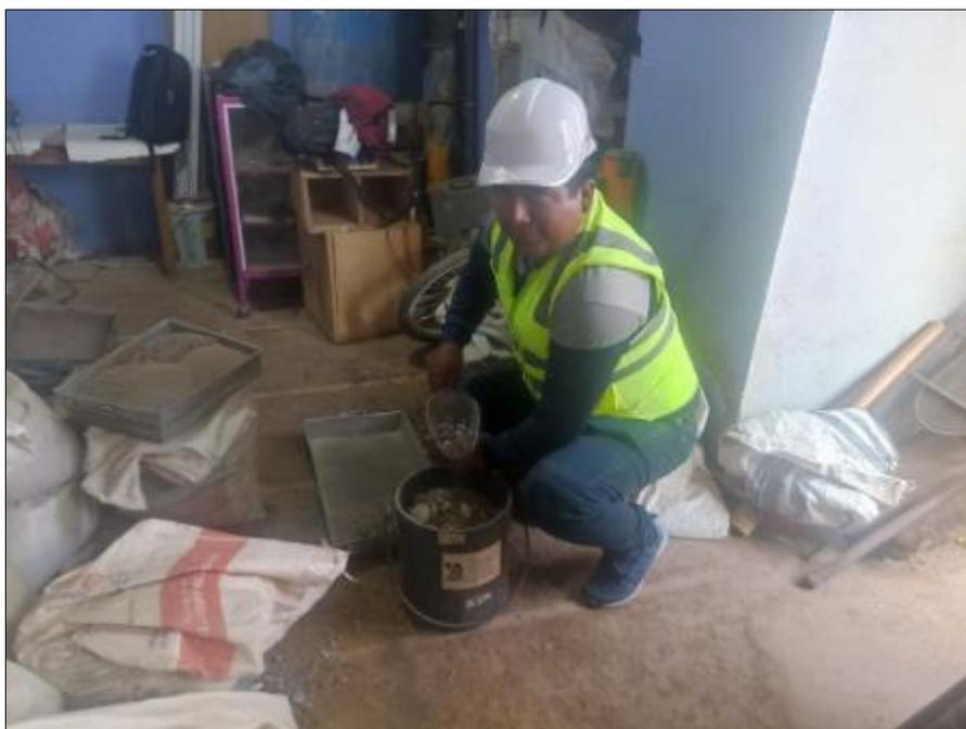
Figura 20. peso del hormigón suelto.
