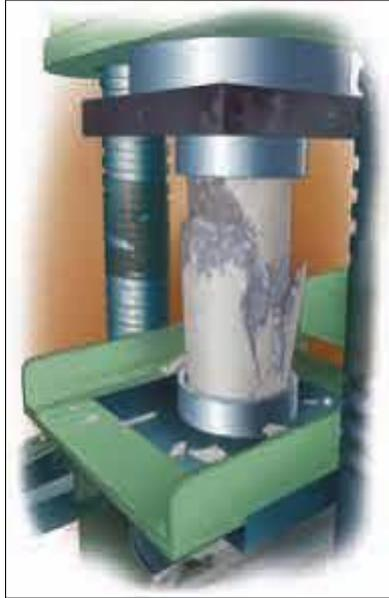
Figura 2. ensayo de resistencia a la compresión
