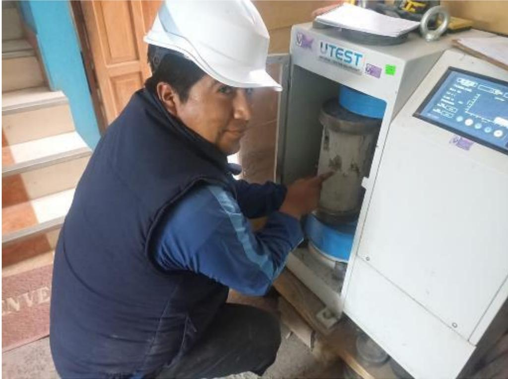
Figura 37. Rotura de briquetas a los con la incorporación.
