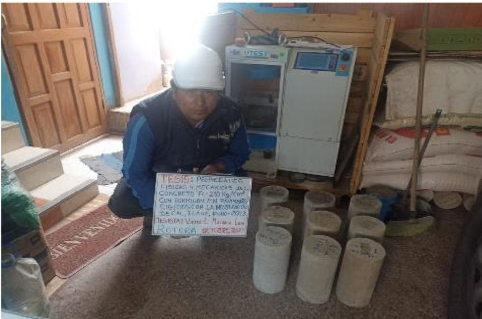
Figura 34. Rotura a los siete días con la incorporación de la cal.
