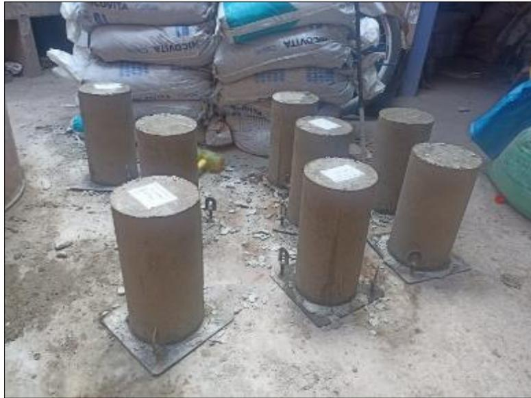
*Figura 29.* proceso del desmolde de las probetas cilíndricas
