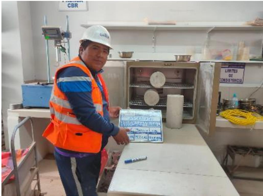
Figura 49. Colocado de muestras al horno por 24 horas.
