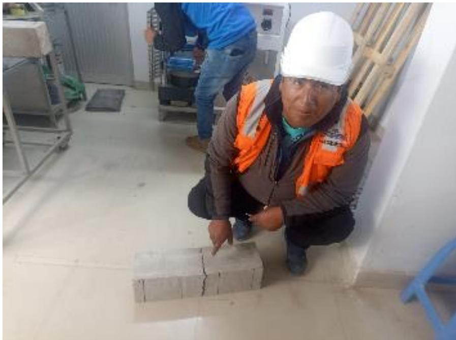
Figura 44. Verificación de la rotura en la viga.
