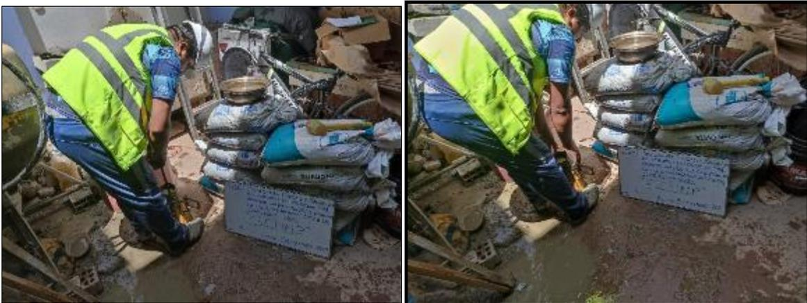
Figura 25. realizando el cálculo del SLUMP.
