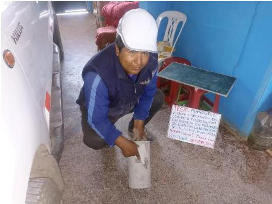
Figura 38. rotura de briqueta tipo cono.
