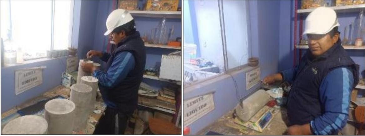
Figura 32. pesado y medición de briquetas para la rotura.
