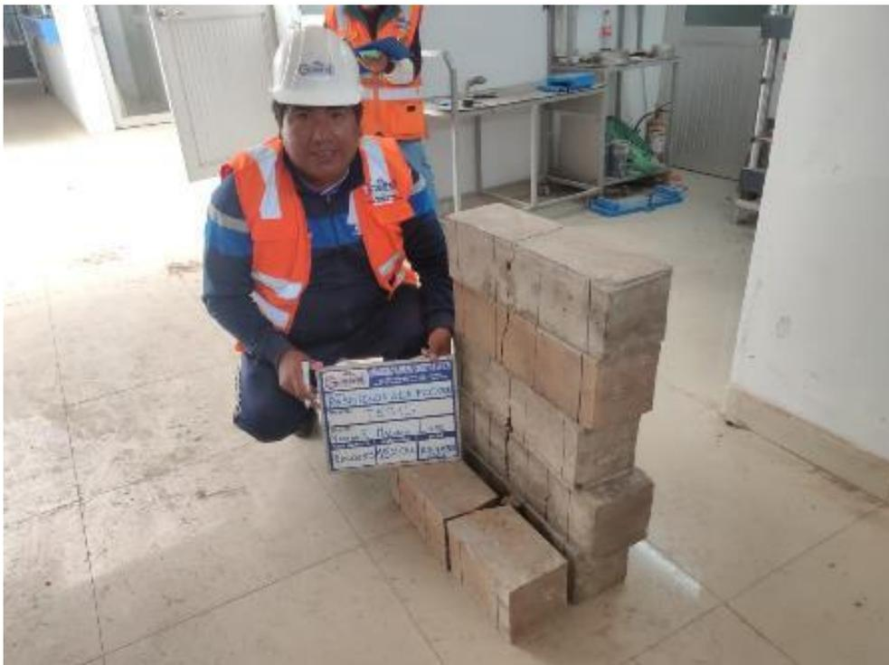
Figura 46. Las vigas sometidas a las roturas.
