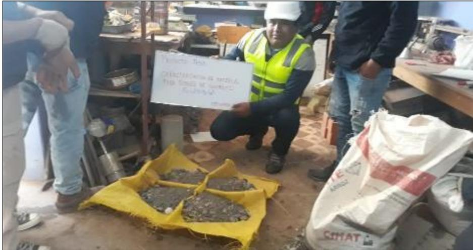
*Figura 12:* cuarteo de materiales para la granulometría.
