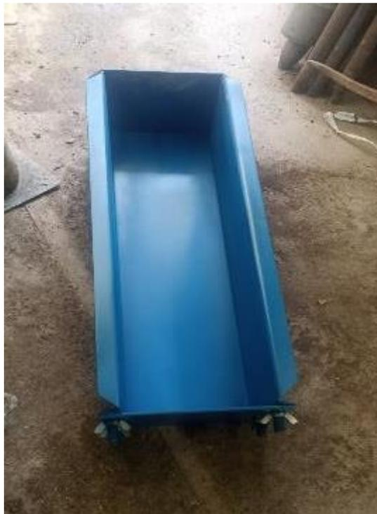
*Figura 11:* molde para elaborar vigas.
