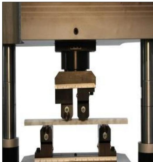
Figura 3. Ensayo a flexión ASTM C880
