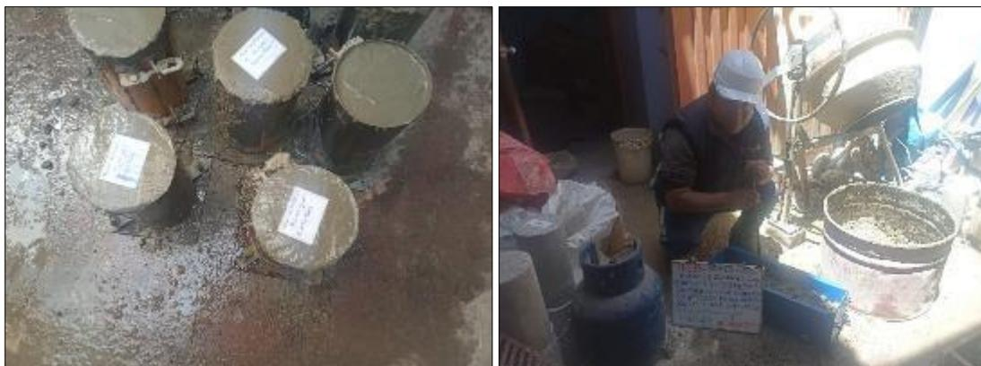
Figura 28. etiquetado a los testigos cilíndricos y vigas (prismáticas).
