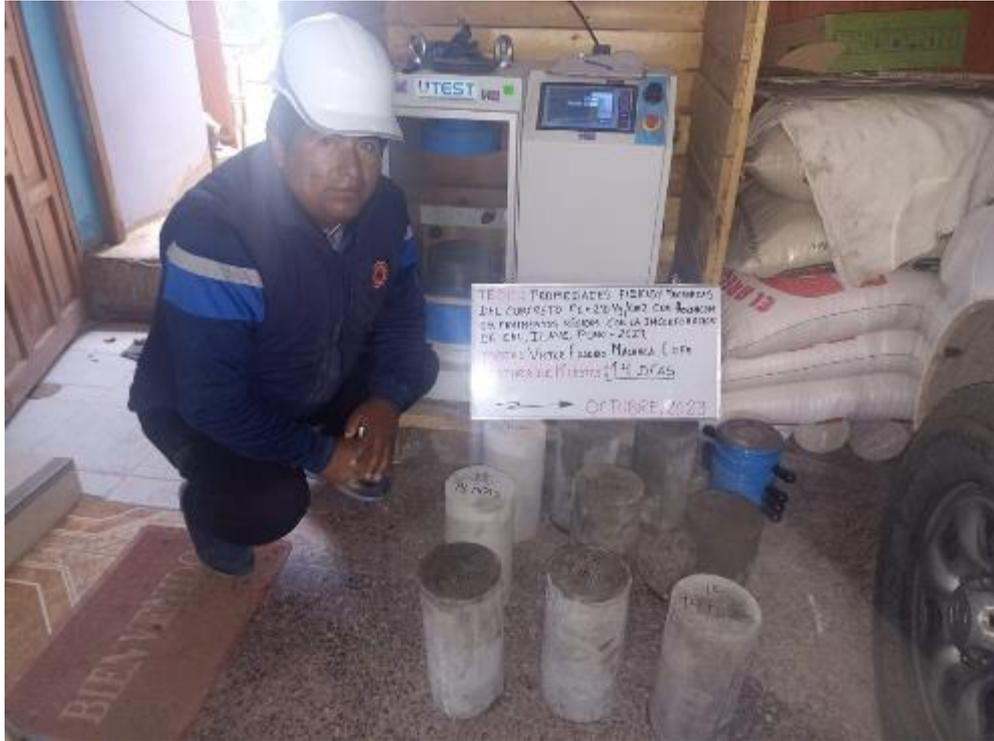
Figura 35. Rotura a los catorce días con la incorporación de la cal.
