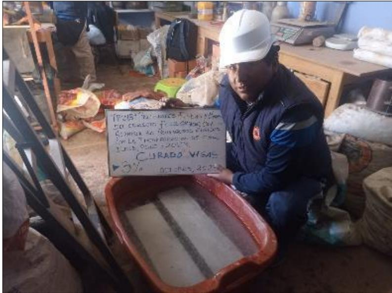
Figura 31. Curado de vigas (prismáticas).
