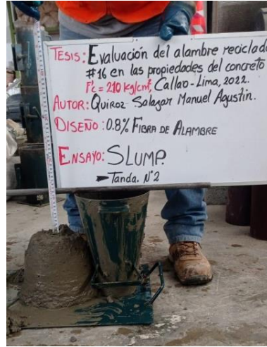
Figura 21. Ensayo de Consistencia 0.8%
