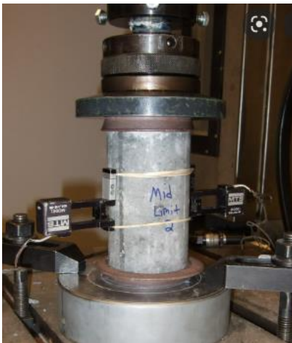
Figura 5. Ensayo de una probeta sometida a compresión.
