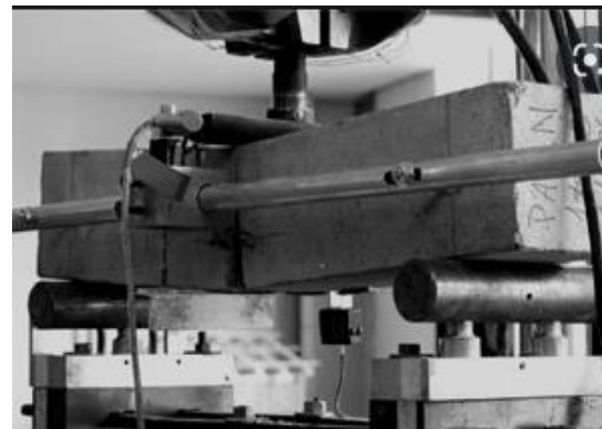
Figura 6. Ensayo de una probeta sometida a flexión
