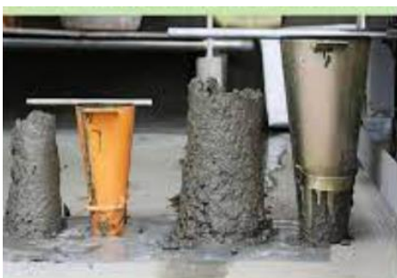
Figura 4. Ensayo de asentamiento de cono de Abrams
