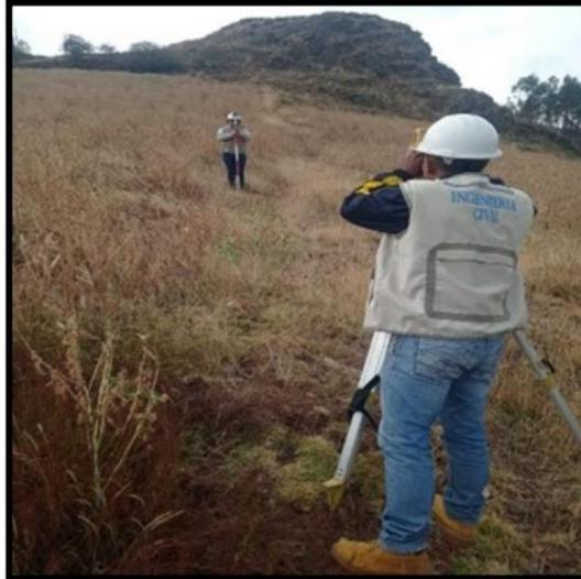
Fotografía 3: trazado de puntos topográfico para los diseños.
