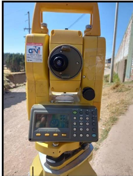
Fotografía 2: equipo utilizado para el levantamiento topográfico estación total topcon gts-240.
