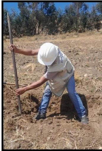
Fotografía 13: Empezando la excavación de calicata
