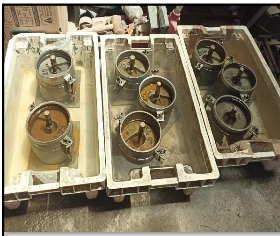
Figura 48. Tanque de saturación
