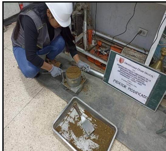
Figura 39. Retiro de material excedente
