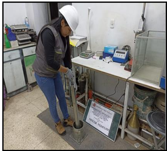
Figura 38. 25 golpes por capa con martillo
