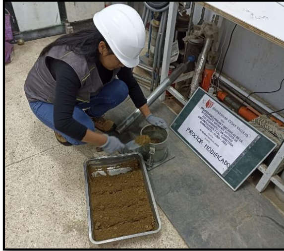
Figura 37. Relleno de capa N° 01
