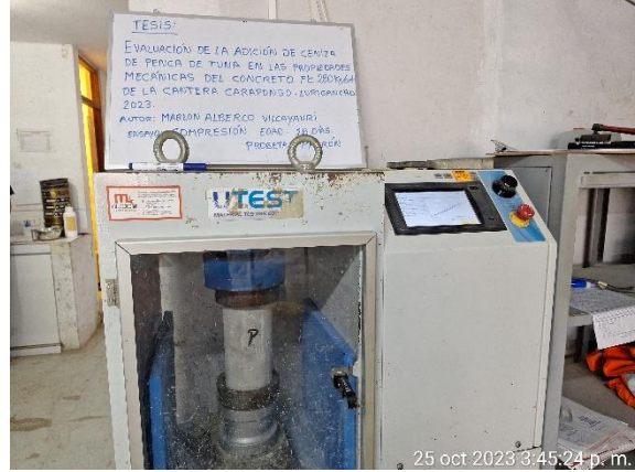
Rotura de probetas a compresión uniaxial, a edad de 28 días correspondiente a la muestra PATRON.
