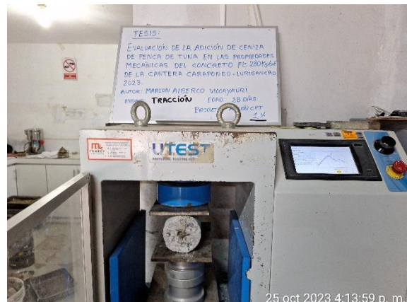
Rotura de probetas a tracción directa, a edad de 28 días correspondiente a la muestra con
