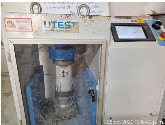
Rotura de probetas a compresión uniaxial, a edad de 28 días correspondiente a la muestra con adición del 1% de CPT.
