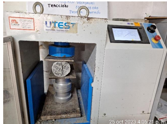
Rotura de probetas a tracción directa, a edad de 28 días correspondiente a la muestra PATRON.
