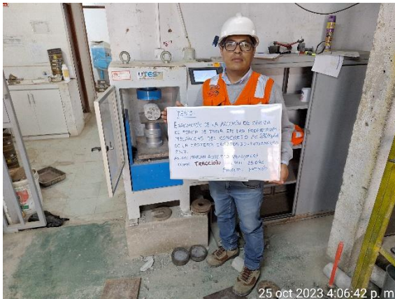
Rotura de probetas a tracción directa, a edad de 28 días correspondiente a la muestra PATRON.
