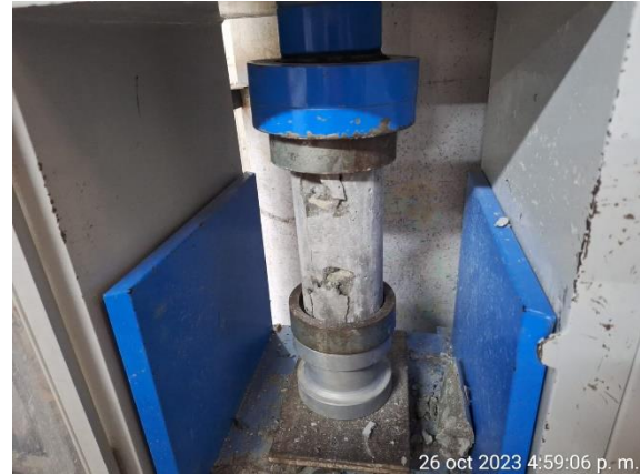
Rotura de probetas a compresión uniaxial, a edad de 28 días correspondiente a la muestra con adición del 2% de CPT.
