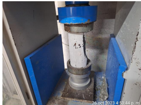
Rotura de probetas a compresión uniaxial, a edad de 28 días correspondiente a la muestra con adición del 1.5% de CPT.
