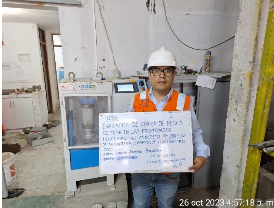
Rotura de probetas a compresión uniaxial, a edad de 28 días correspondiente a la muestra con adición del 2% de CPT.
