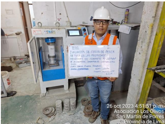
Rotura de probetas a compresión uniaxial, a edad de 28 días correspondiente a la muestra con adición del 1.5% de CPT.
