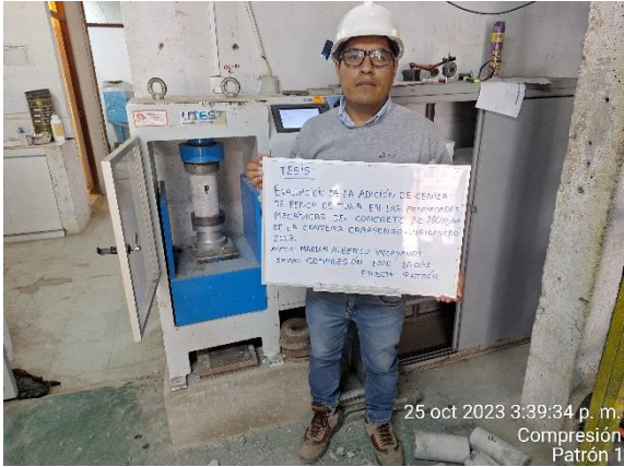
Rotura de probetas a compresión uniaxial, a edad de 28 días correspondiente a la muestra PATRON.
