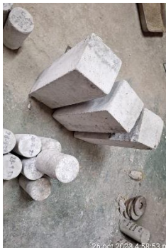
Prueba de slump de muestra patrón y con adición de CTP. También los tipos de probetas y curado permanente.
