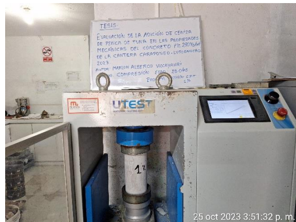
Rotura de probetas a compresión uniaxial, a edad de 28 días correspondiente a la muestra con adición del 1% de CPT.
