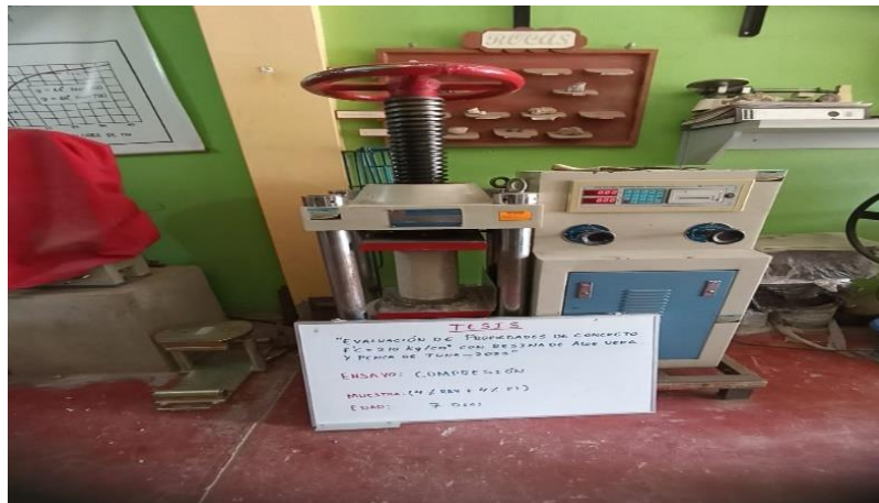
Figura 24 Rotura de las muestras para determinar resistencia de compresión
