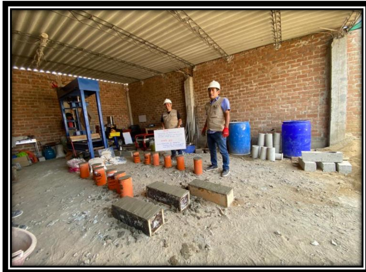
Elaboración de probetas y vigas con muestra patrón y adición de resina de aloe vera y penca de tuna.
