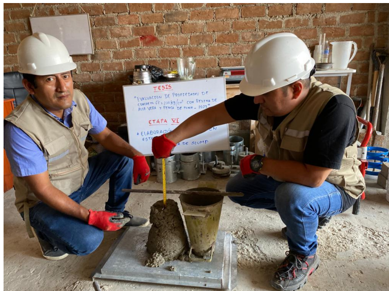
Figura 22 Ensayo de asentamiento del concreto
