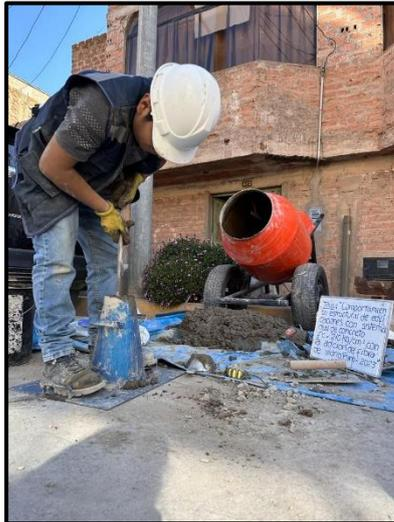
Figura 26. Prueba Slump antes de verter en los moldes prismáticos
