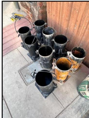
*Figura 19. Moldes de las probetas cilíndricas.*
