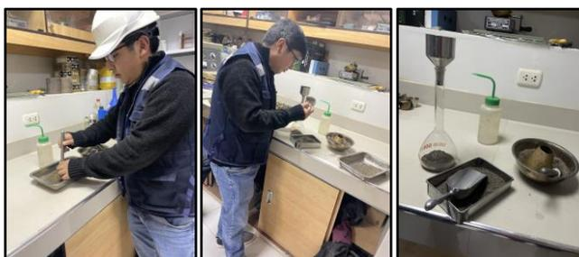
*Figura 14. Gravedad específico y absorción del agregado fino.*
