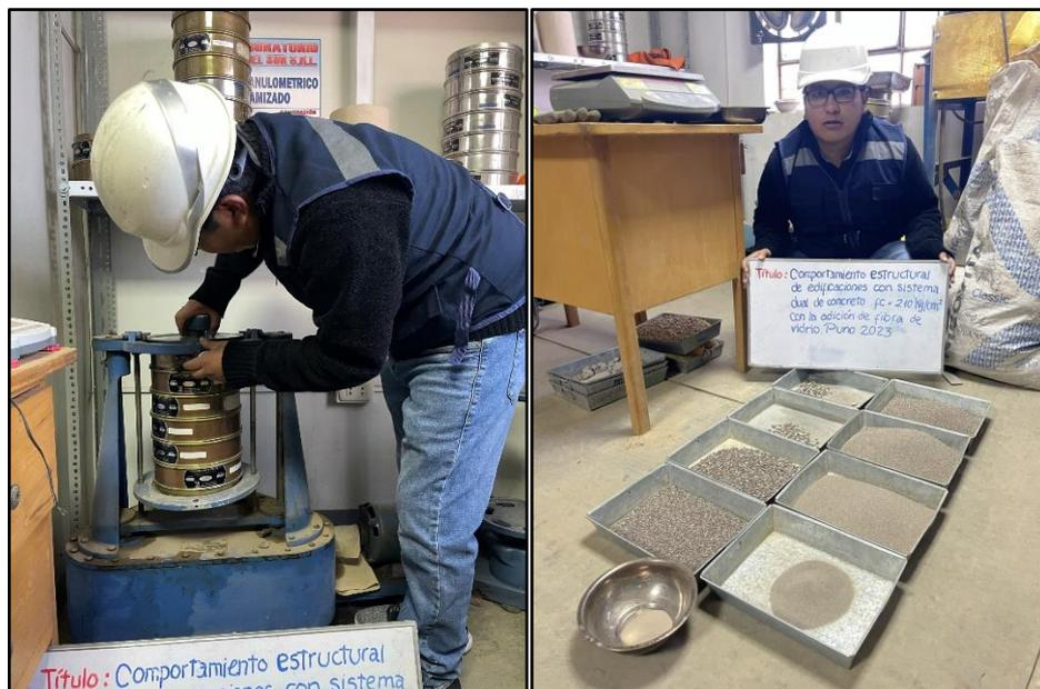
Figura 11. Granulometría del agregado fino
