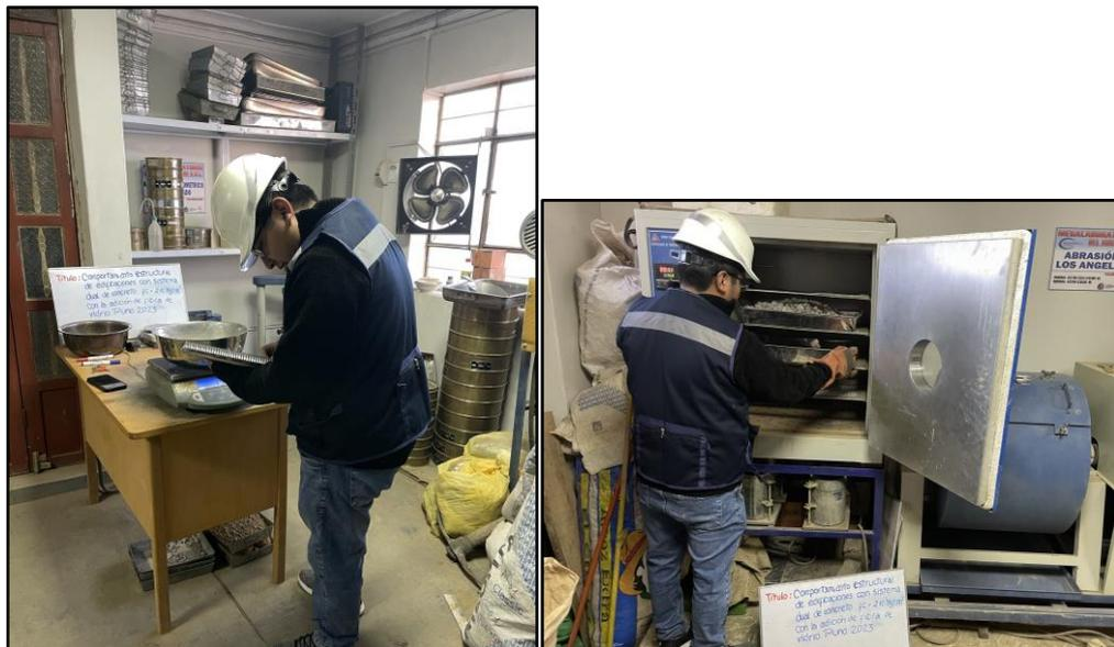
Figura 12. Contenido de humedad de la piedra chancada y agregado fino
