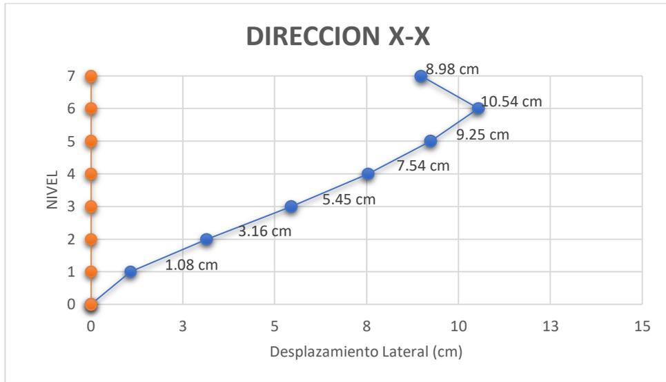
Tabla 100. Desplazamiento de la edificación en eje "X" (+2.5% FV)
