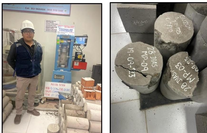
Figura 31. Ensayo a compresión de especímenes a 28 días.
