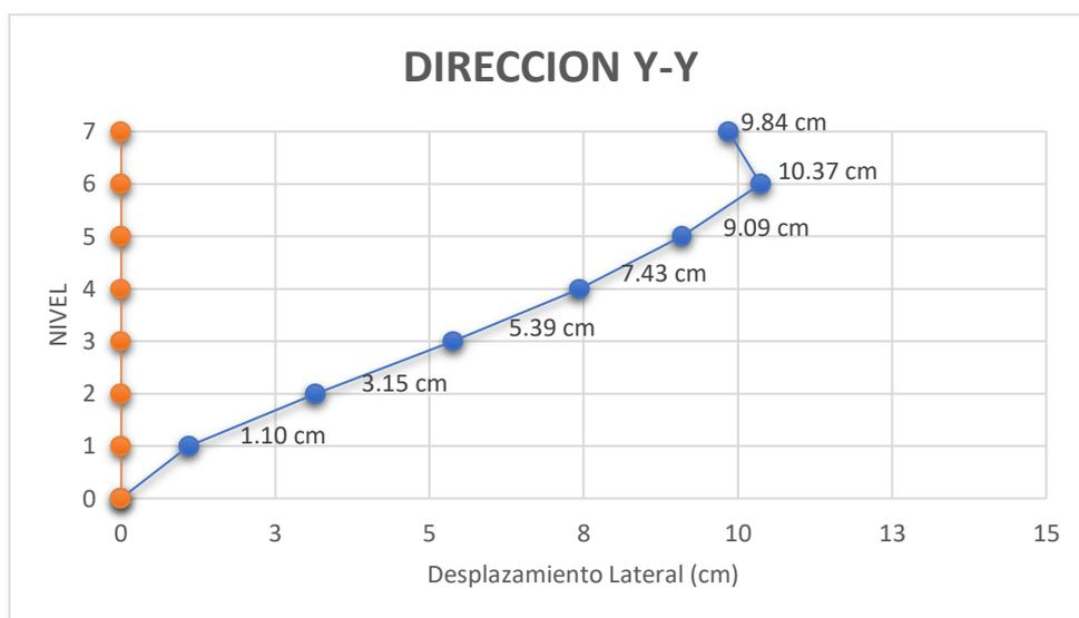
*Tabla 102. Desplazamiento de la edificación en eje "Y" (+1.5% FV)*
