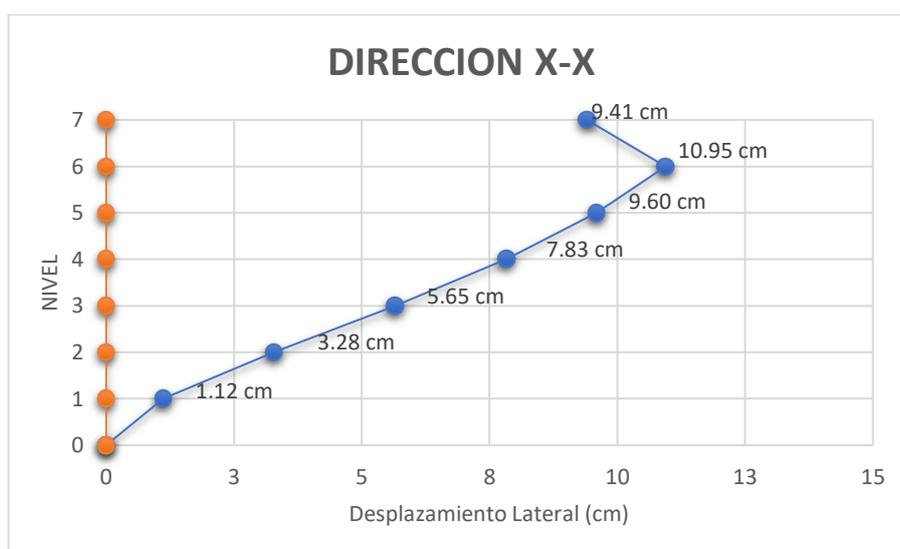
Tabla 99. Desplazamiento de la edificación en eje "X" (+1.5% FV)
