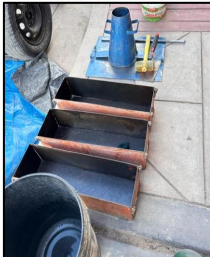
*Figura 25. Molde de viga prismática.*
