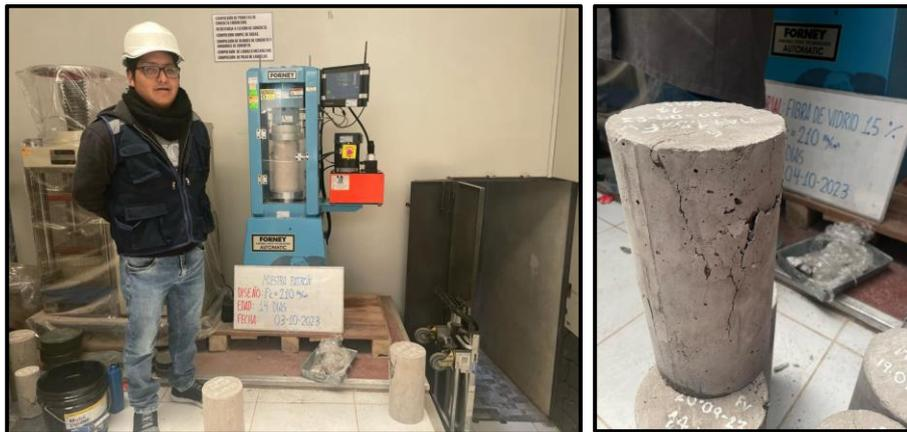
Figura 30. Ensayo a compresión de especímenes 14 días.
