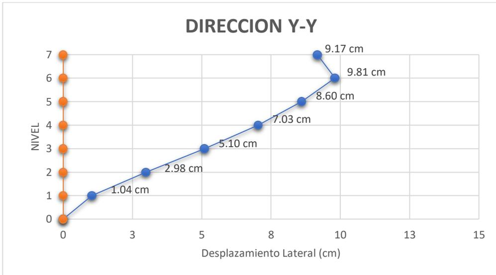
Tabla 103. Desplazamiento de la edificación en eje “Y” (+2.5% FV)
