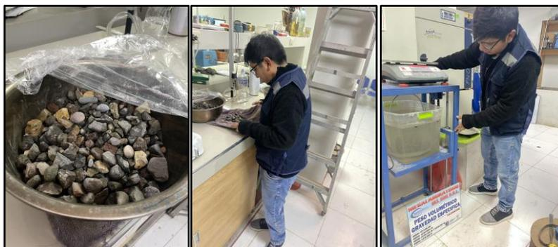
Figura 13. Gravedad específico y absorción de la piedra chancada.
