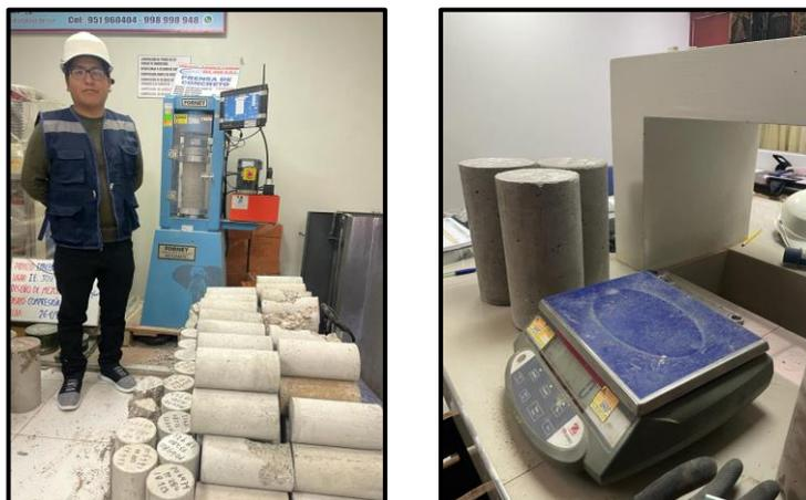
Figura 29. Ensayo a compresión de especímenes 7 días.
