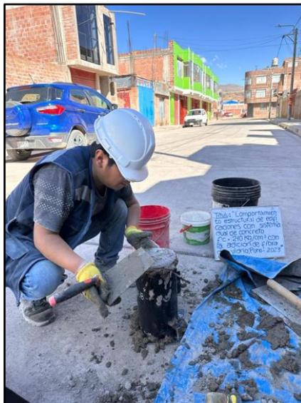
Figura 21. Realizando los especímenes cilíndricos en sus moldes
