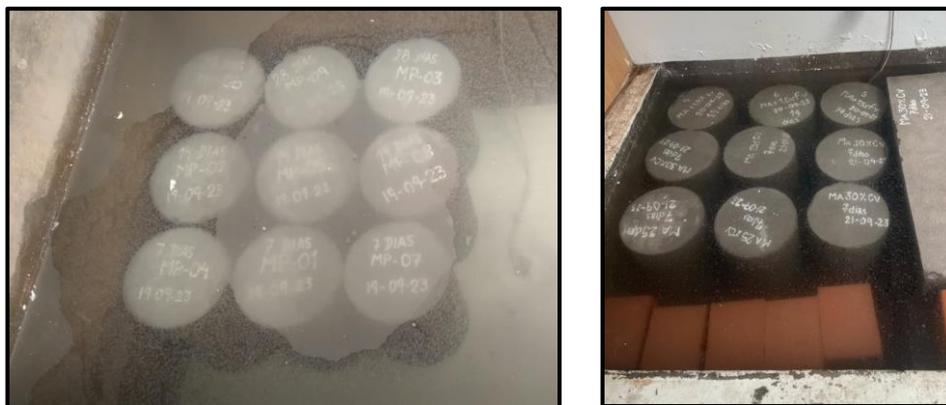
Figura 22. Curado en pozas de especímenes cilíndricos
