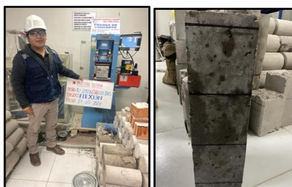
Figura 34. Ensayo a flexión de especímenes prismáticos a 28 días.
