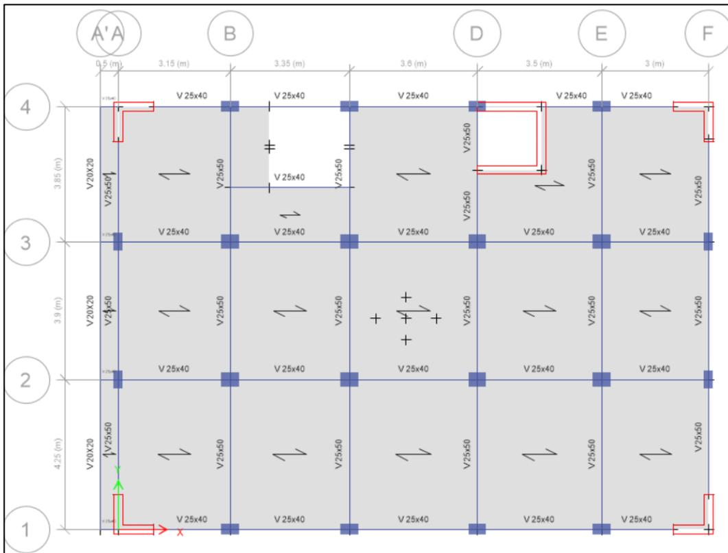
Figura 40. Introducción de los elementos estructurales vigas al ETABS
